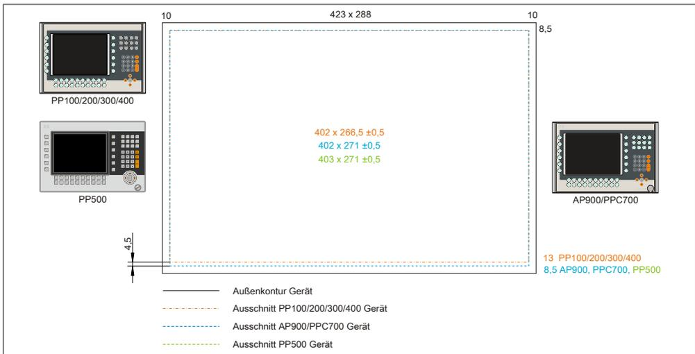
Abbildung 87: Einbaukompatibilität 10,4" Geräte Format Quer2
