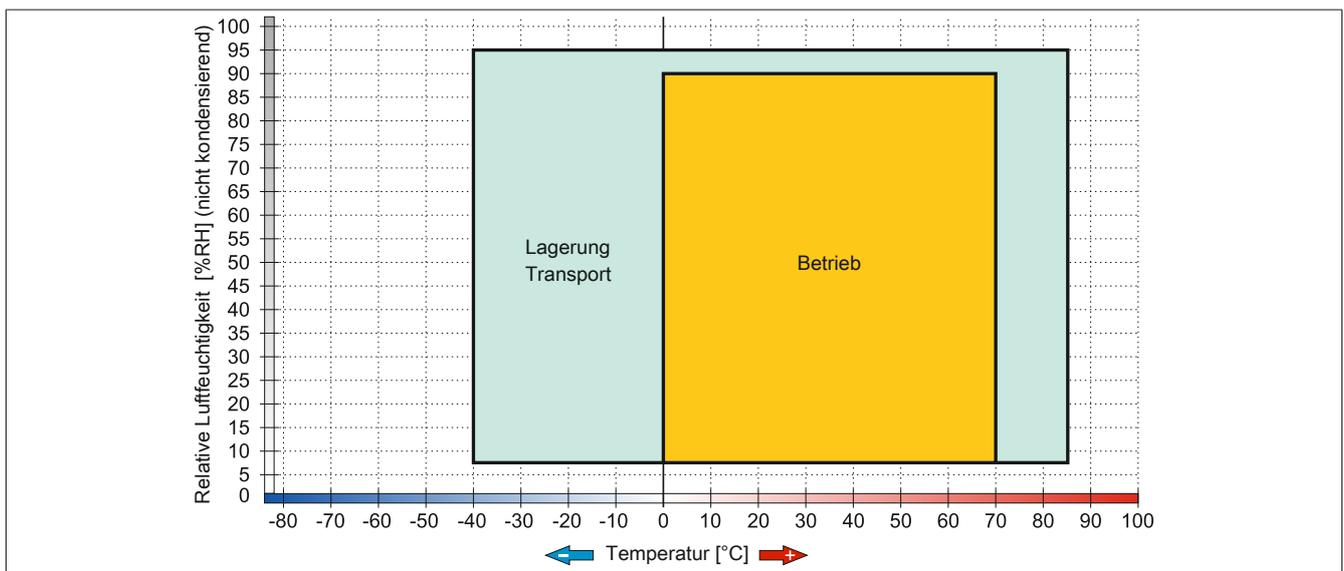
Abbildung 48: 5AC801.SSDI-03 ≤ Rev. C0 - Temperatur Luftfeuchtediagramm
