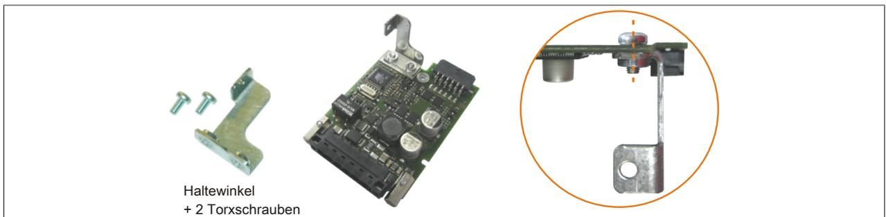
Abbildung 245: Haltewinkel montieren
