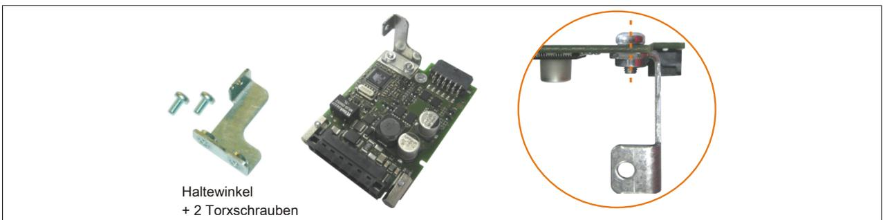
Abbildung 251: Haltewinkel montieren
