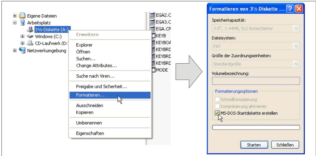
Abbildung 149: Bootdiskette erstellen unter Windows XP Schritt 1
