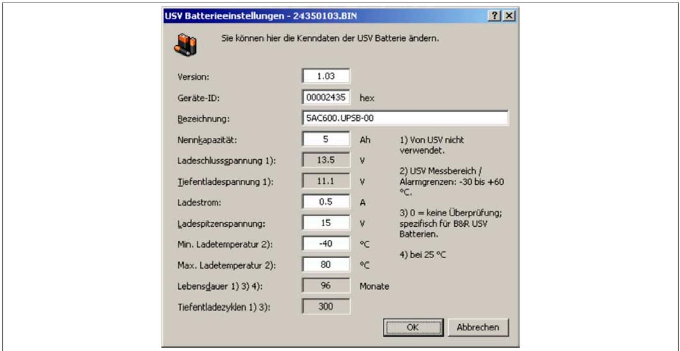
Abbildung 160: ADI Control Center - USV Batterieeinstellungen
