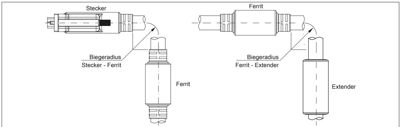
Abbildung 215: Biegeradiusspezifikation mit Extender
