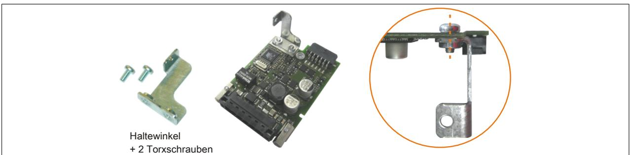
Abbildung 268: Haltewinkel montieren
