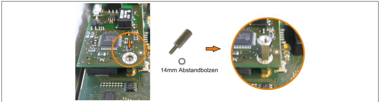
Abbildung 256: Distanzbolzen montieren
