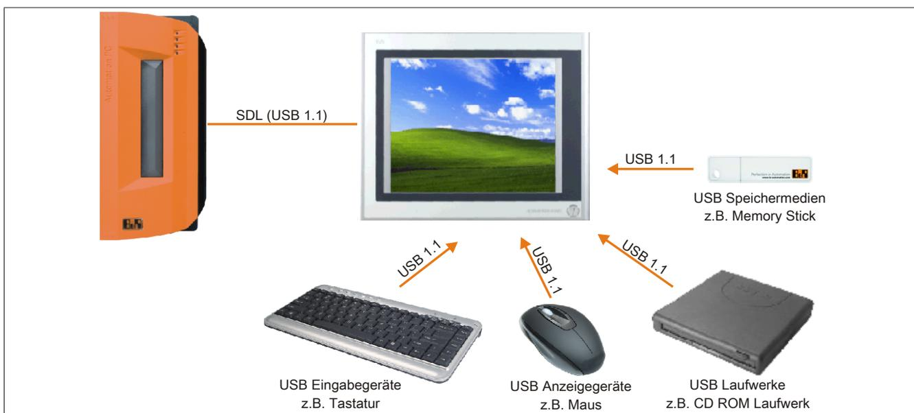
Abbildung 104: Anschluss von USB Peripheriegeräten remote am AP800/900 über SDL
