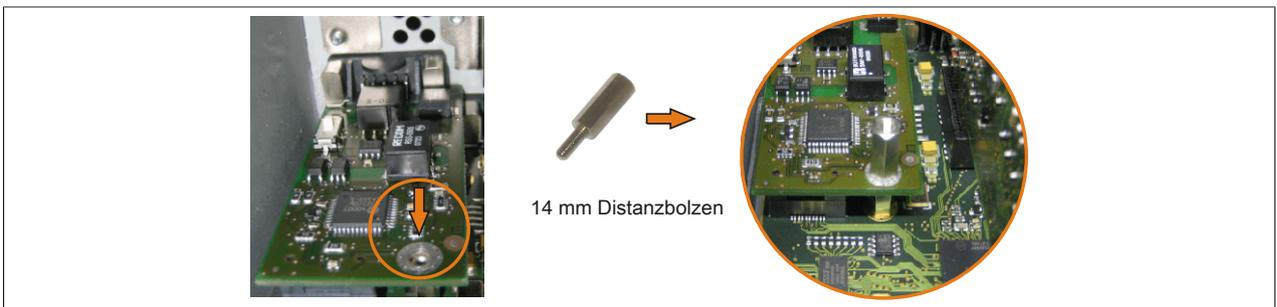
Abbildung 267: Distanzbolzen montieren
