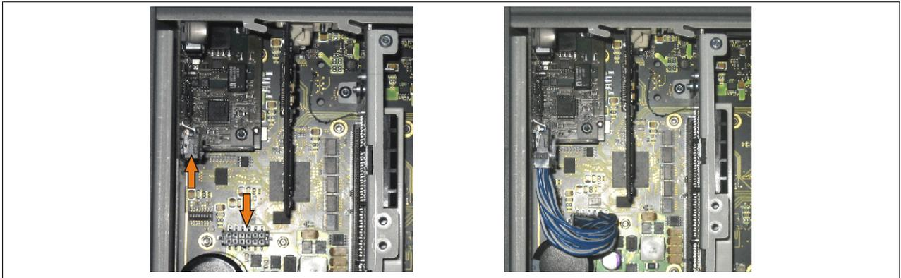
Abbildung 264: Verbindungskabel anstecken
