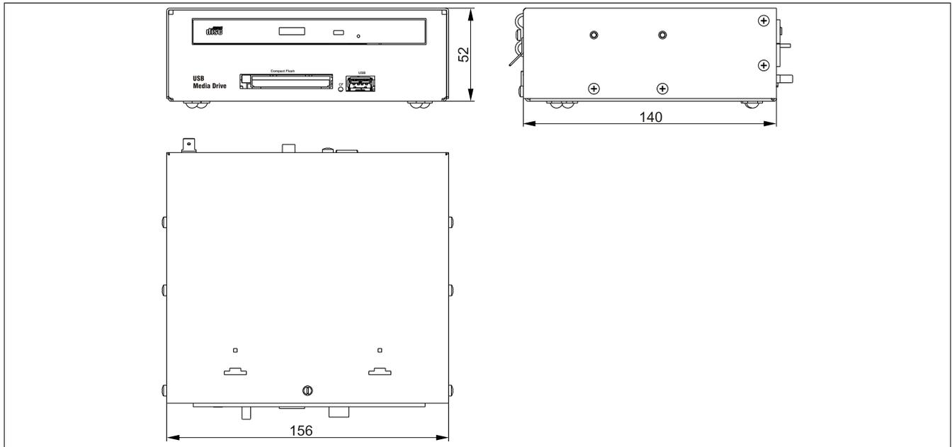
Abbildung 182: 5MD900.USB2-02 - Abmessungen
