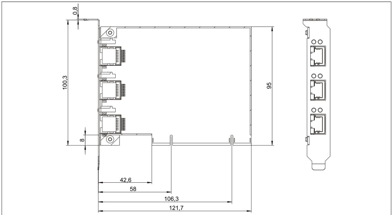
Abbildung 202: 5ACPCI.ETH3-01 - Abmessungen
