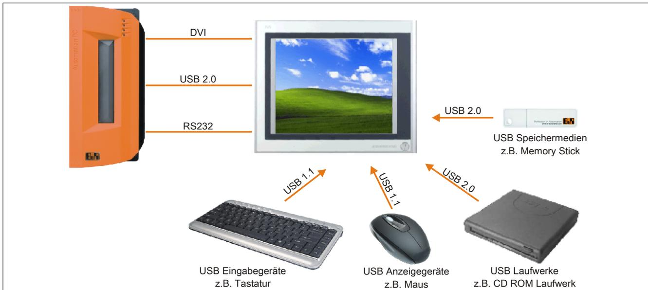
Abbildung 103: Anschluss von USB Peripheriegeräten remote am AP900 über DVI
