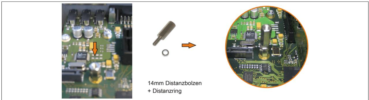
Abbildung 239: Distanzbolzen und Distanzring montieren
