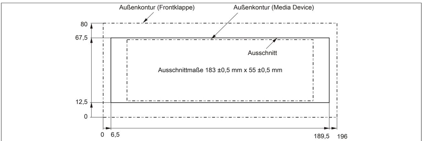
Abbildung 179: Einbauausschnitt USB Media Drive mit Frontklappe
