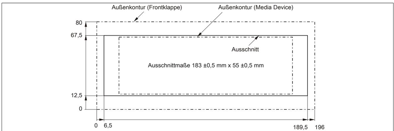
Abbildung 188: Einbauausschnitt USB Media Drive mit Frontklappe
