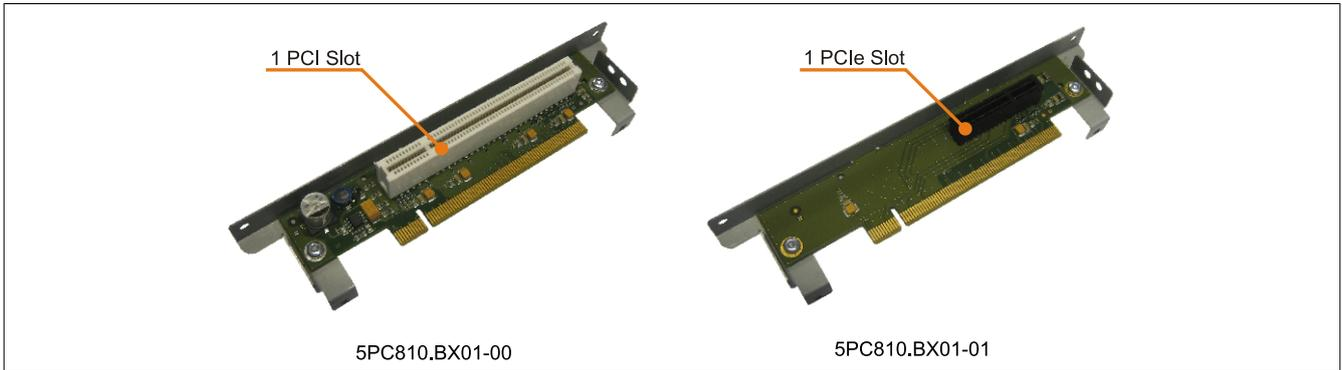
Abbildung 35: 1 Slot Buseinheiten
