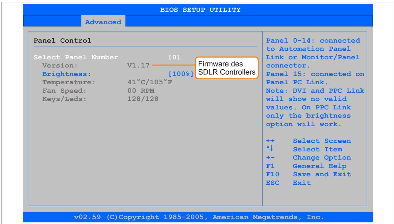
Abbildung 148: Firmwareversion des AP Link SDL Transmitter
