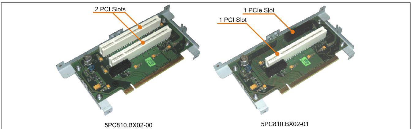
Abbildung 36: 2 Slot Buseinheiten
