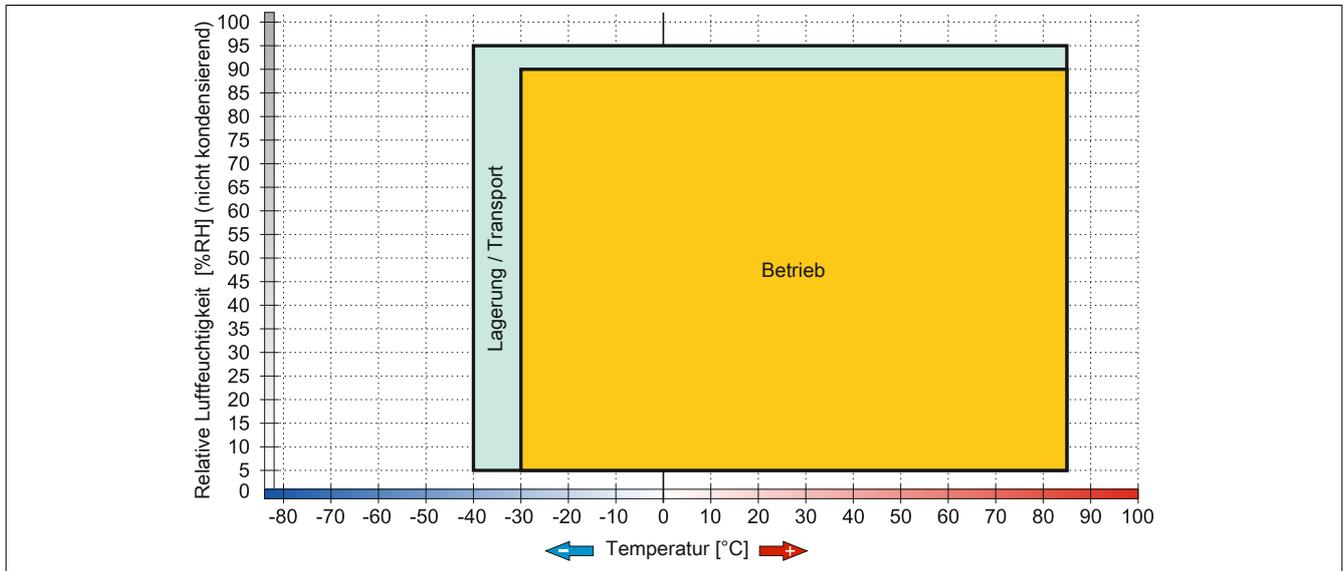
Abbildung 69: 5MMSSD.0128-01 ≥ Rev. D0 - Temperatur Luftfeuchtediagramm
