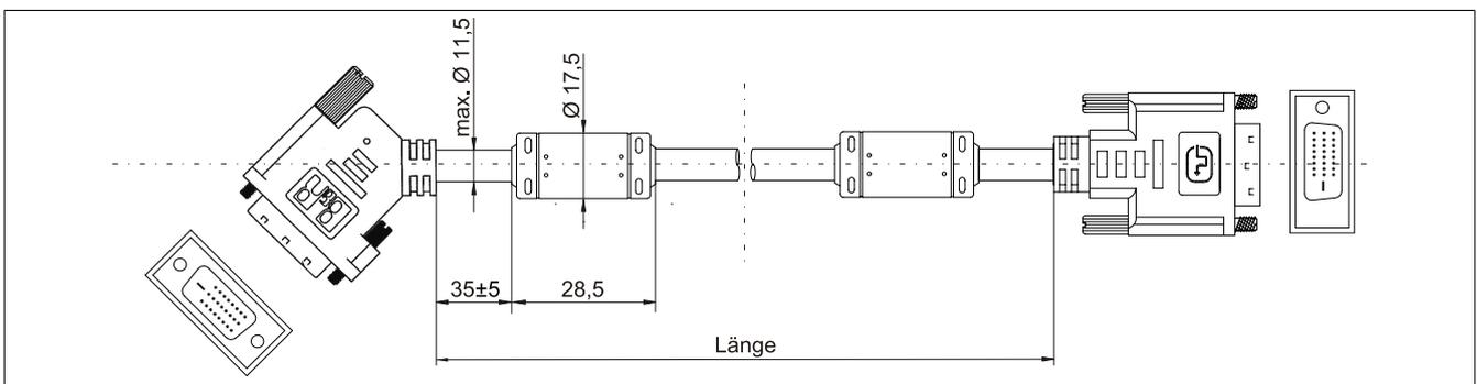
Abbildung 210: 5CASDL.0xxx-01 - Abmessungen
