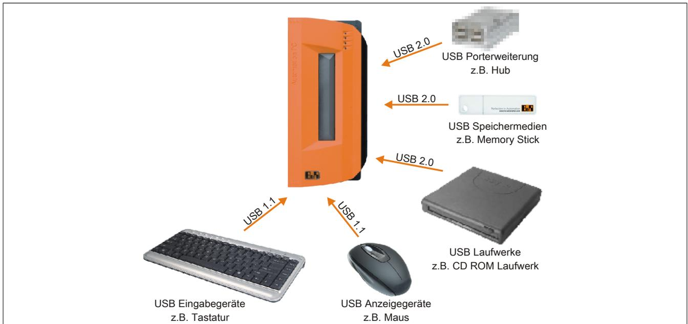
Abbildung 102: Anschluss von USB Peripheriegeräten lokal am APC810
