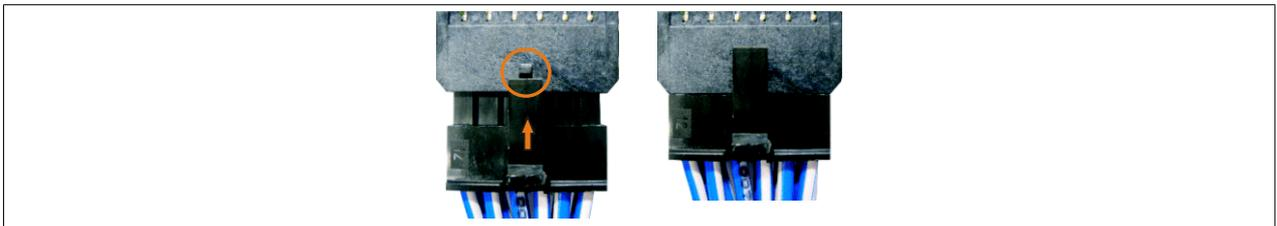
Abbildung 259: Steckerverriegelung
