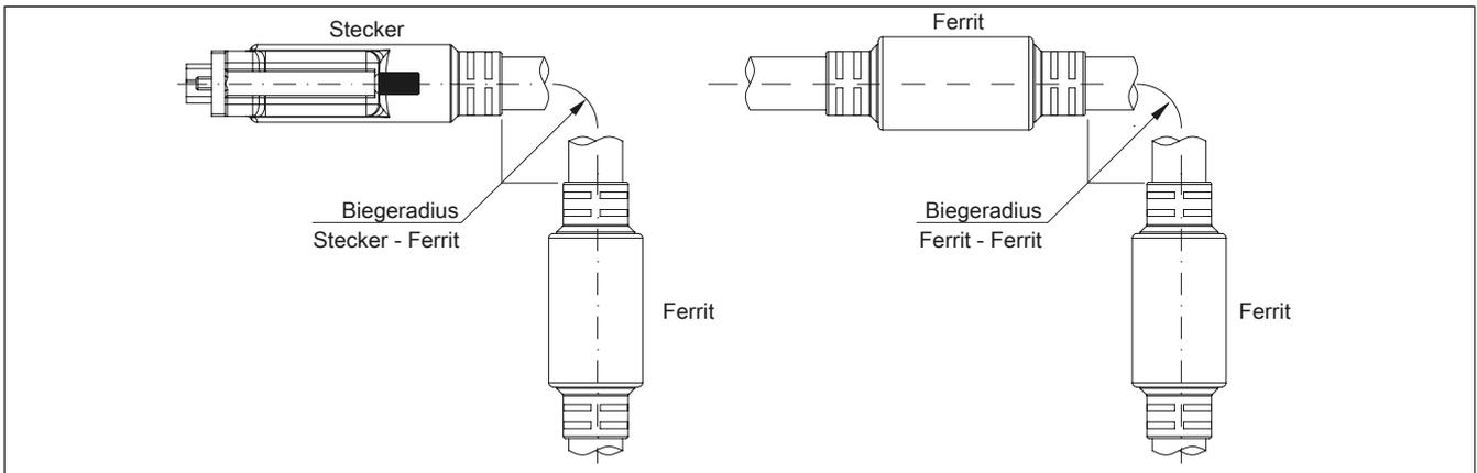
Abbildung 209: Biegeradiusspezifikation
