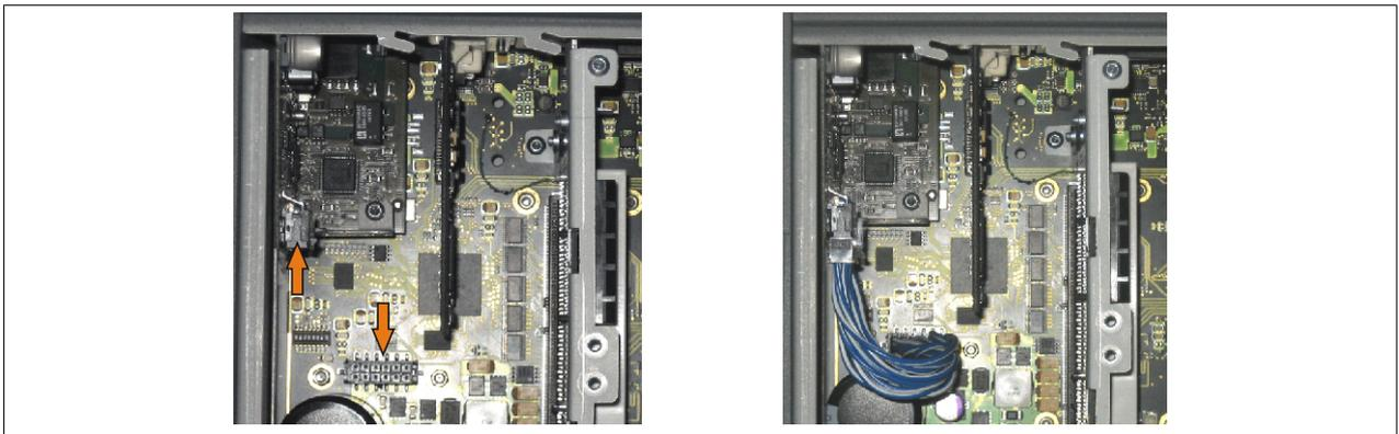
Abbildung 247: Verbindungskabel anstecken
