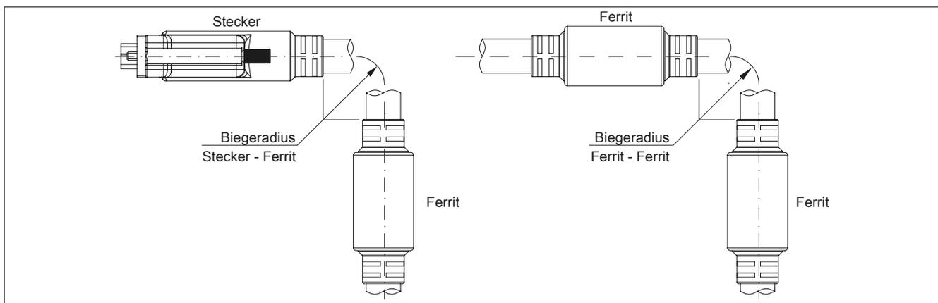
Abbildung 212: Biegeradiusspezifikation
