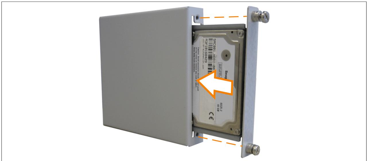
Abbildung 283: Montage der Ersatz Hard Disk an der Ersatzdiskablage
