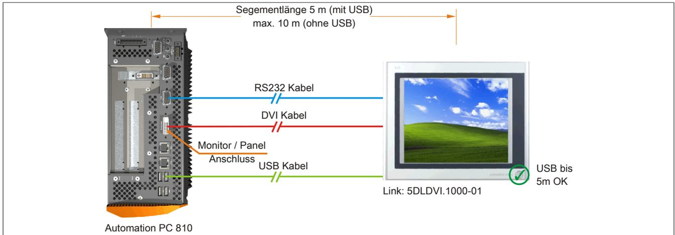
Abbildung 92: Ein Automation Panel 900 über DVI onboard (Symbolfoto)
