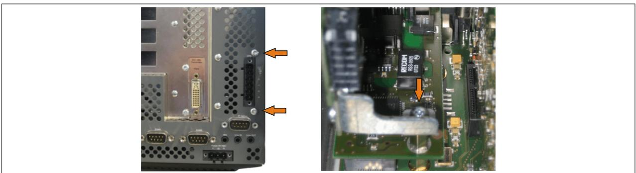
Abbildung 269: USV Modul montieren
