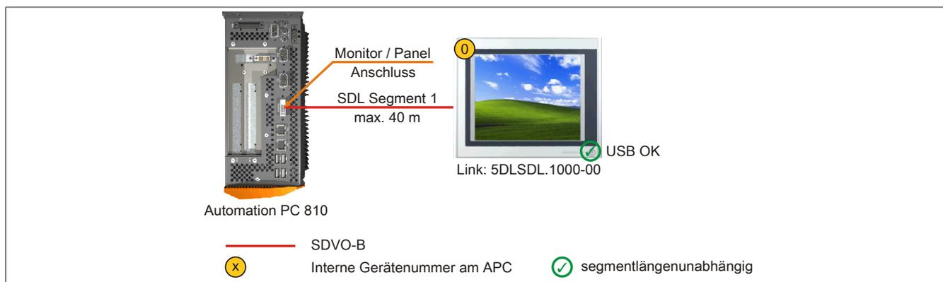
Abbildung 93: Ein Automation Panel 900 über SDL onboard (Symbolfoto)
