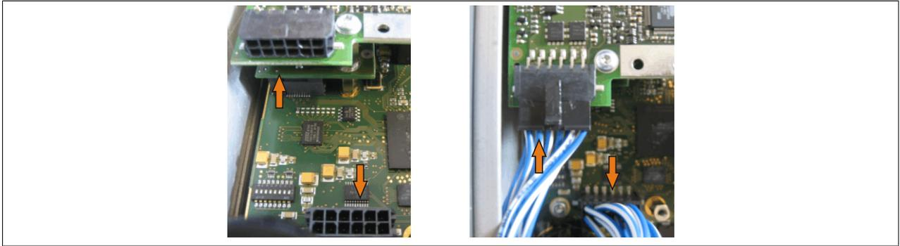
Abbildung 258: Verbindungskabel anstecken
