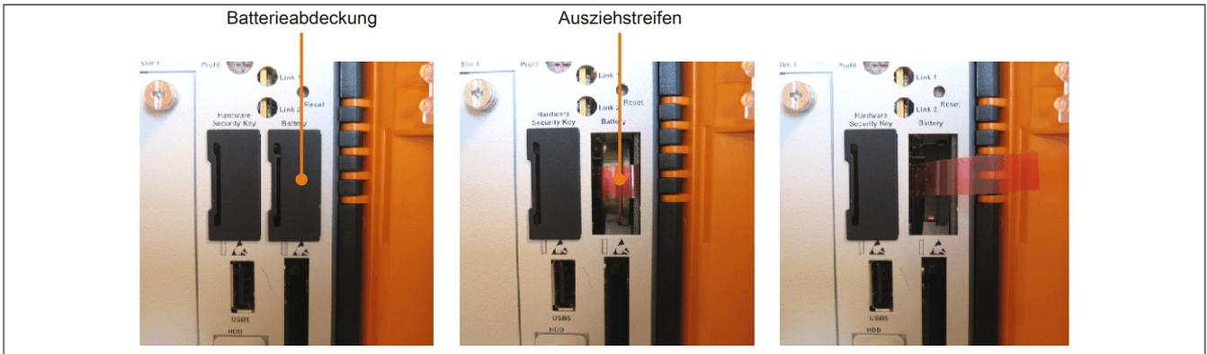
Abbildung 223: Batterie entfernen
