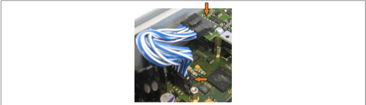
Abbildung 241: Verbindungskabel anstecken
