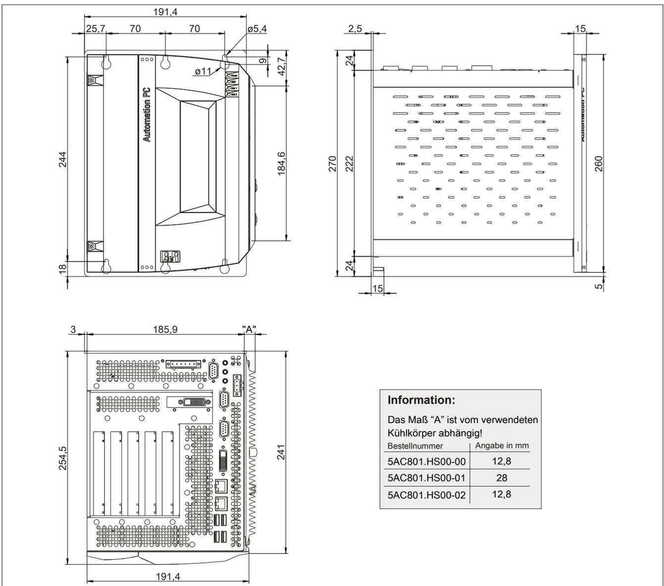
Abbildung 33: 5PC810.SX05-00 - Abmessungen
