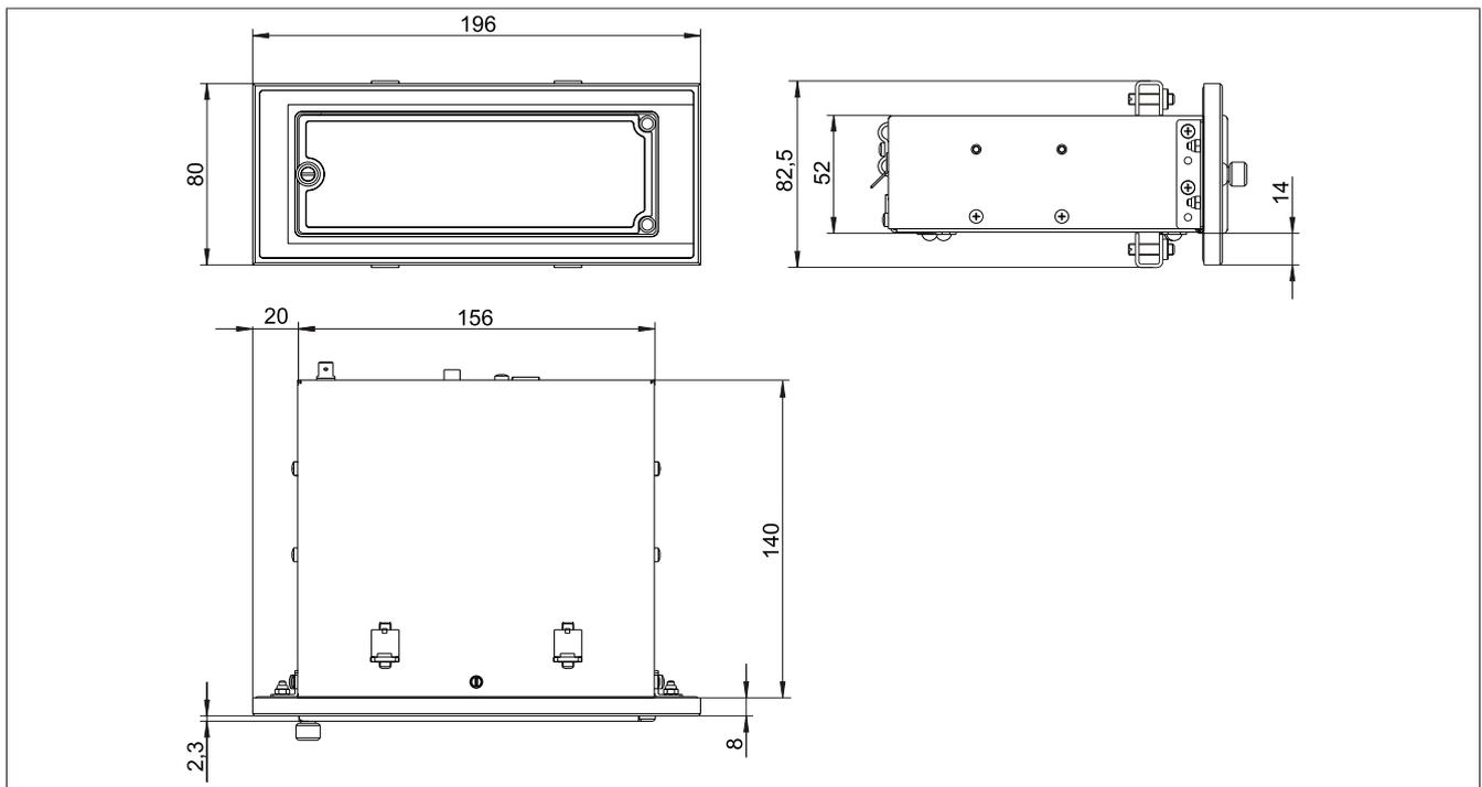
Abbildung 183: Abmessungen USB Media Drive mit Frontklappe
