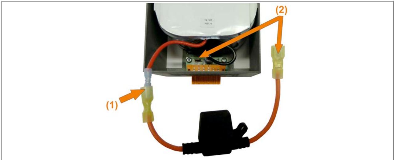
Abbildung 274: Sicherung anschließen
