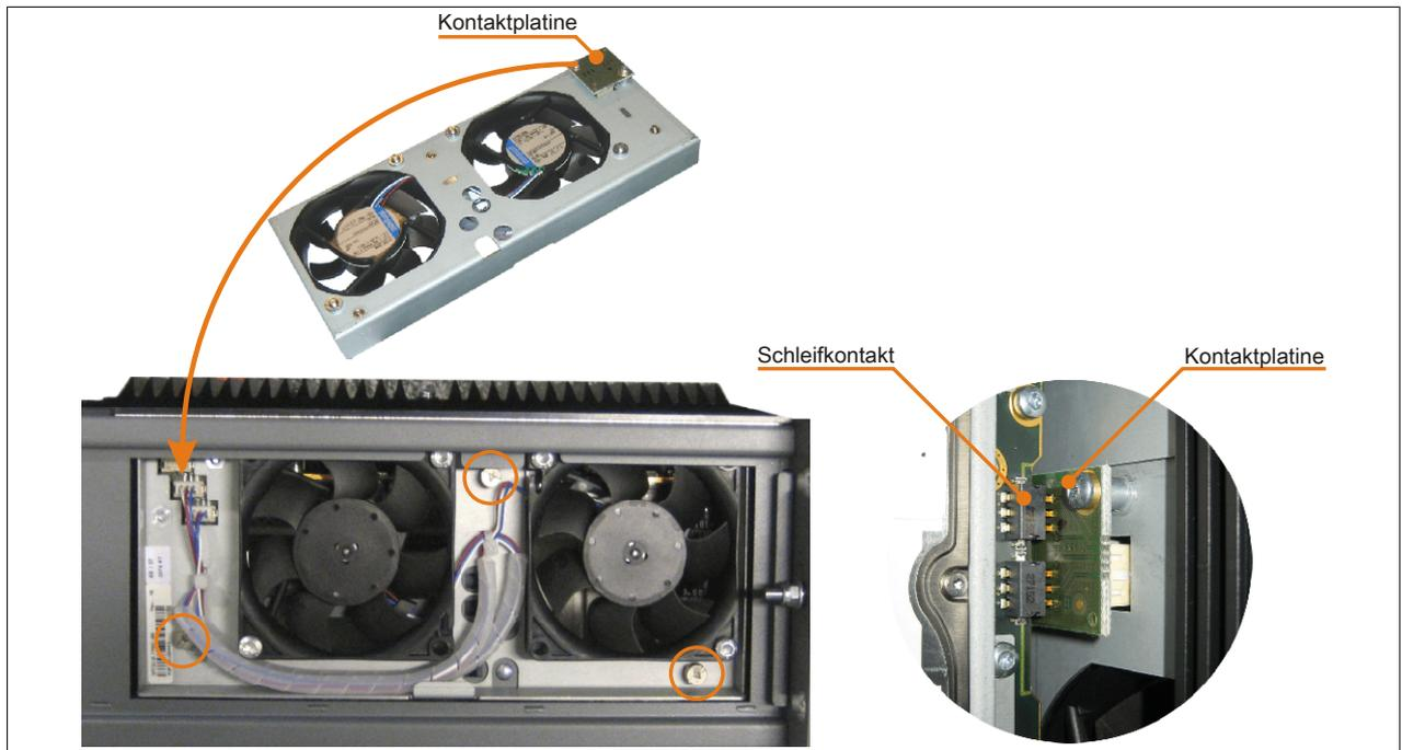
Abbildung 235: Lüfter Kit einlegen und befestigen
