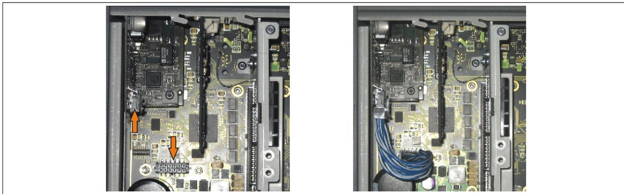
Abbildung 270: Verbindungskabel anstecken
