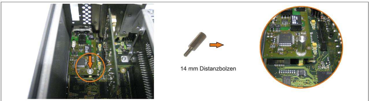
Abbildung 261: Distanzbolzen montieren
