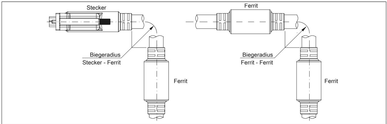
Abbildung 206: Biegeradiusspezifikation
