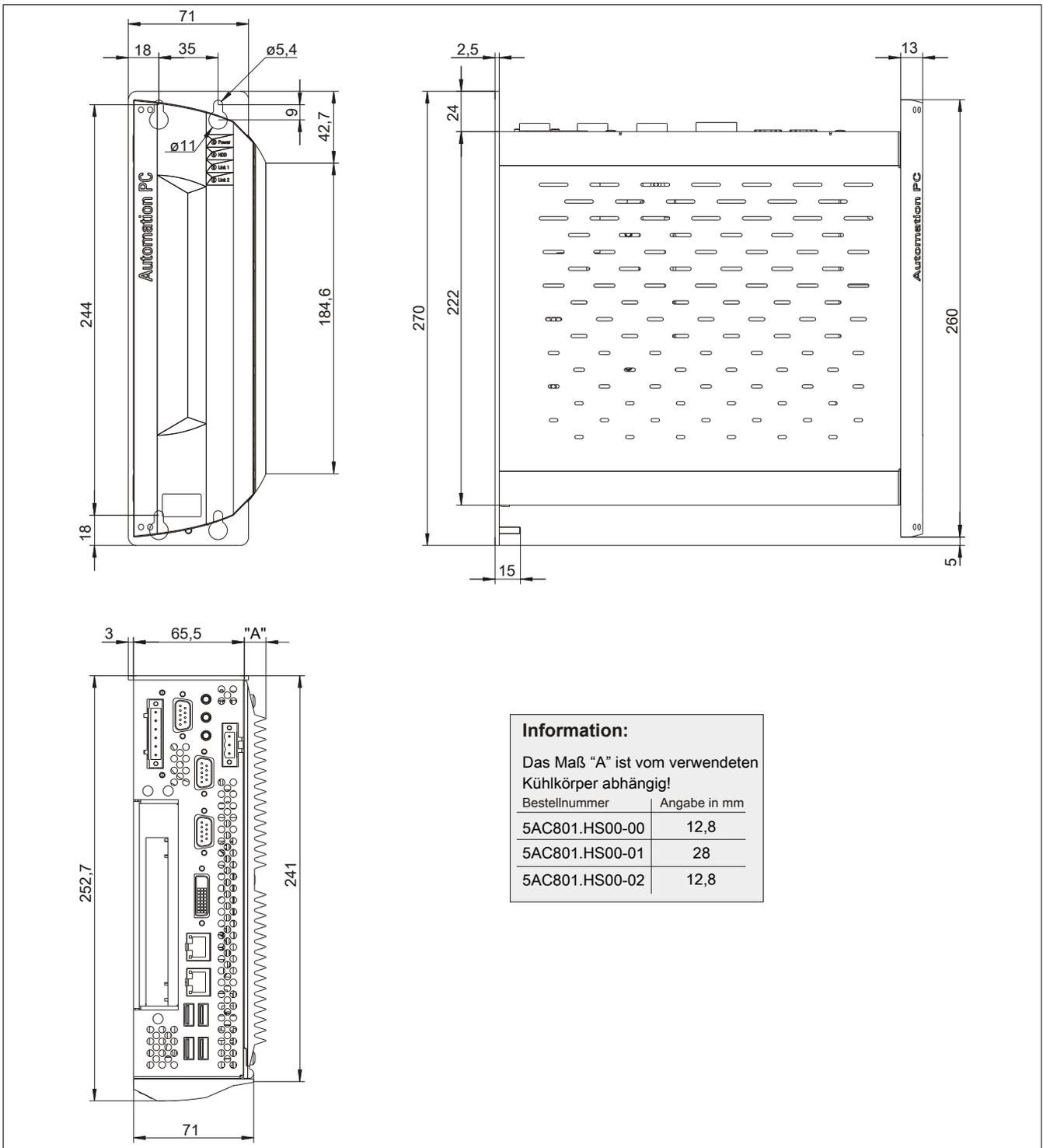
Abbildung 21: 5PC810.SX01-00 - Abmessungen
