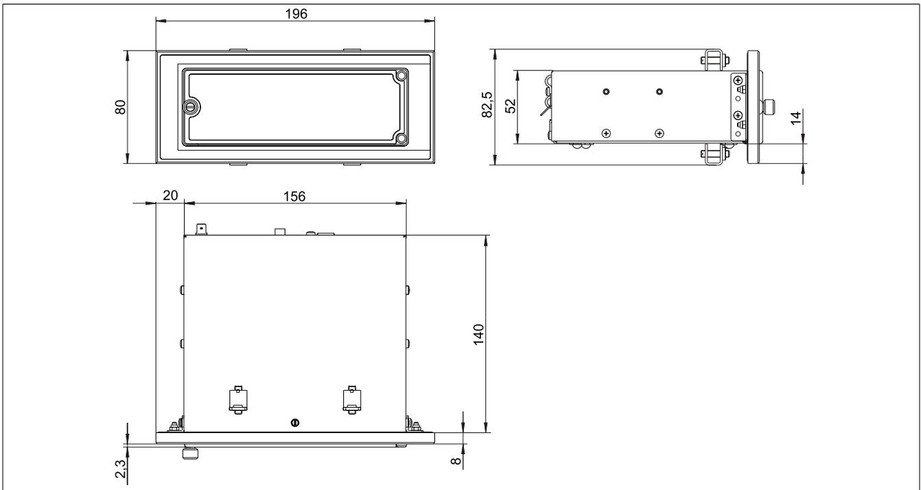
Abbildung 178: Abmessungen USB Media Drive mit Frontklappe
