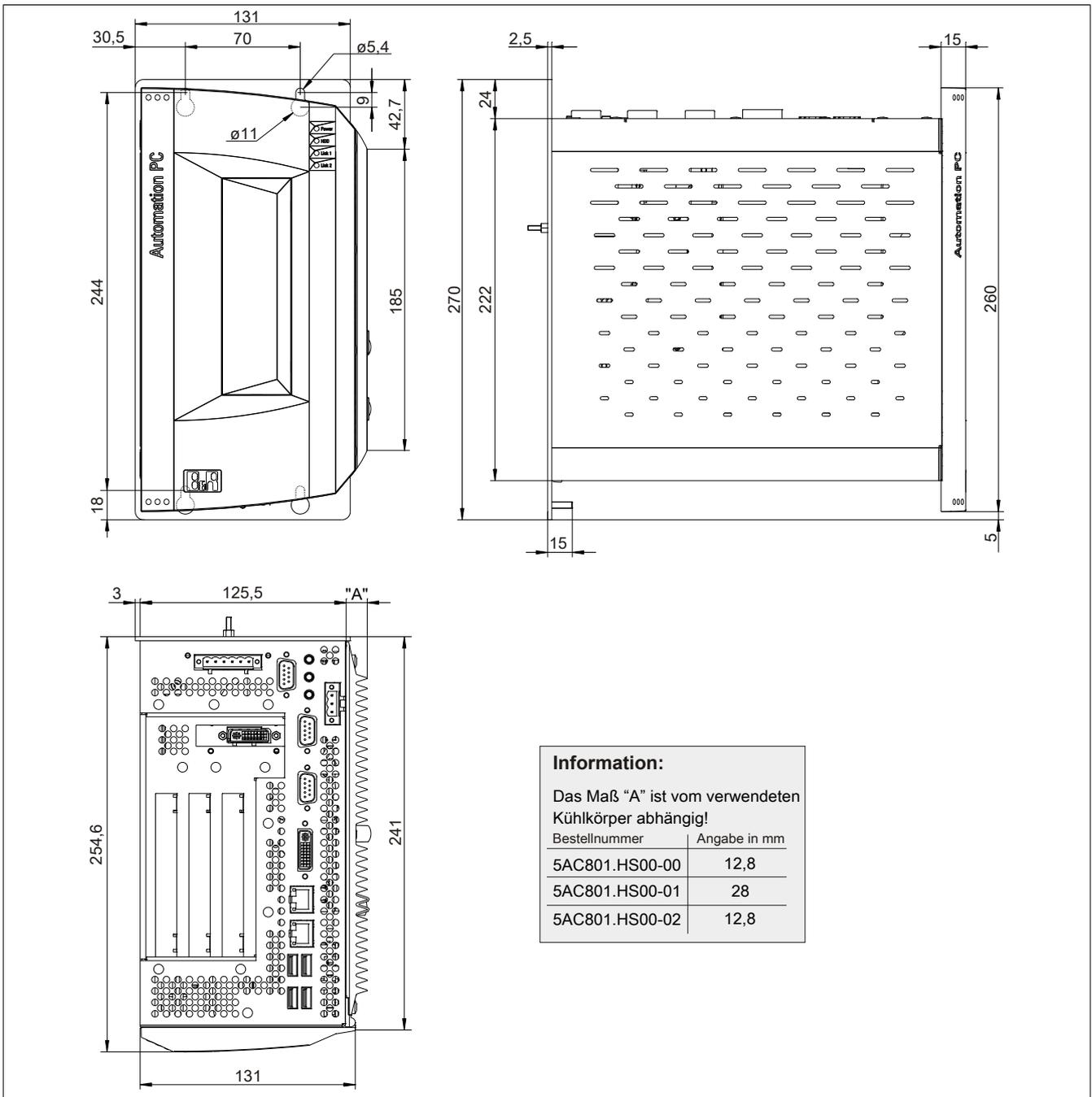
Abbildung 29: 5PC810.SX03-00 - Abmessungen
