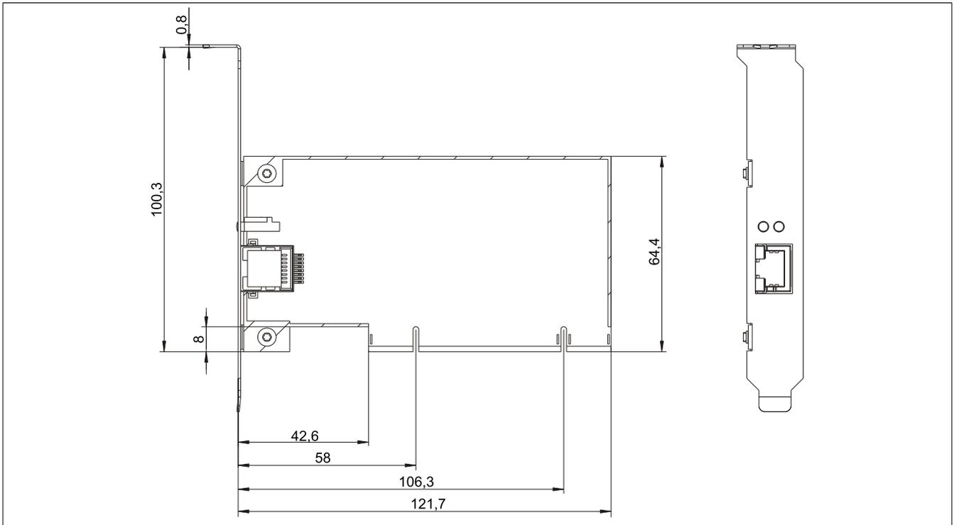
Abbildung 200: 5ACPCI.ETH1-01 - Abmessungen
