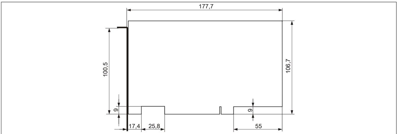
Abbildung 16: Abmessungen Standard half-size 32-Bit PCI Karte
