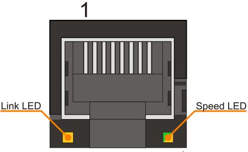
Das Diagramm zeigt den Ethernet-Anschluss (ETH1) mit der Nummer 1. Es ist ein RJ45-Steckplatz mit zwei LEDs: einer orangefarbenen 'Link LED' auf der linken Seite und einer grün/orangen 'Speed LED' auf der rechten Seite. Die LEDs sind durch Linien mit den entsprechenden Spalten in der Tabelle verbunden.
