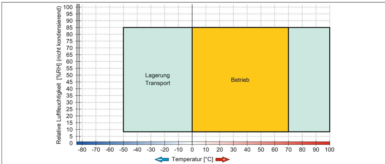
Abbildung 166: 5CFCRD.xxxx-06 - Temperatur Luftfeuchtediagramm CompactFlash-Karten
