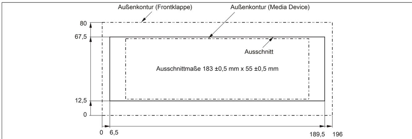
Abbildung 184: Einbauausschnitt USB Media Drive mit Frontklappe
