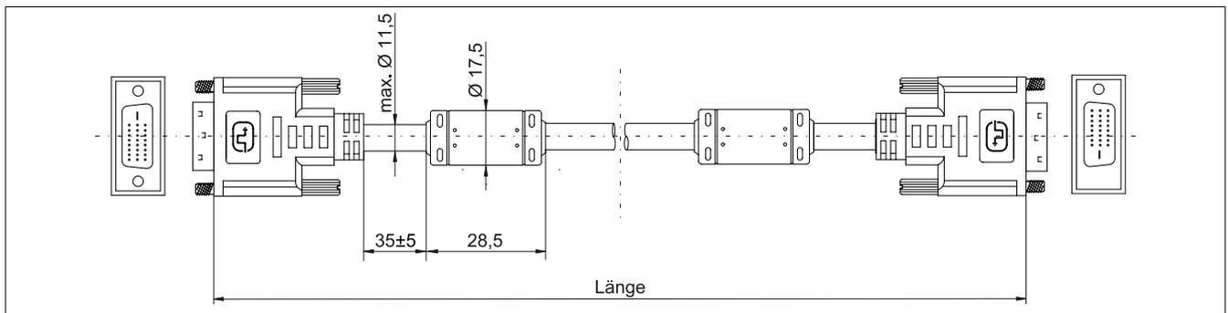
Abbildung 207: 5CASDL.0xxx-00 - Abmessungen
