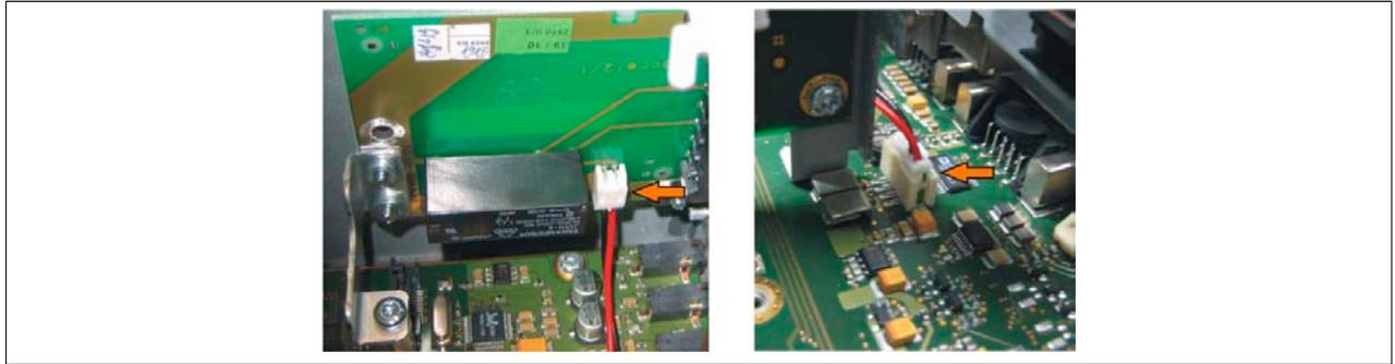
Abbildung 288: Verbindungskabel anstecken
