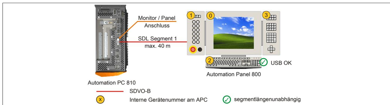
Abbildung 94: Ein Automation Panel 800 über SDL onboard (Symbolfoto)
