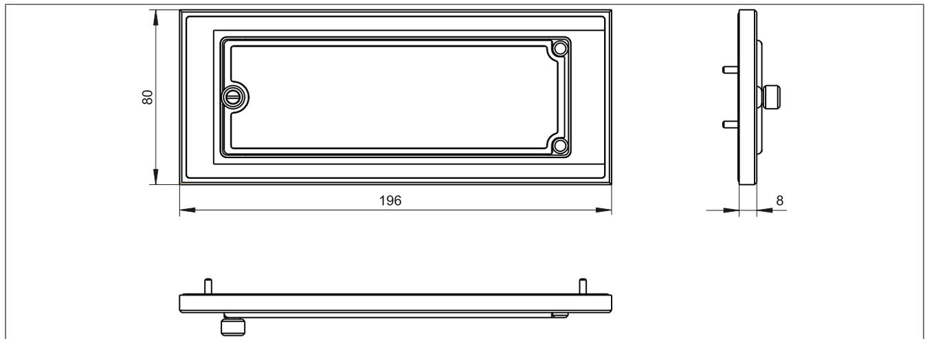
Abbildung 186: 5A5003.03 - Abmessungen
