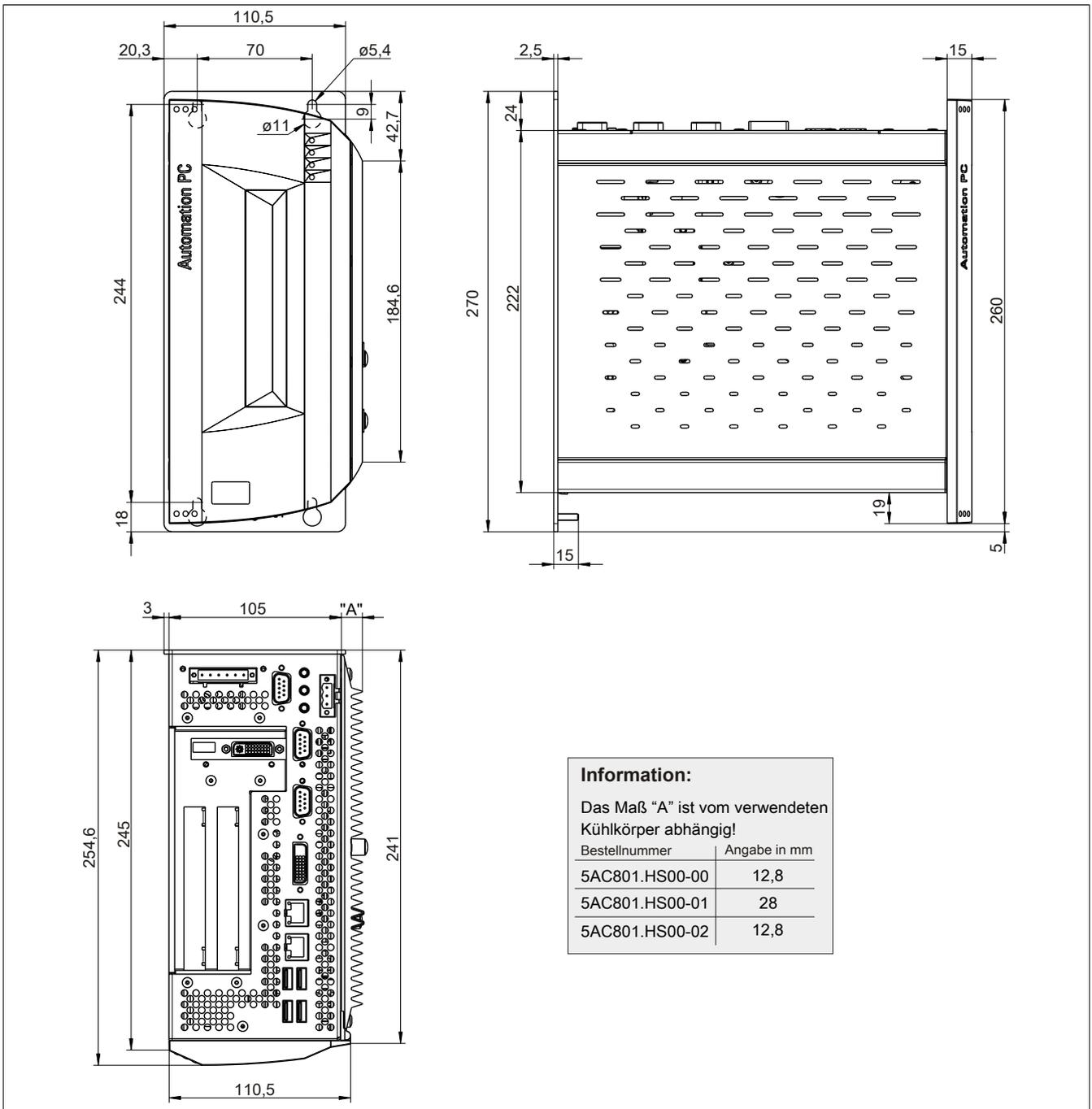
Abbildung 25: 5PC810.SX02-00 - Abmessungen
