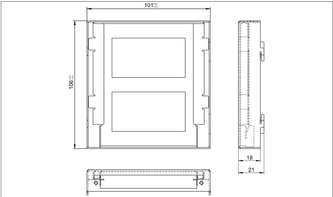
Abbildung 222: 5AC801.FRAM-00 - Abmessungen
