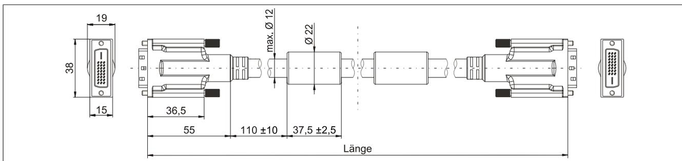
Abbildung 213: 5CASDL.0xxx-03 - Abmessungen
