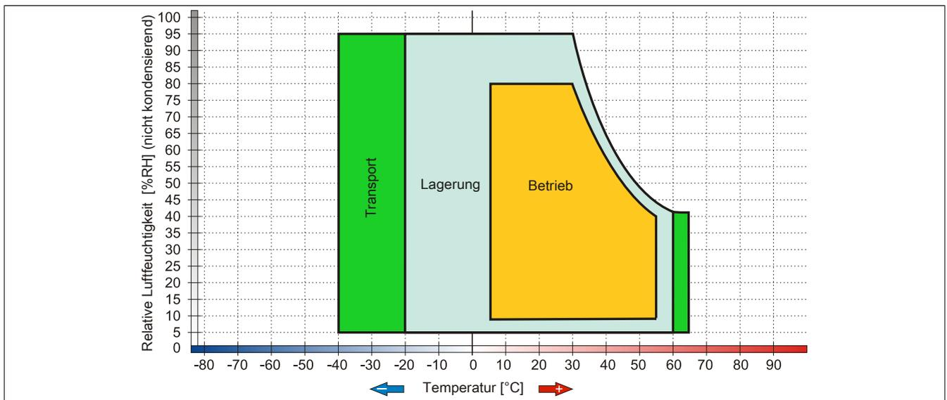
Abbildung 55: 5AC801.DVRS-00 - Temperatur Luftfeuchtediagramm
