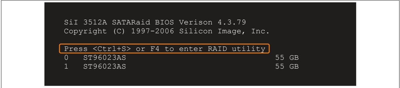
Abbildung 105: Einstieg in das RAID Configuration Utility
