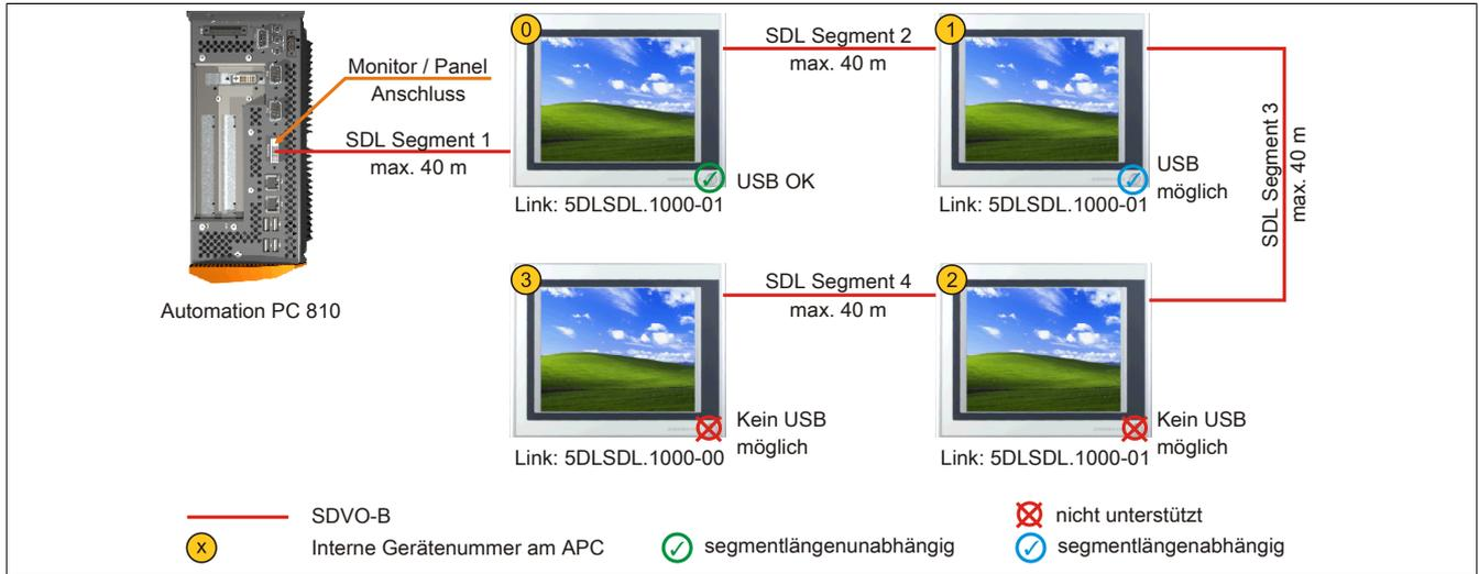
Abbildung 96: Vier Automation Panel 900 über SDL onboard (Symbolfoto)
