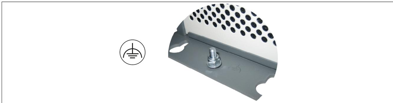
Mit der M4 Sicherheitsmutter kann z.B. ein Kupferband, das an einem zentralen Erdungspunkt des Schaltschranks oder der Anlage in der der APC810 eingebaut wird, befestigt werden. Der Leitungsquerschnitt sollte dabei so groß wie möglich (mindestens 2,5 mm<sup>2</sup>) gewählt werden.
