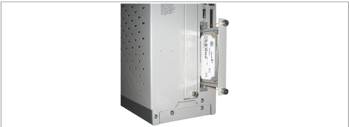
Abbildung 228: Compact SATA Laufwerk einschieben
