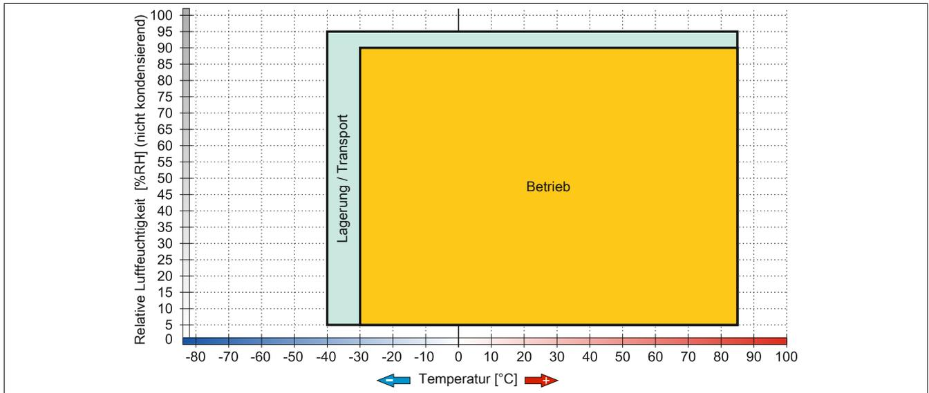
Abbildung 51: 5AC801.SSDI-04 ≥ Rev. D0 - Temperatur Luftfeuchtediagramm
