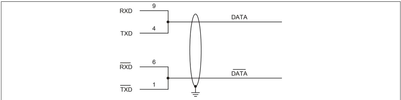
Abbildung 82: Add-on RS232/422/485 Interface - Betrieb im RS485 Modus
