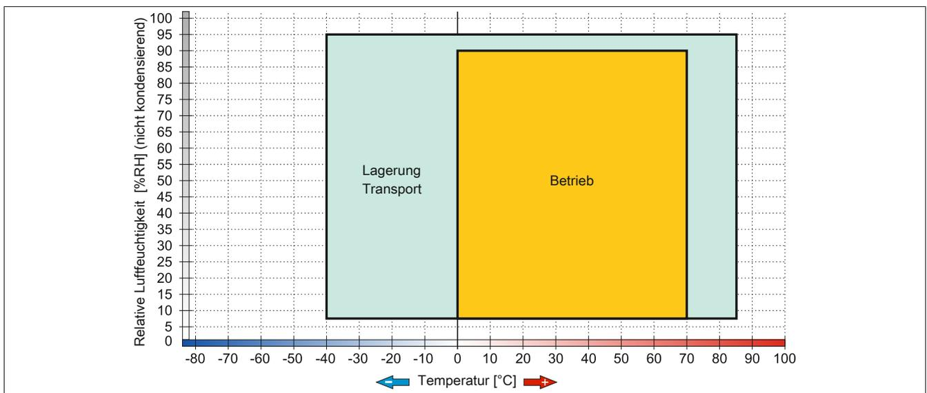
Abbildung 66: 5MMSSD.0060-01 ≤ Rev. C0 - Temperatur Luftfeuchtediagramm
