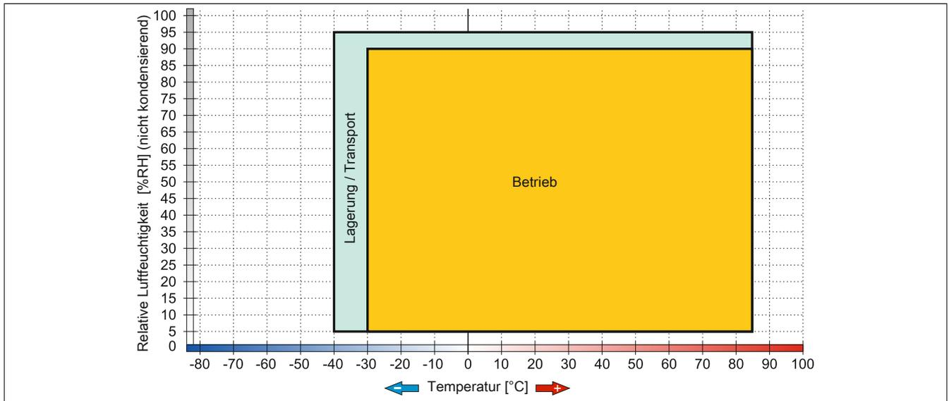
Abbildung 67: 5MMSSD.0060-01 ≥ Rev. D0 - Temperatur Luftfeuchtediagramm
