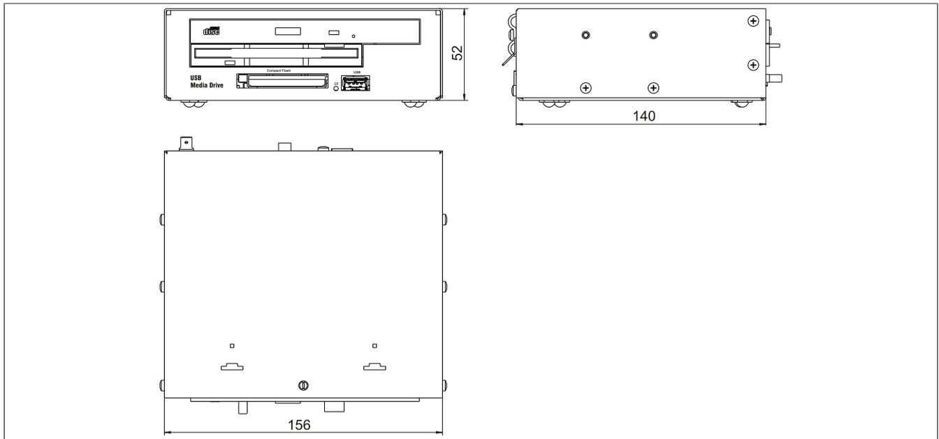
Abbildung 177: 5MD900.USB2-01 - Abmessungen
