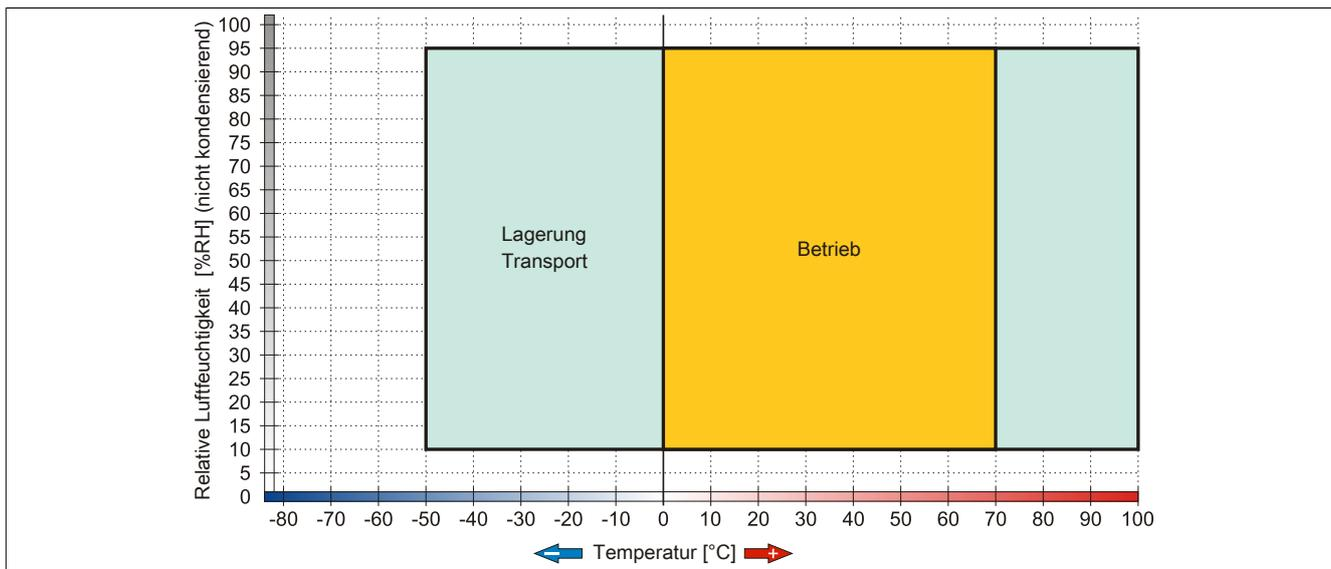
Abbildung 174: 5CFCRD.xxxx-03 - Temperatur Luftfeuchtediagramm CompactFlash-Karten
