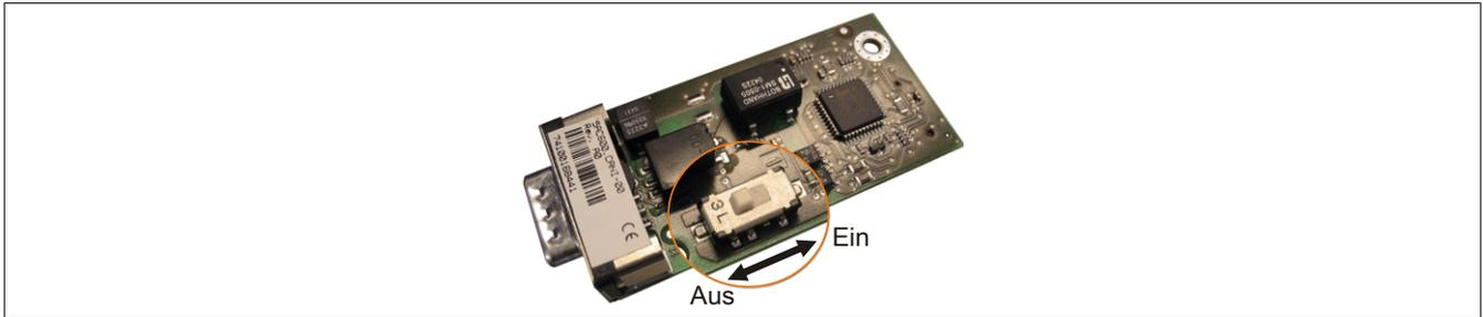
Abbildung 80: 5AC600.CANI-00 - Abschlusswiderstand Add-on CAN Interface
