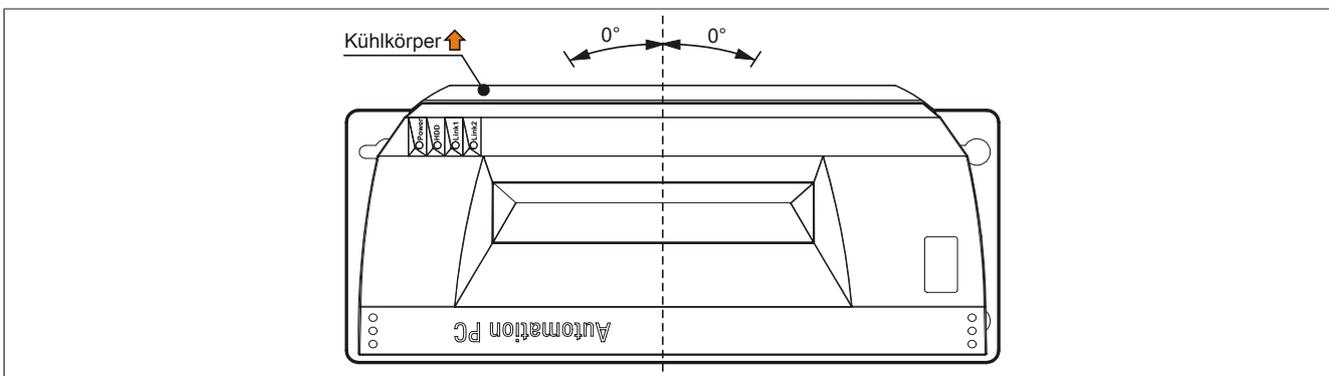
Abbildung 86: Einbaulage - waagrecht
