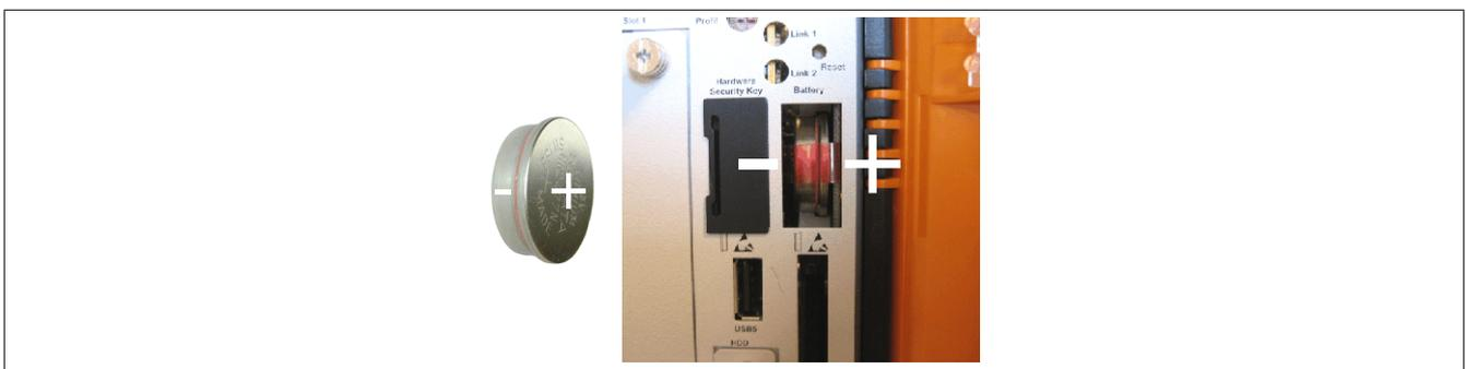
Abbildung 225: Batteriepolarität
