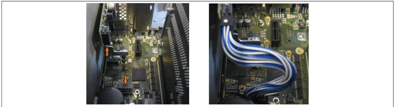
Abbildung 253: Verbindungskabel anstecken
