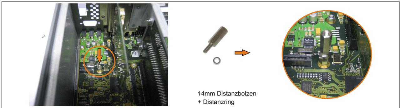
Abbildung 244: Distanzbolzen und Distanzring montieren
