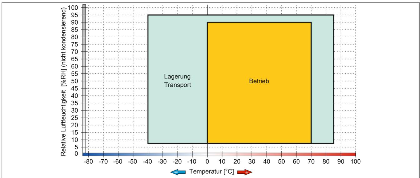
Abbildung 68: 5MMSSD.0128-01 ≤ Rev. C0 - Temperatur Luftfeuchtediagramm
