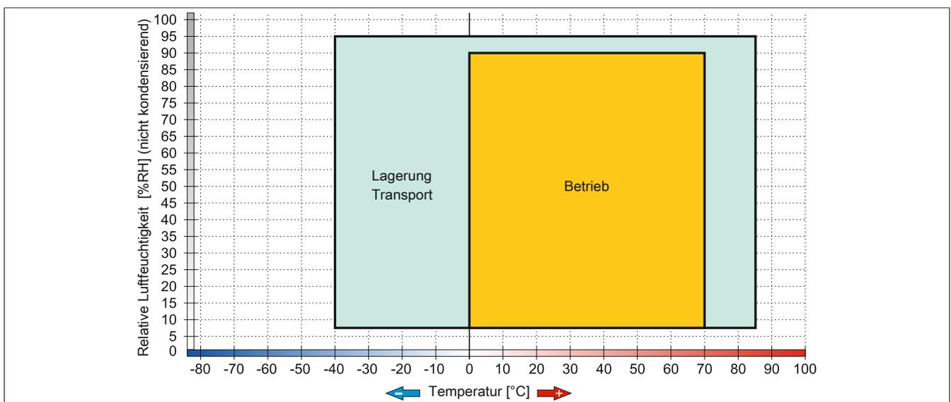
Abbildung 50: 5AC801.SSDI-04 ≤ Rev. C0 - Temperatur Luftfeuchtediagramm
