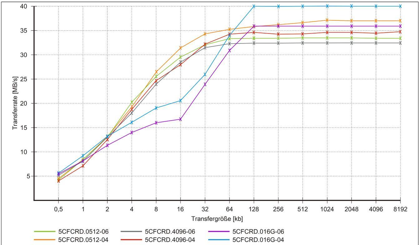
Abbildung 168: ATTO Disk Benchmark v2.34 Vergleich Lesen - 5CFCRD.xxxx-04 mit 5CFCRD.xxxx-06
