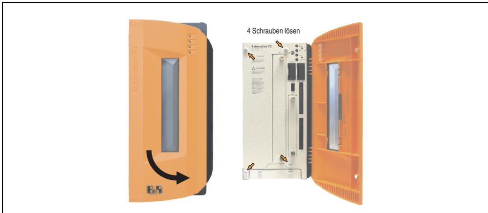
Abbildung 262: APC810 2 Card Slot Seitendeckeldemontage
