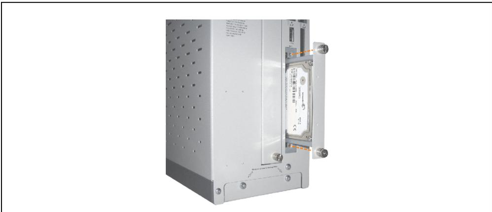
Abbildung 217: Compact SATA Laufwerk einschieben
