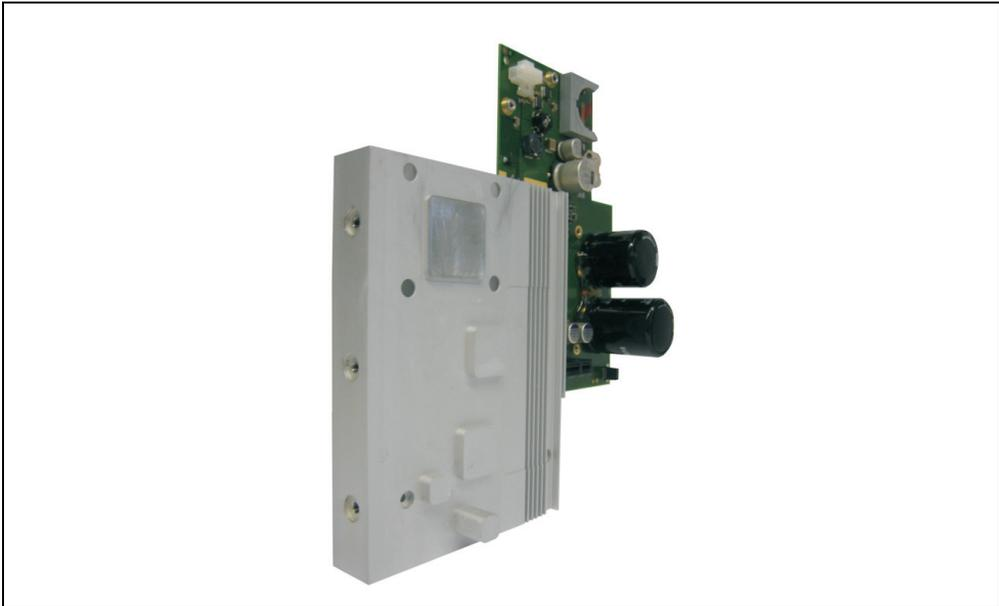
Abbildung 18: Netzteil mit Kühlkörper
