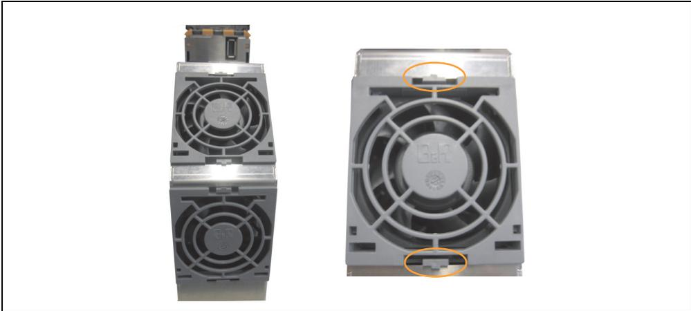
Abbildung 124: Lösen des Lüfters
