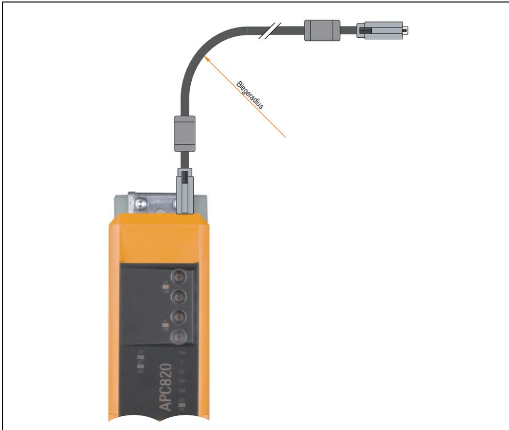
Abbildung 30: Biegeradius Kabelanschluss
