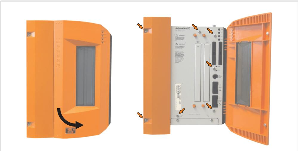
Abbildung 322: APC620 5 PCI Slot Seitendeckelmontage
