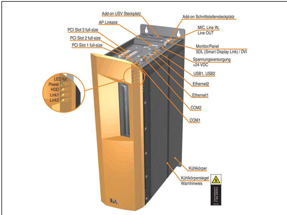
Abbildung 13: APC620 3 PCI Slot Variante Schnittstellenübersicht Oberseite
