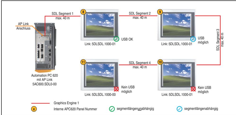
Abbildung 105: Konfiguration - Vier Automation Panel 900 über SDL (AP Link)
