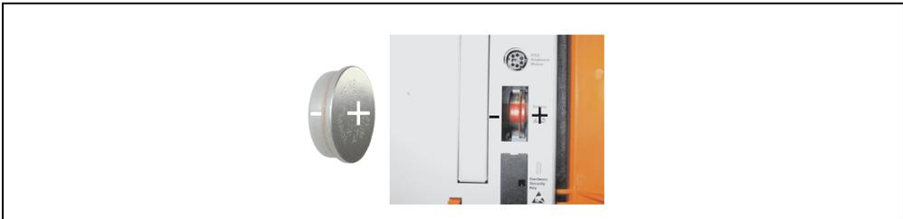
Abbildung 250: Batteriepolartät
