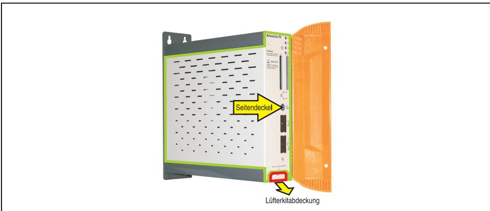
Abbildung 252: APC620 1PCI Slot - Seitendeckel und Lüfterkitabdeckung entfernen
