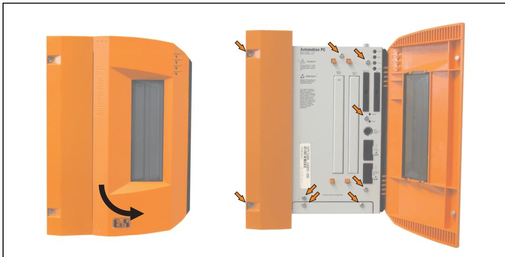
Abbildung 268: APC620 5PCI Slot - Schrauben für den Filterkit Ein- und Ausbau lösen
