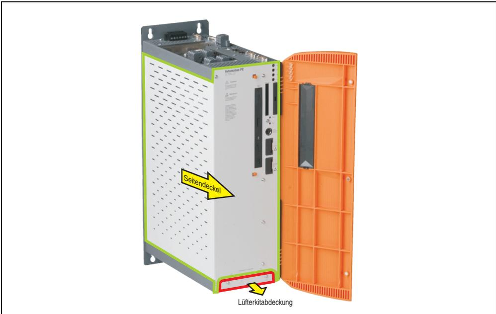
Abbildung 263: APC620 3PCI Slot - Seitendeckel und Lüfterkitabdeckung entfernen
