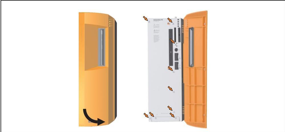
Abbildung 262: APC620 3PCI Slot - Schrauben für den Filterkit Ein- und Ausbau lösen
