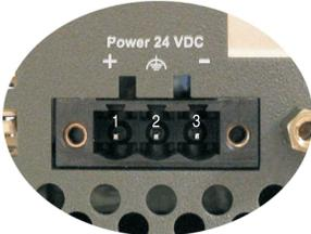
Abbildung 35: Spannungsversorgungsanschluss
