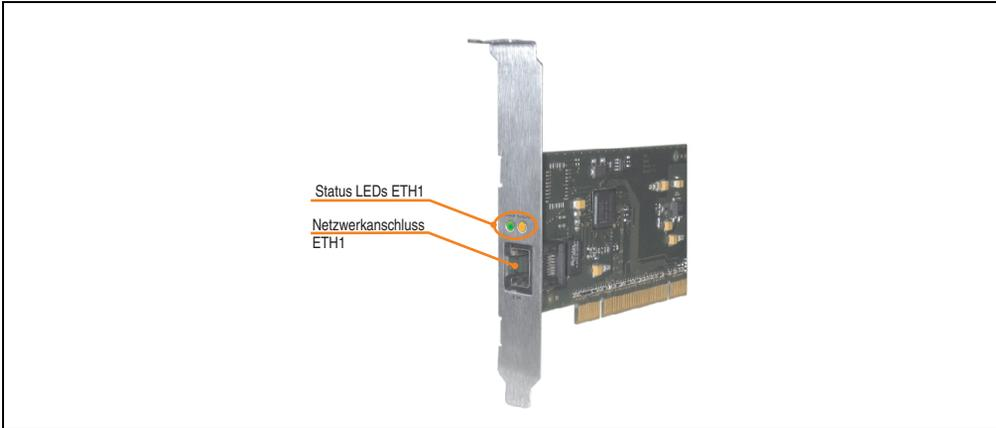
Abbildung 240: PCI Ethernet Card 10/100 - 5ACPCI.ETH1-01
