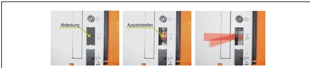
Abbildung 248: Batterie herausziehen
