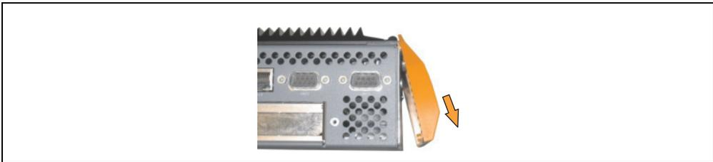
Abbildung 328: APC620 Frontklappe Demontage
