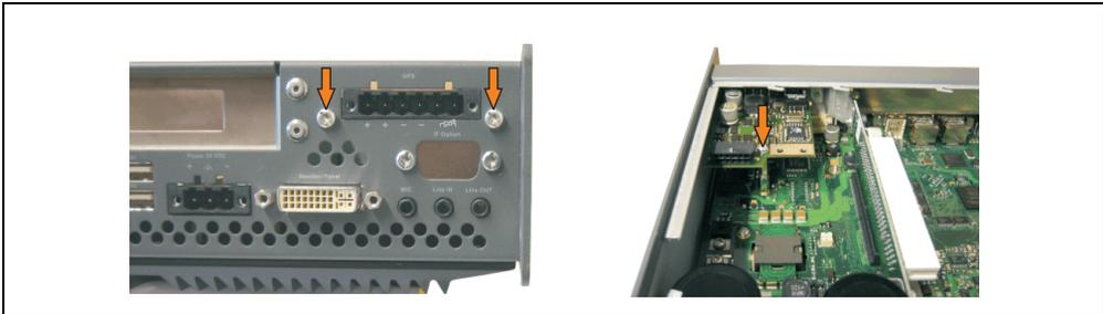
Abbildung 283: USV Modul montieren
