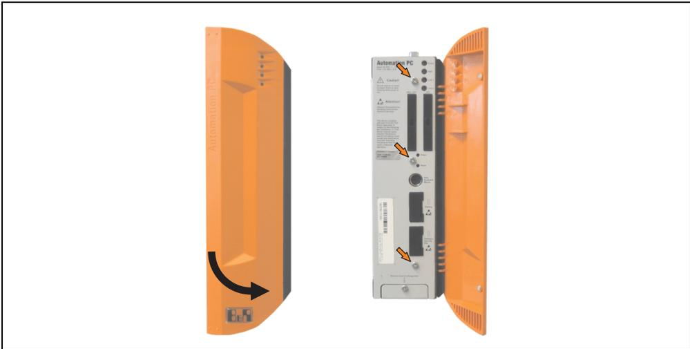
Abbildung 319: APC620 1 PCI Slot Seitendeckelmontage
