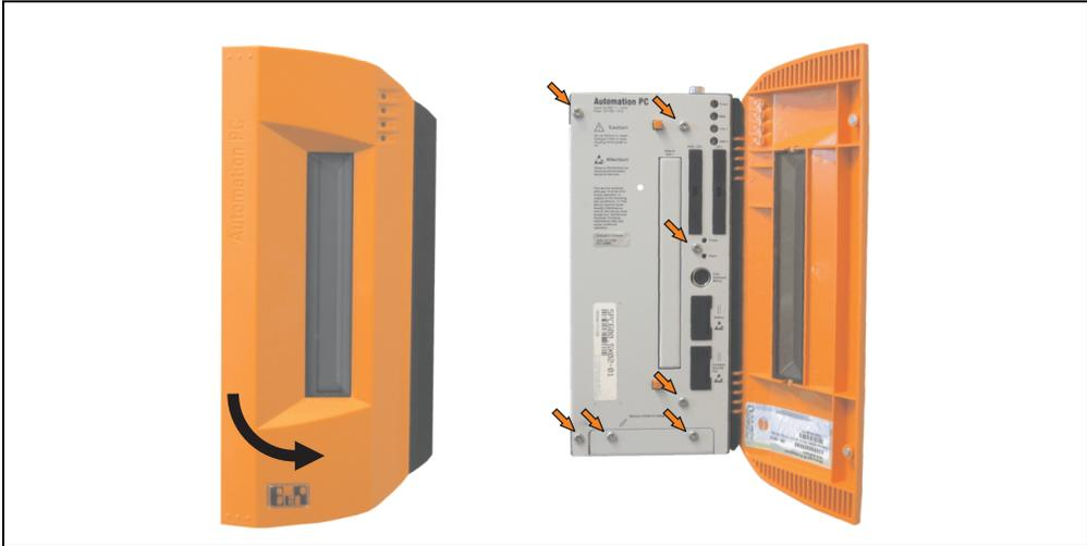
Abbildung 256: APC620 2PCI Slot - Schrauben für den Filterkit Ein- und Ausbau lösen
