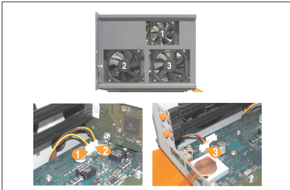
Abbildung 273: APC620 5PCI Slot - Lüfterkabelanschluss auf dem Basisboard
