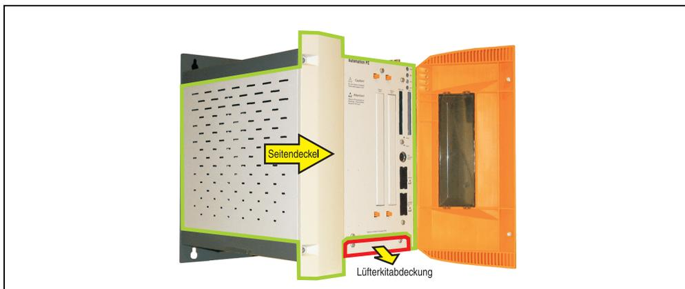
Abbildung 269: APC620 5PCI Slot - Seitendeckel und Lüfterkitabdeckung entfernen
