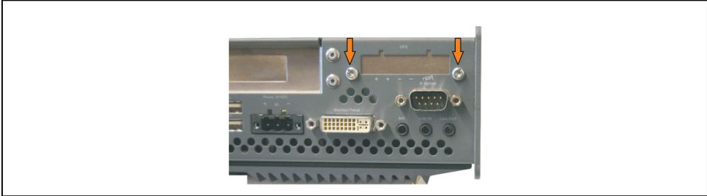
Abbildung 300: USV Modulabdeckung entfernen
