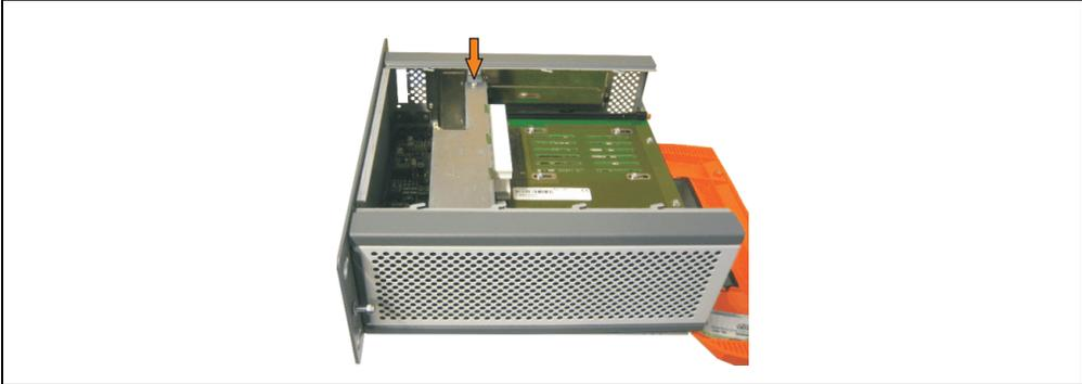
Abbildung 306: Abdeckblech entfernen
