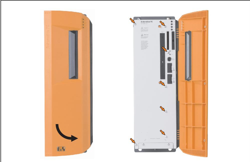
Abbildung 321: APC620 3 PCI Slot Seitendeckelmontage
