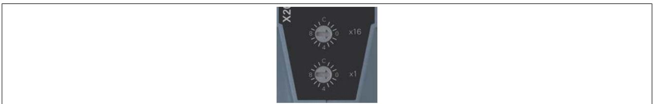
Mittels der beiden Nummernschalter wird die Knotennummer des POWERLINK-Knotens eingestellt. Die Knotennummer kann auch über das Automation Studio konfiguriert werden.
