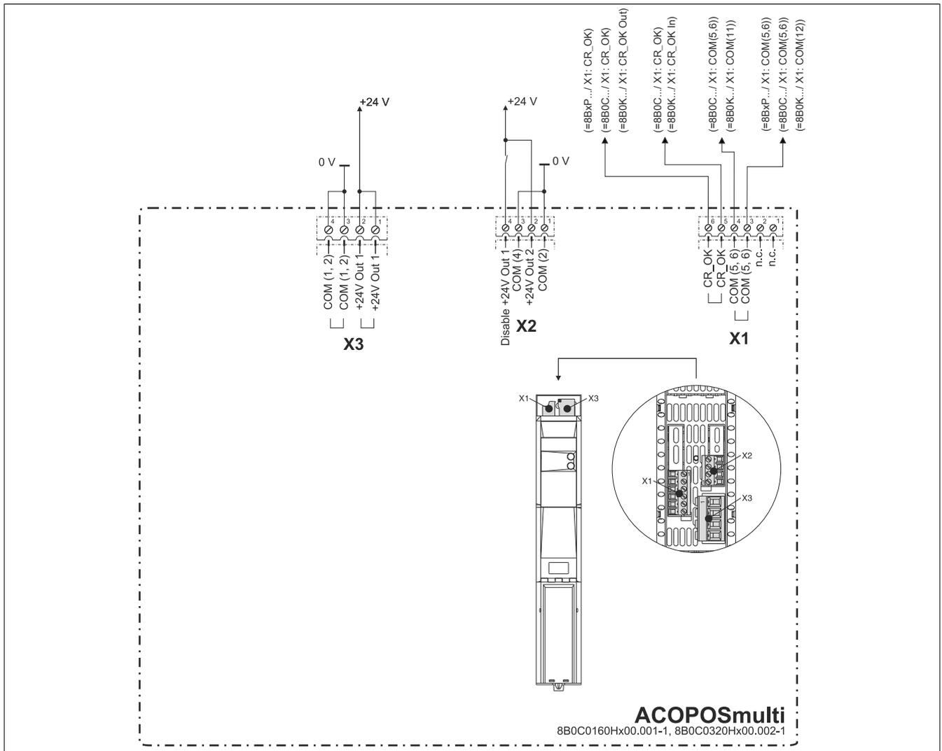
Abbildung 3: Übersicht Anschlussbelegungen 8B0C0160Hx00.001-1, 8B0C0320Hx00.002-1
