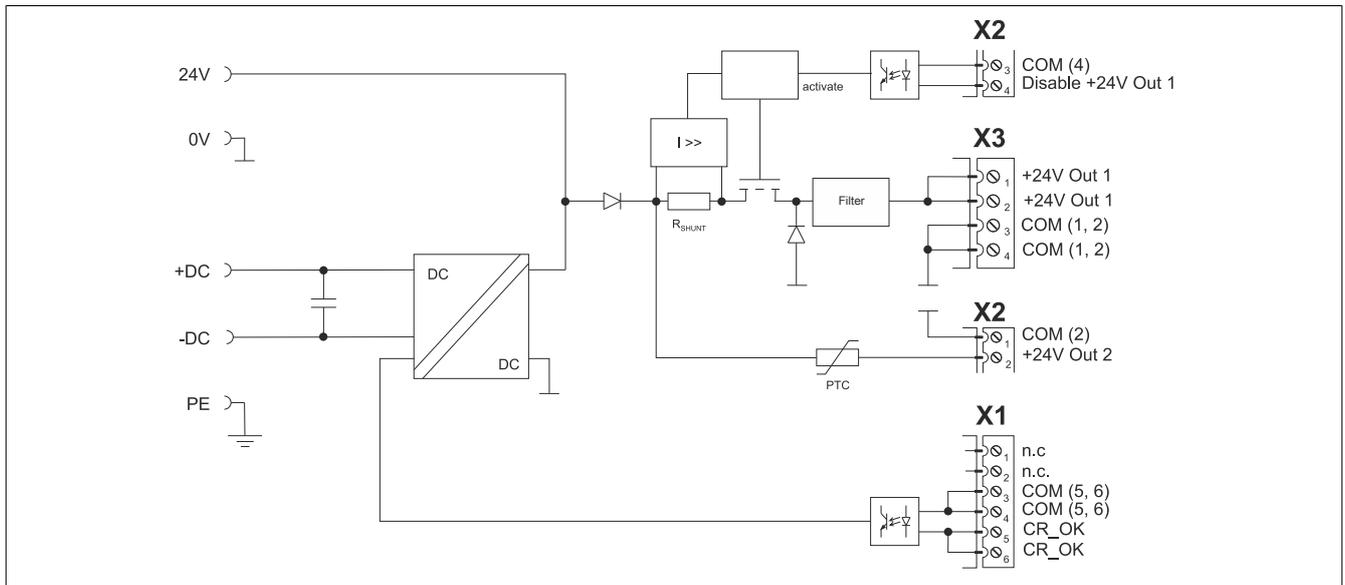
Abbildung 4: Ein-/Ausgangsschema 8B0C0160Hx00.001-1, 8B0C0320Hx00.002-1
