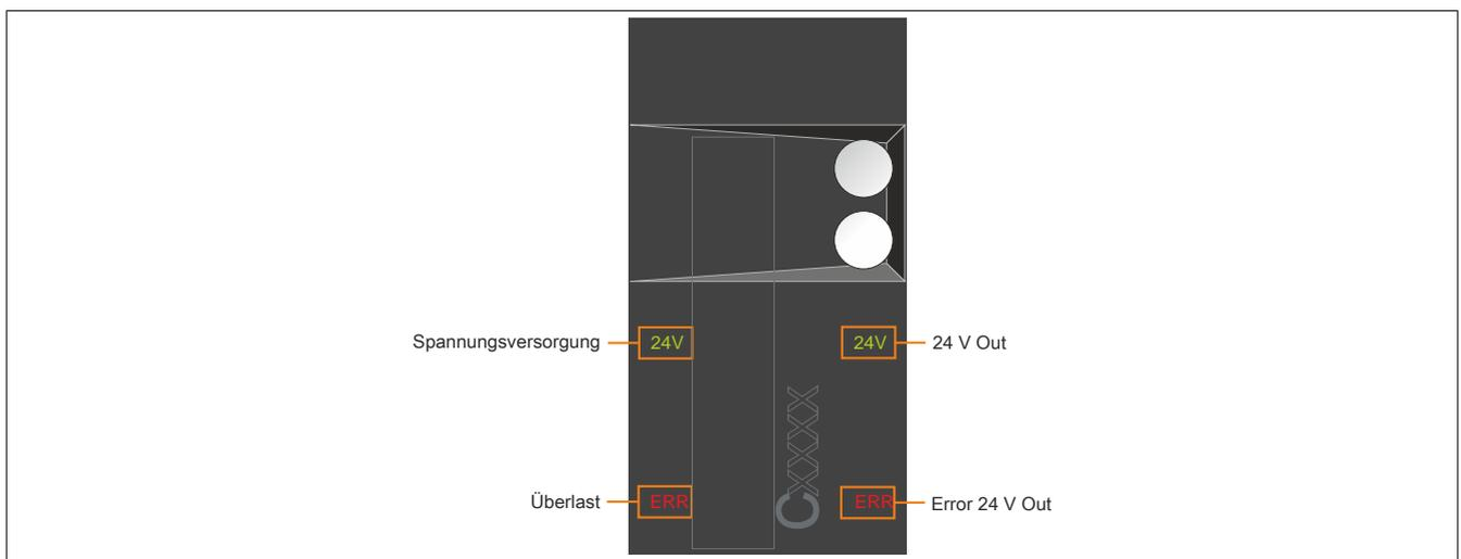
Abbildung 1: Anzeigengruppen Hilfsversorgungsmodule mit 24 V Out (8B0C0xx0Hx00.00x-1)
