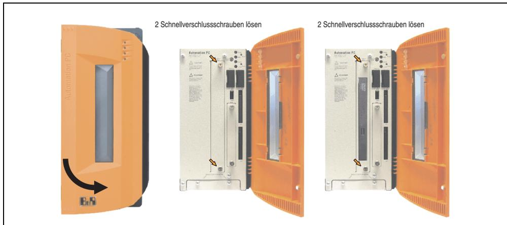
Abbildung 202: Schnellverschlusschrauben lösen
