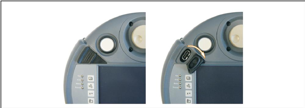
Abbildung 43: USB Schnittstelle - Schutzklappe öffnen
