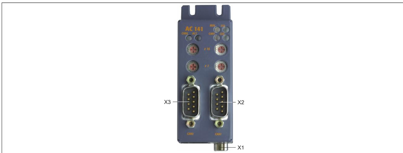
Abbildung 4: Übersicht Anschlüsse AC141 (Ansicht von vorne)
