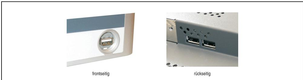
Abbildung 3: Automation Panel USB Anschlüsse (frontseitig - rückseitig)
