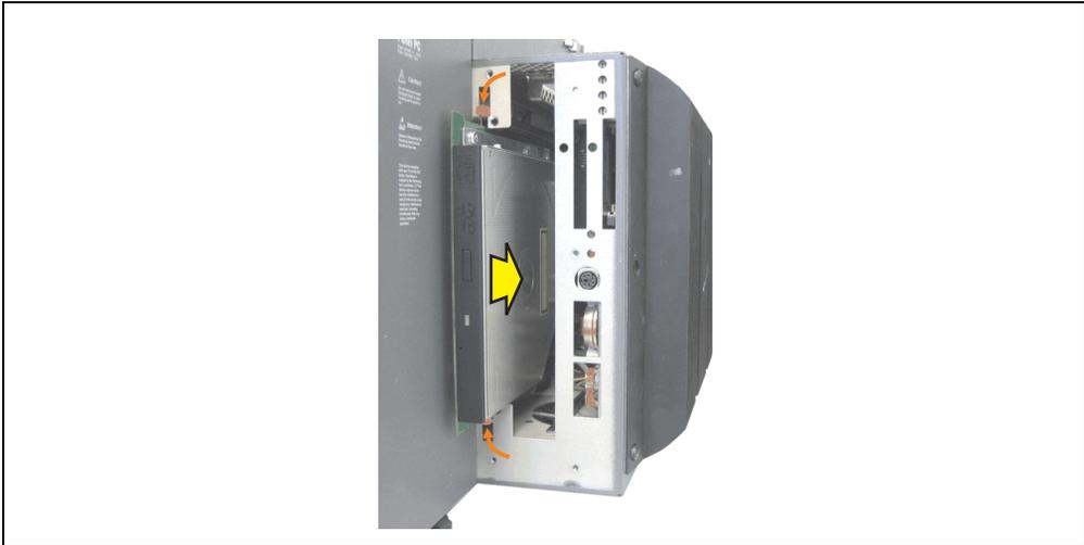
Abbildung 272: Slide-In Laufwerkseinbau
