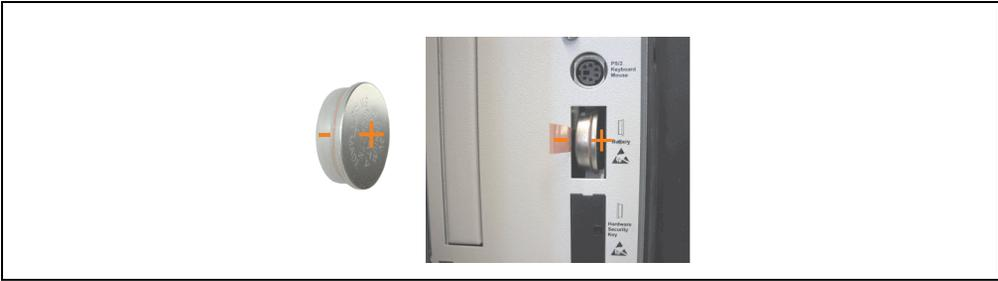
Abbildung 256: Batteriepolartät
