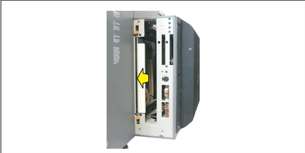
Abbildung 268: Slide-In Blindmodulentfernung
