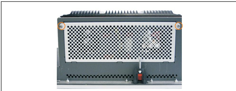
Abbildung 262: Lüfterkabinendeckung abnehmen
