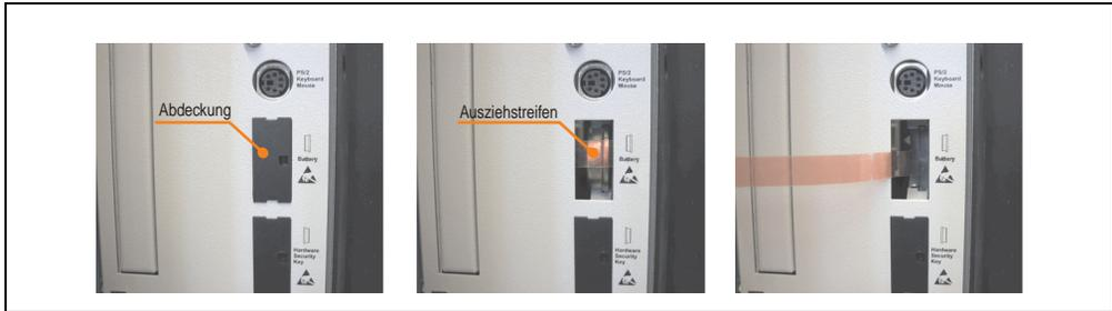
Abbildung 254: Batterie herausziehen
