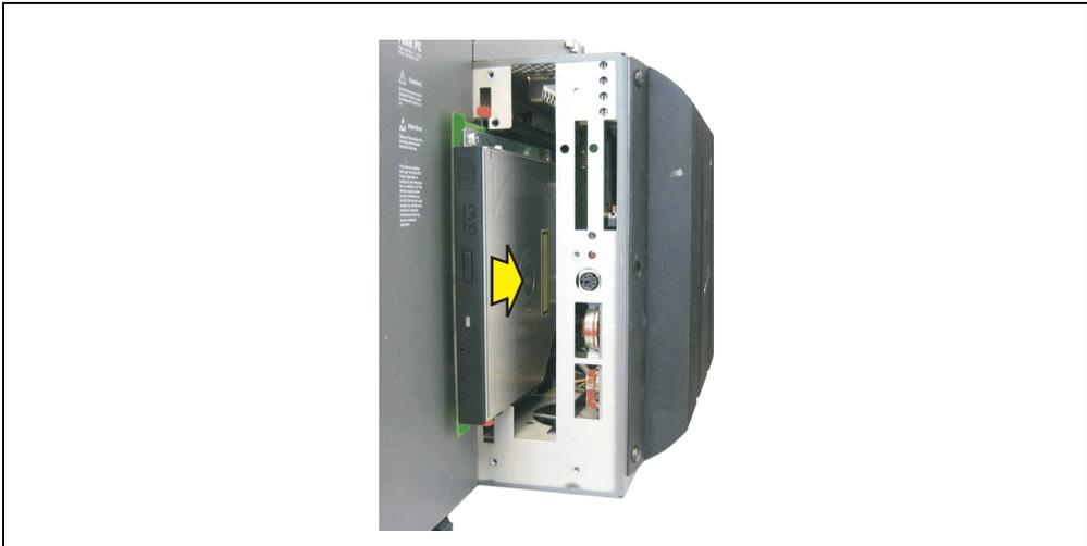
Abbildung 269: Slide-In Laufwerkseinbau
