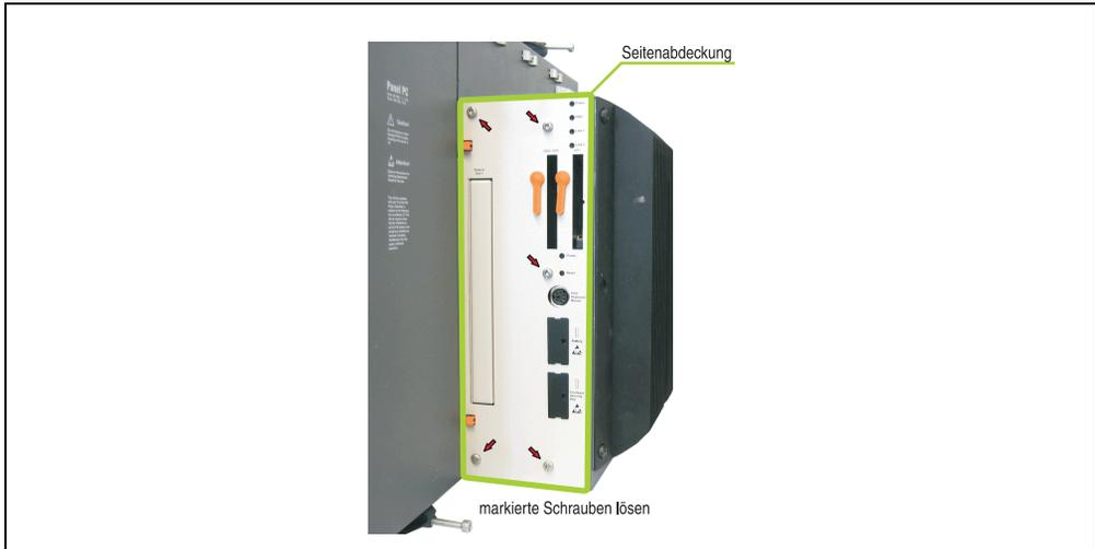
Abbildung 216: Beispiel Seitendeckeldemontage bei Systemeinheit 5PC720.1505-02
