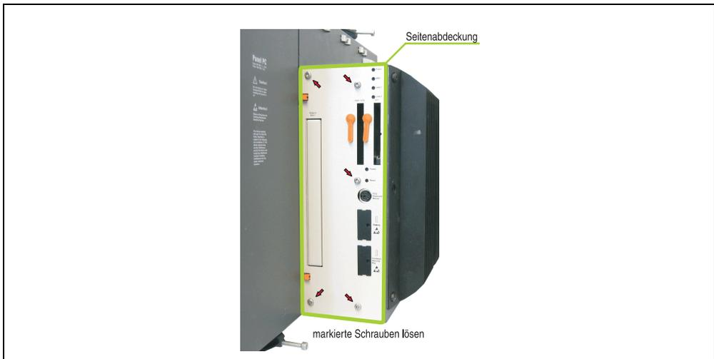
Abbildung 213: Beispiel Seitendeckeldemontage bei Systemeinheit 5PC720.1505-02
