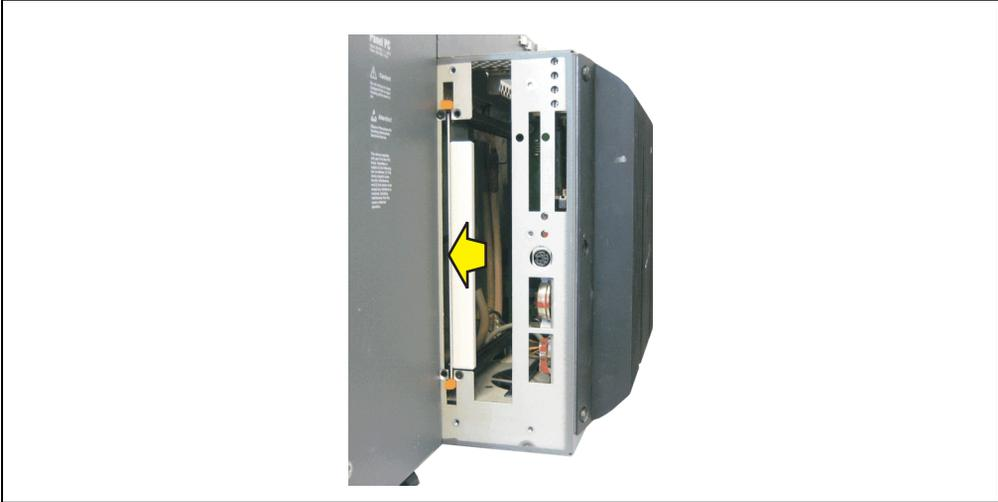
Abbildung 214: Slide-In Blindmodulentfernung
