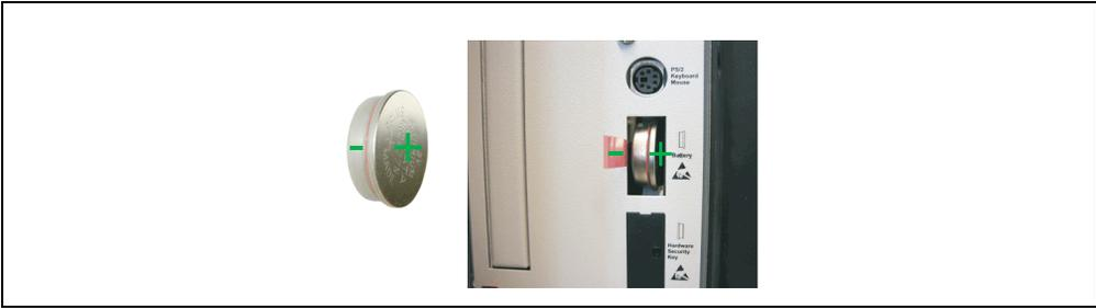
Abbildung 212: Batteriepolartät
