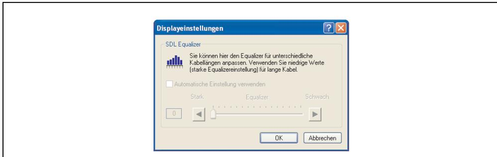
Abbildung 223: SDL Equalizer Einstellung beim B&R Control Center
