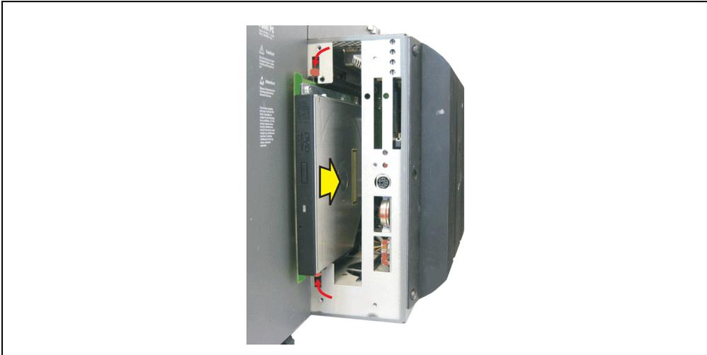
Abbildung 218: Slide-In Laufwerkseinbau
