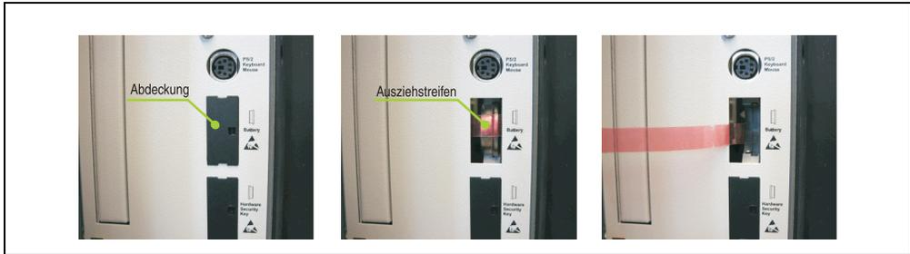
Abbildung 210: Batterie herausziehen
