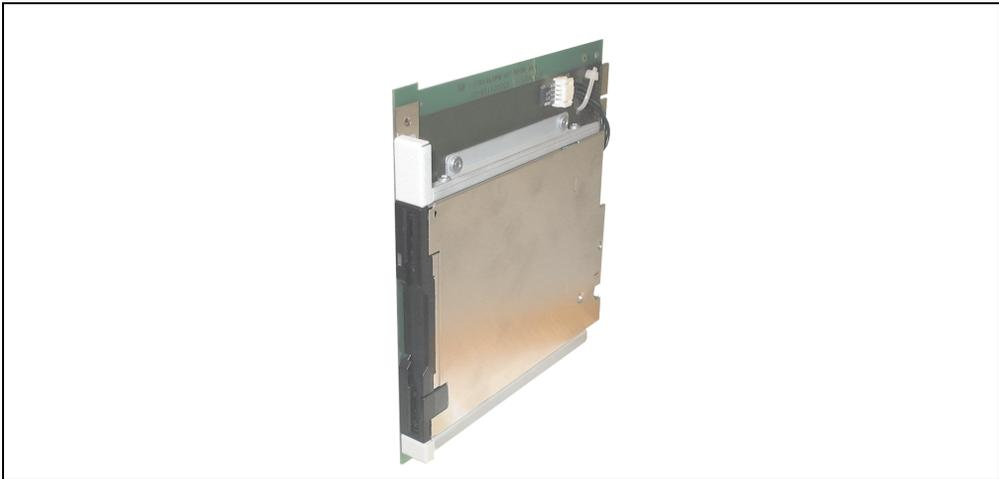
Abbildung 75: Slide-In USB FDD - 5AC600.FDDS-00
