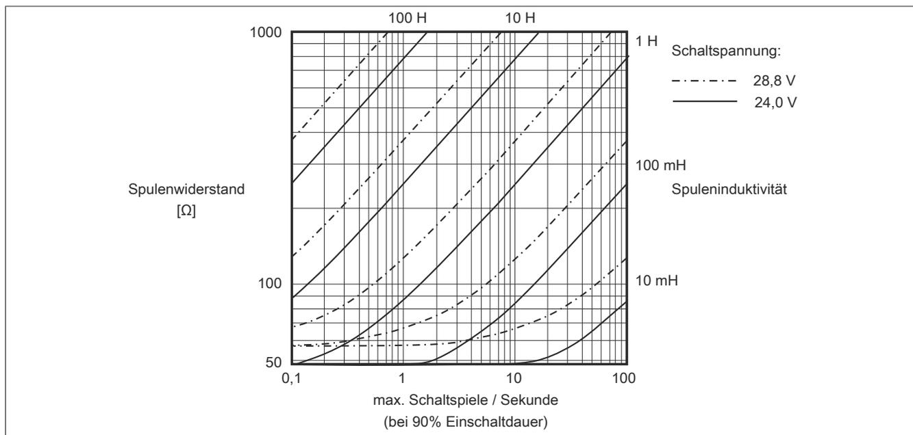
Umgebungstemperatur: 60°C, alle Ausgänge gleich belastet
