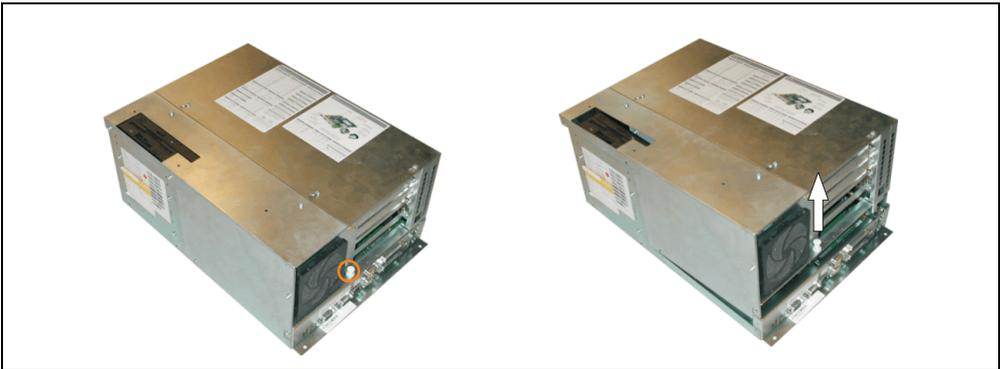
Abbildung 321: Entriegeln des Sicherheitszapfens und Buseinheit abnehmen
