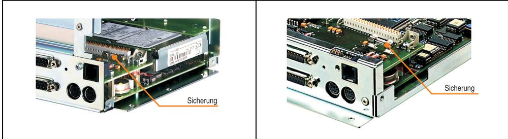
Abbildung 62: Sicherungsposition IPC5000 (links) und IPC5600 (rechts)
