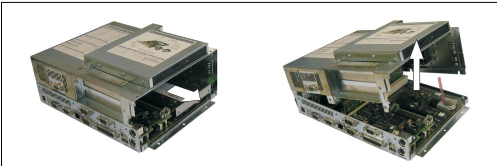
Abbildung 319: Abnehmen der Abdeckung und der Buseinheit
