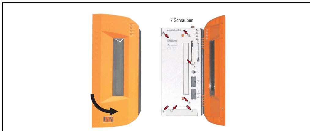
Abbildung 160: APC620 2PCI Slot - Schrauben für den Filterkit Ein- und Ausbau lösen
