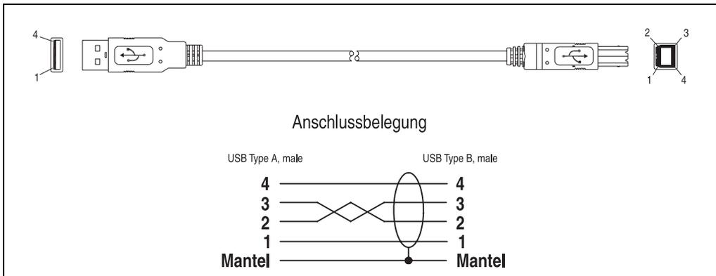
Abbildung 151: USB Kabelbelegung
