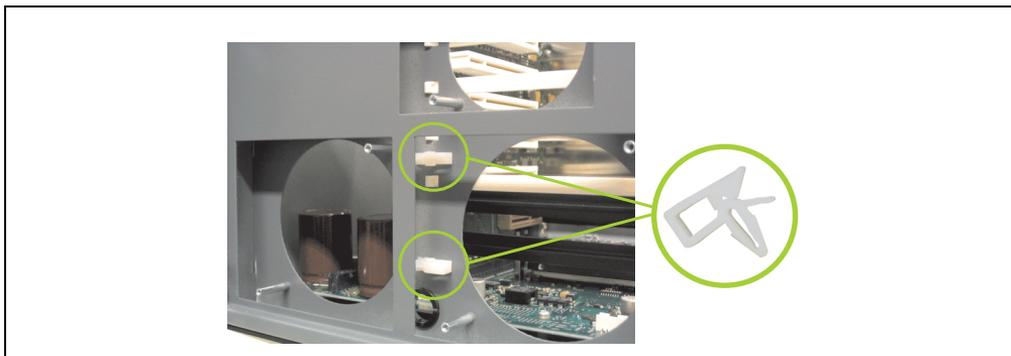
Abbildung 167: APC620 5PCI Kabelbefestigung anbringen
