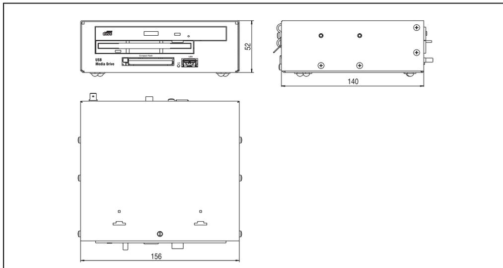
Abbildung 141: Abmessungen 5MD900.USB2-00
