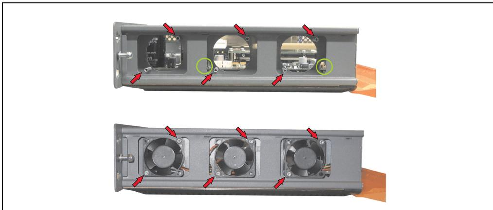
Abbildung 158: APC620 1PCI Slot - Lüftereinbau
