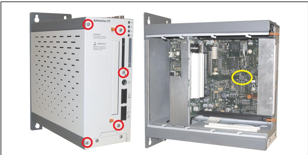
Abbildung 128: Position des DIP Switch Schalters
