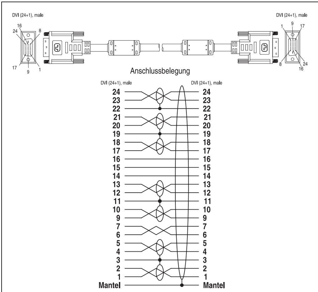
Abbildung 147: SDL Kabelbelegung
