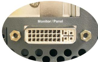
Abbildung 17: Monitor / Panel Anschluss
