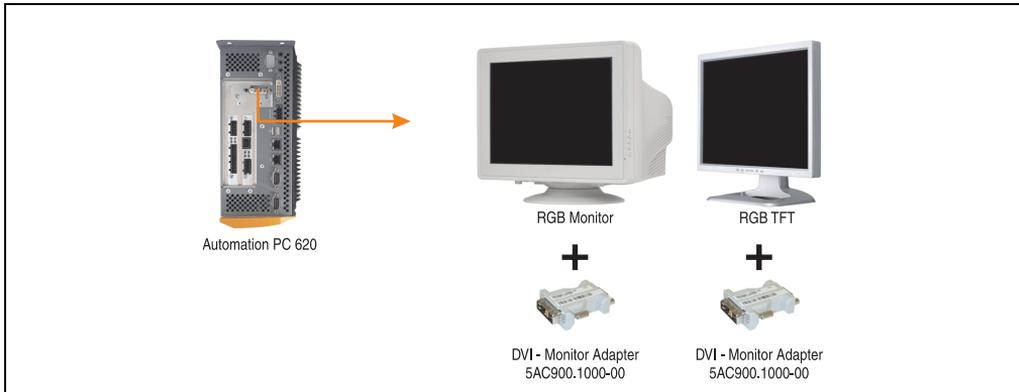
Abbildung 21: Monitor / Panel Geräteanschluss bei RGB Videosignal
