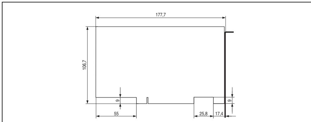
Abbildung 24: Abmessungen Standard Half Size PCI Karte
