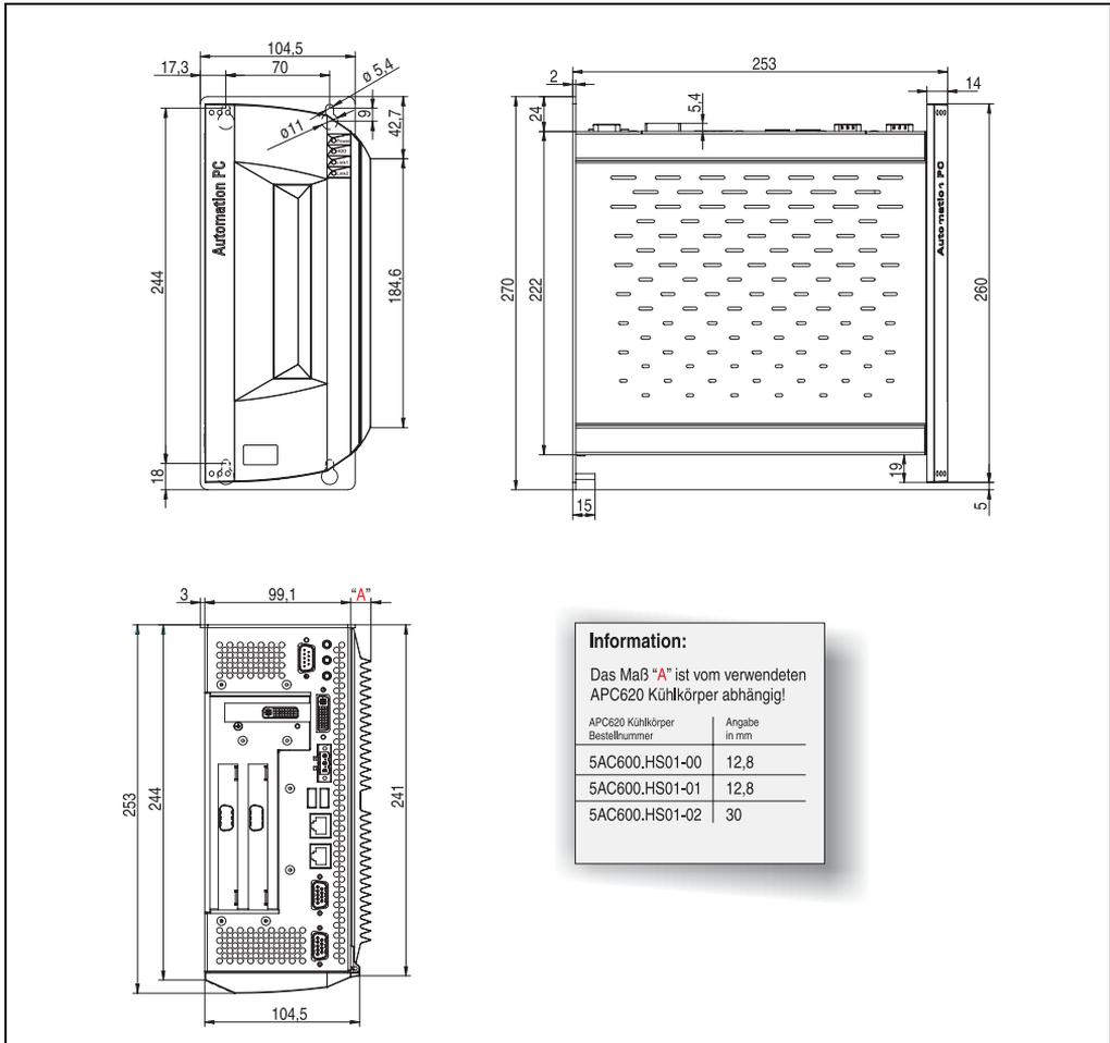
Abbildung 9: APC620 2 PCI Slot Variante Abmessungen
