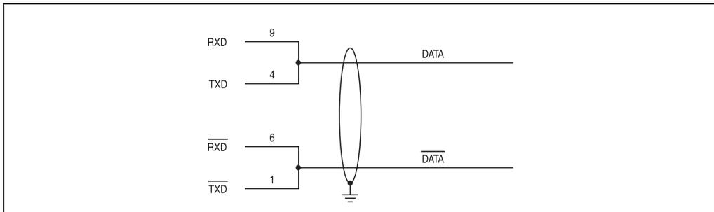
Abbildung 42: Add-On RS232/422/485 Interface - Betrieb im RS485 Modus
