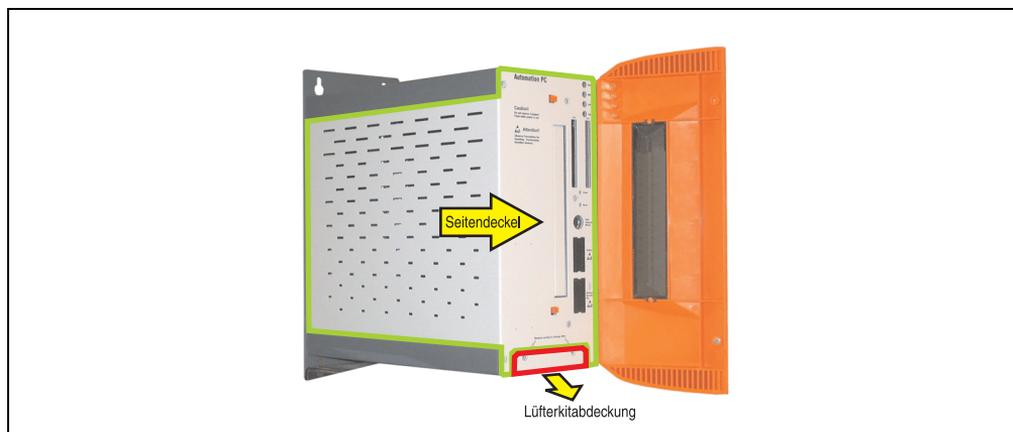
Abbildung 161: APC620 2PCI Slot - Seitendeckel und Lüfterkitabdeckung entfernen
