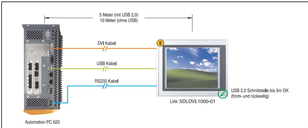
Abbildung 175: Monitor / Panel Anschluss - Automation Panel 900 über DVI
