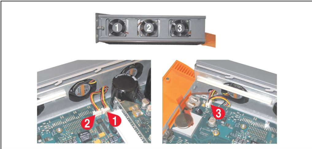
Abbildung 159: APC620 1PCI Slot - Lüfterkabelanschluss auf dem Basisboard
