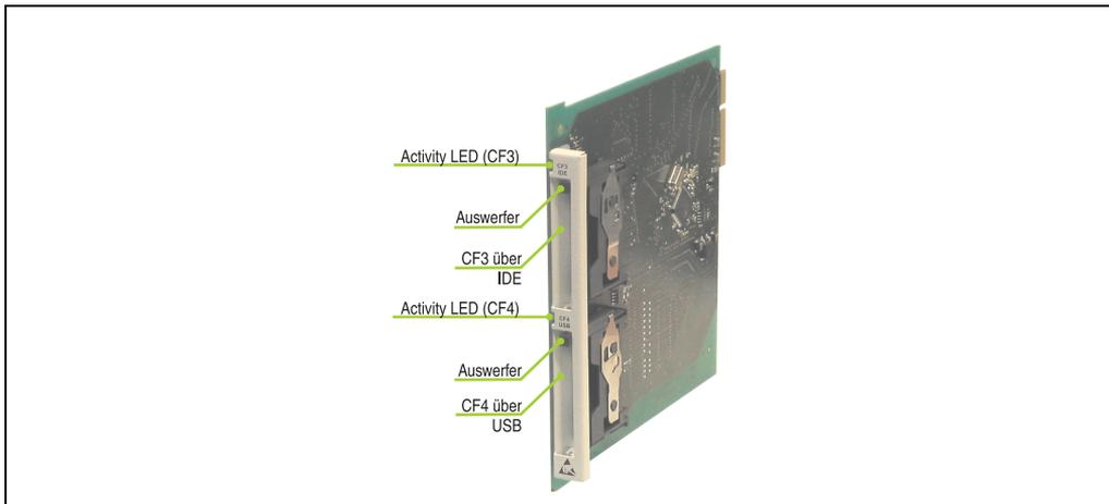
Abbildung 34: Slide-In CF 2 Slot
