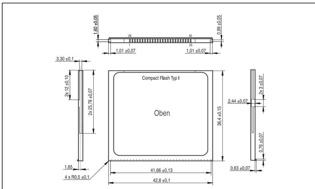
Abbildung 133: Abmessungen Compact Flash Karte Typ I
