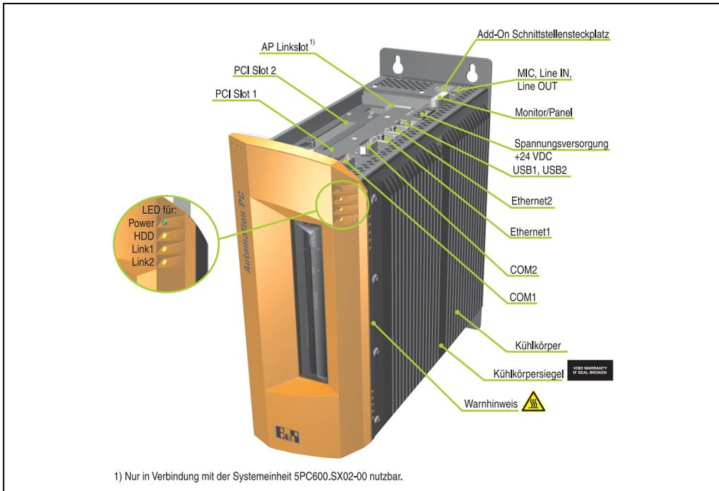
Abbildung 7: APC620 2 PCI Slot Variante Schnittstellenübersicht Oberseite
