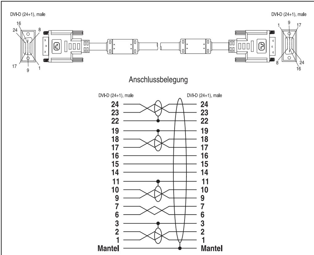
Abbildung 145: DVI Kabelbelegung
