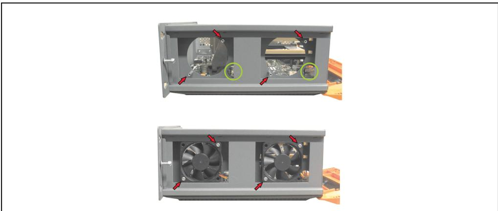
Abbildung 163: APC620 2PCI Slot - Lüftereinbau
