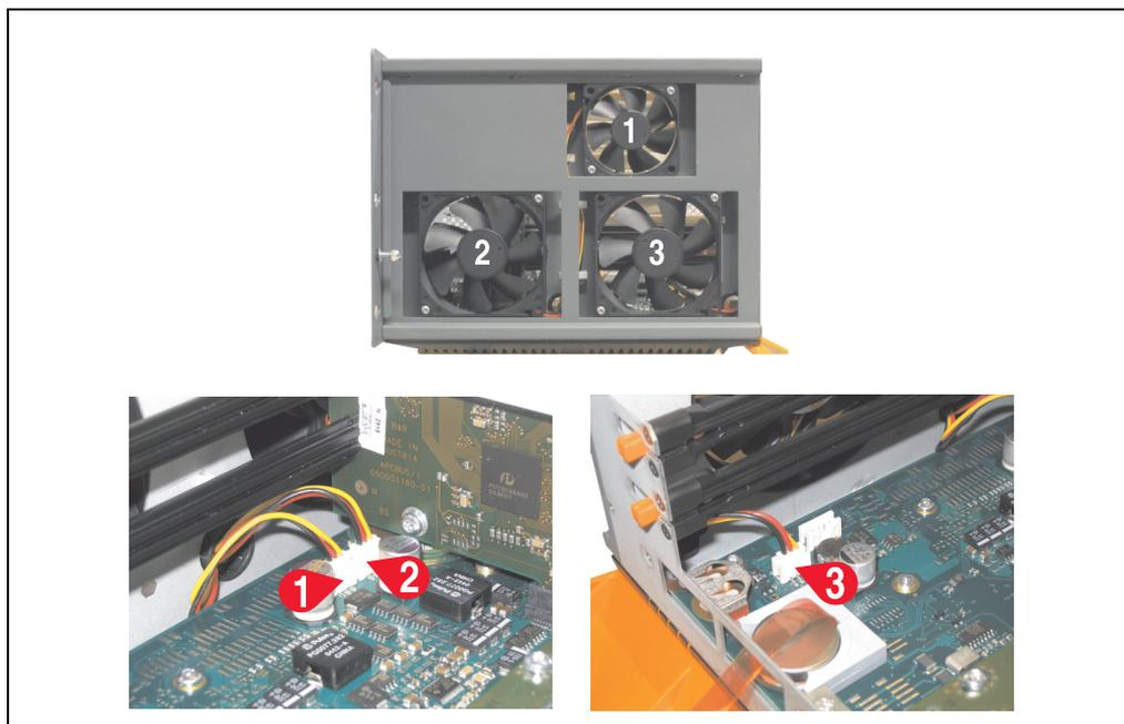
Abbildung 170: APC620 5PCI Slot - Lüfterkabelanschluss auf dem Basisboard
