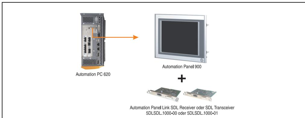
Abbildung 23: Monitor / Panel Geräteanschluss bei SDL Videosignal
