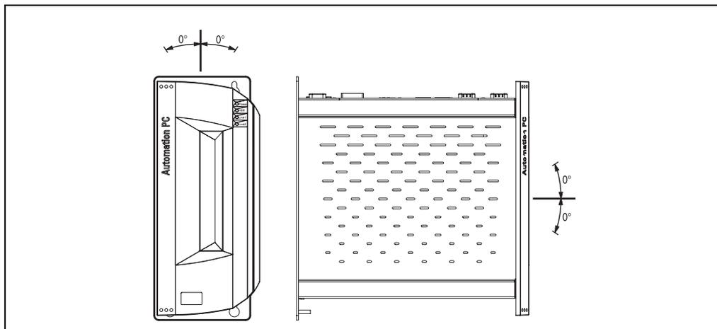
Abbildung 49: Einbaulage - standard
