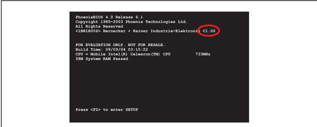
Abbildung 118: Unterscheidung 815E und 855GME CPU Boards
