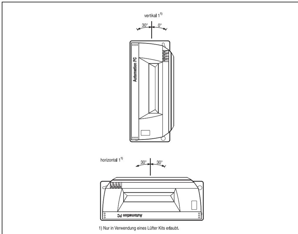
Abbildung 55: Einbaulagen APC620 mit Slide-In DVD-ROM/CD-RW Laufwerk
