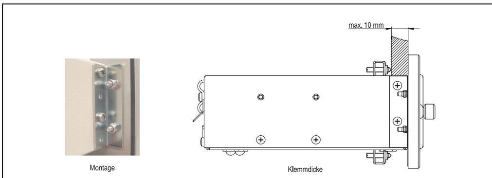
Abbildung 131: Frontklappenmontage und Klemmdicke
