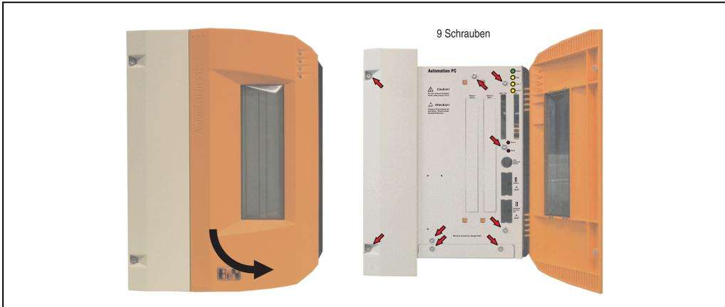
Abbildung 165: APC620 5PCI Slot - Schrauben für den Filterkit Ein- und Ausbau lösen
