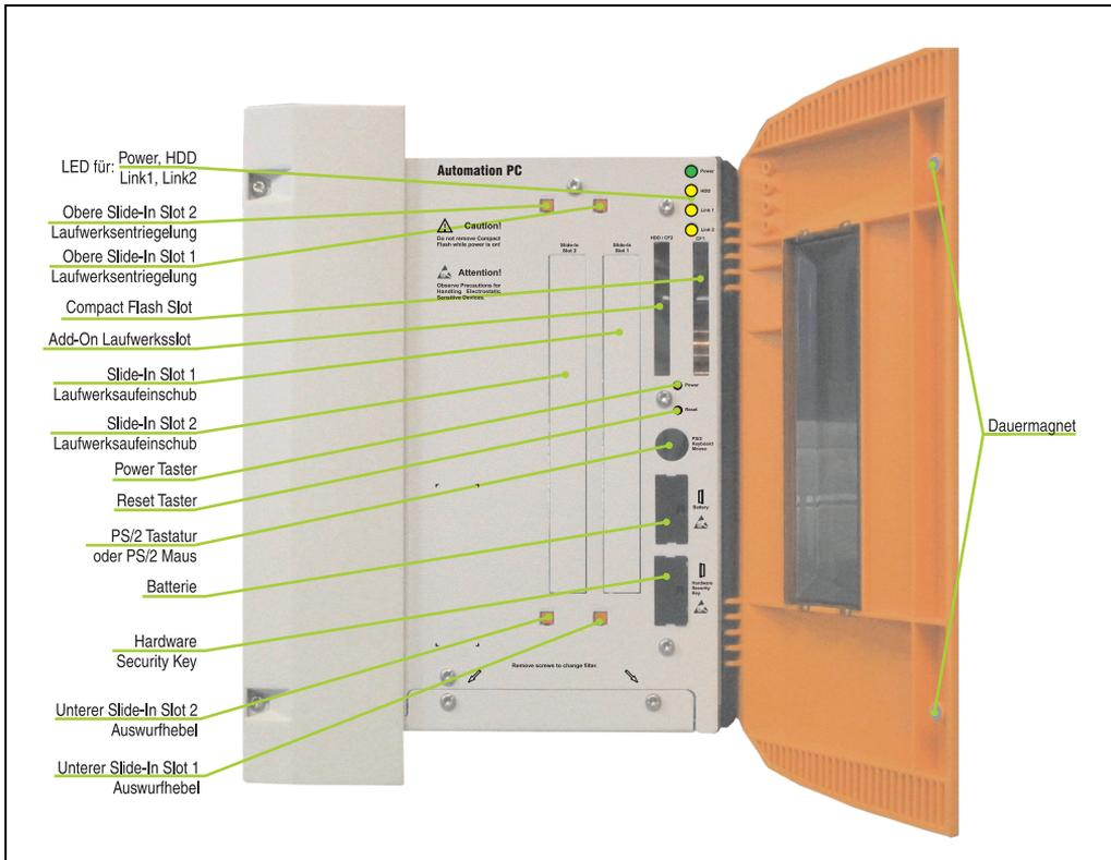
Abbildung 11: APC620 5 PCI Slot Variante Schnittstellenübersicht Vorderseite
