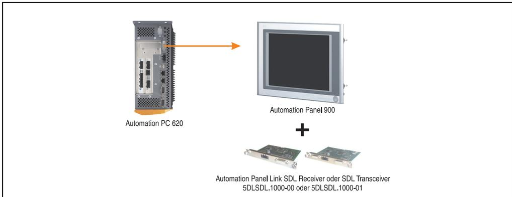
Abbildung 20: Monitor / Panel Geräteanschluss bei SDL Videosignal
