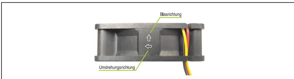
Abbildung 168: Lüftermarkierungen für Blas- und Umdrehungsrichtung
