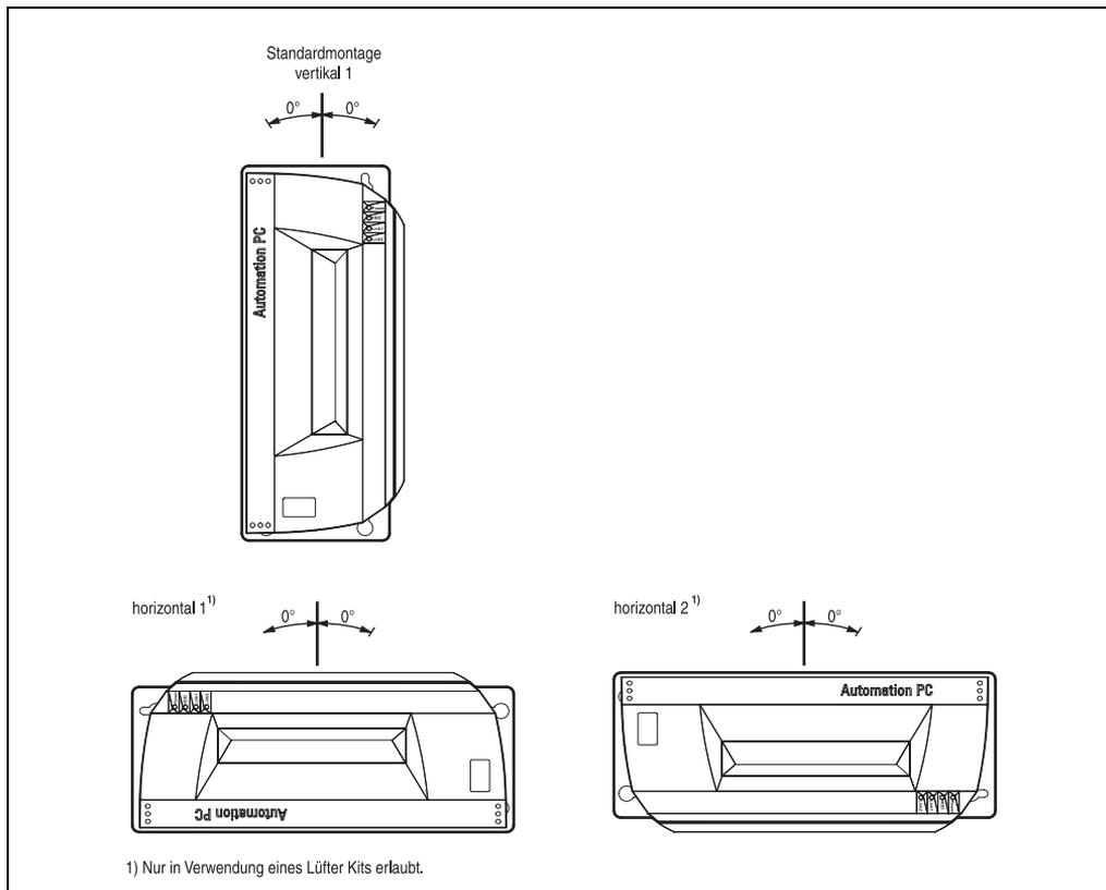
Abbildung 53: Einbautagen APC620 mit Hard Disk Laufwerk
