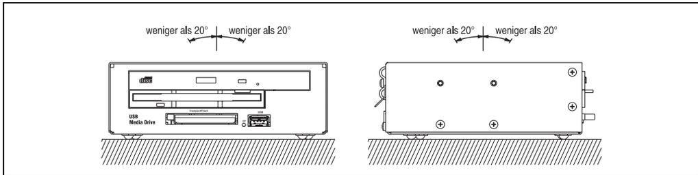
Abbildung 143: Einbaulage 5MD900.USB2-00
