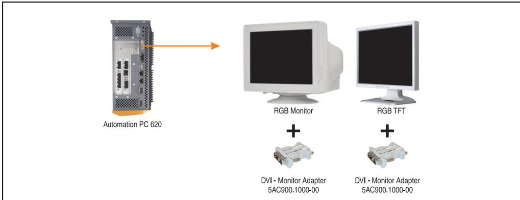
Abbildung 18: Monitor / Panel Geräteanschluss bei RGB Videosignal
