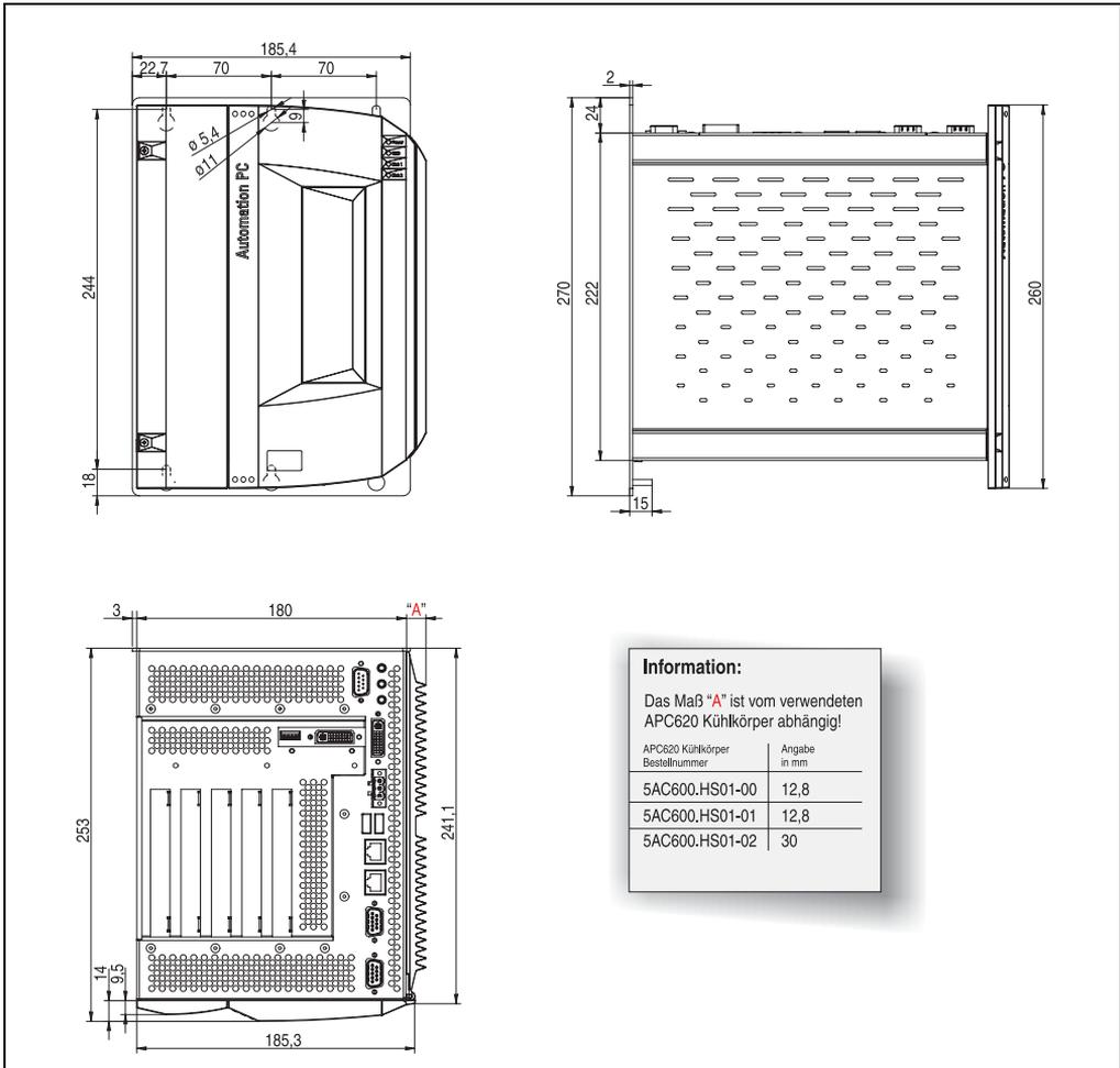
Abbildung 12: APC620 5 PCI Slot Variante Abmessungen
