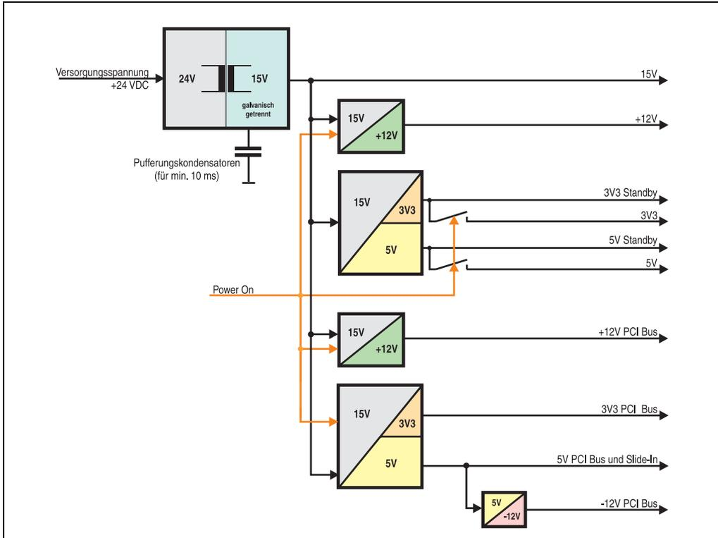
Abbildung 14: Blockschaltbild Spannungsversorgung
