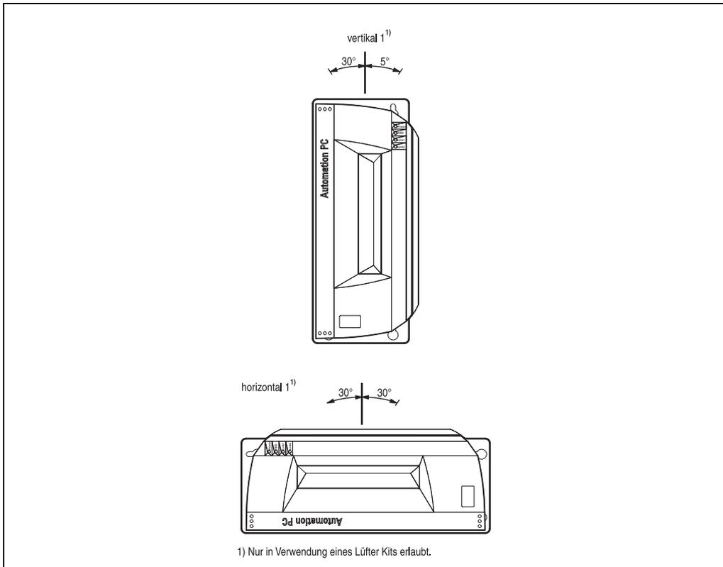
Abbildung 54: Einbaulagen APC620 mit Slide-In CD-ROM Laufwerk
