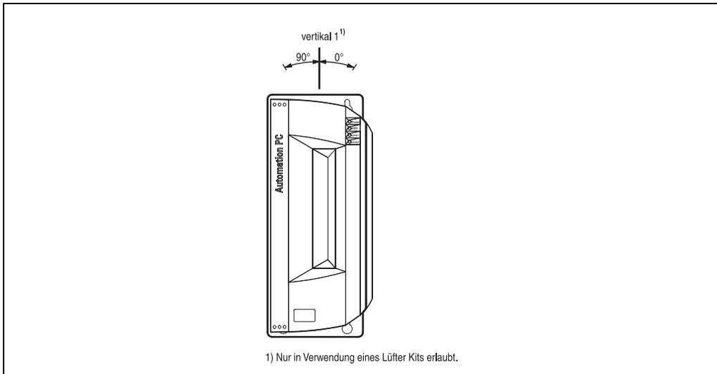
Abbildung 56: Einbaulagen APC620 mit Slide-In USB FDD Laufwerk
