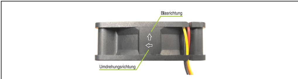
Abbildung 162: Lüftermarkierungen für Blas- und Umdrehungsrichtung
