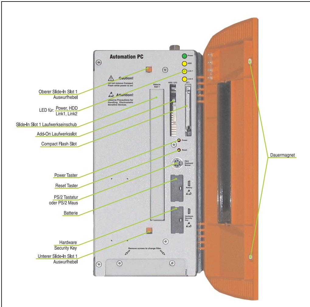
Abbildung 8: APC620 2 PCI Slot Variante Schnittstellenübersicht Vorderseite
