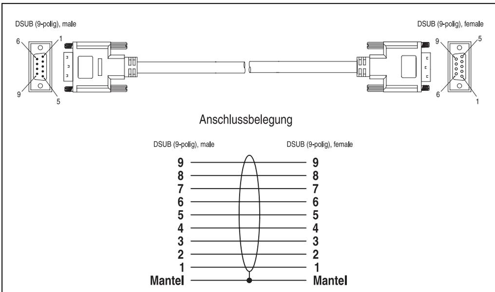
Abbildung 149: RS232 Kabelbelegung
