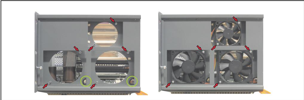
Abbildung 169: APC620 5PCI Slot - Lüftereinbau
