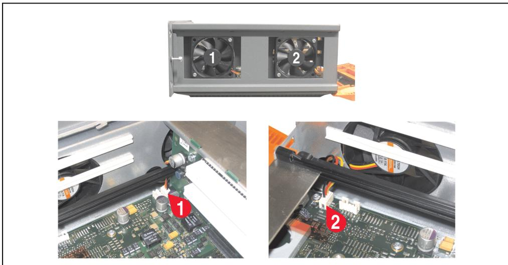
Abbildung 164: APC620 2PCI Slot - Lüfterkabelanschluss auf dem Basisboard
