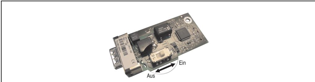
Abbildung 40: Abschlusswiderstand Add-On CAN Interface 5AC600.CANI-00
