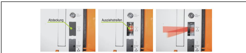
Abbildung 152: Batterie herausziehen
