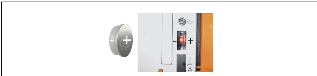
Abbildung 154: Batteriepolareität
