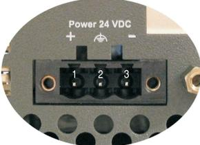
Abbildung 15: Spannungsversorgungsanschluss
