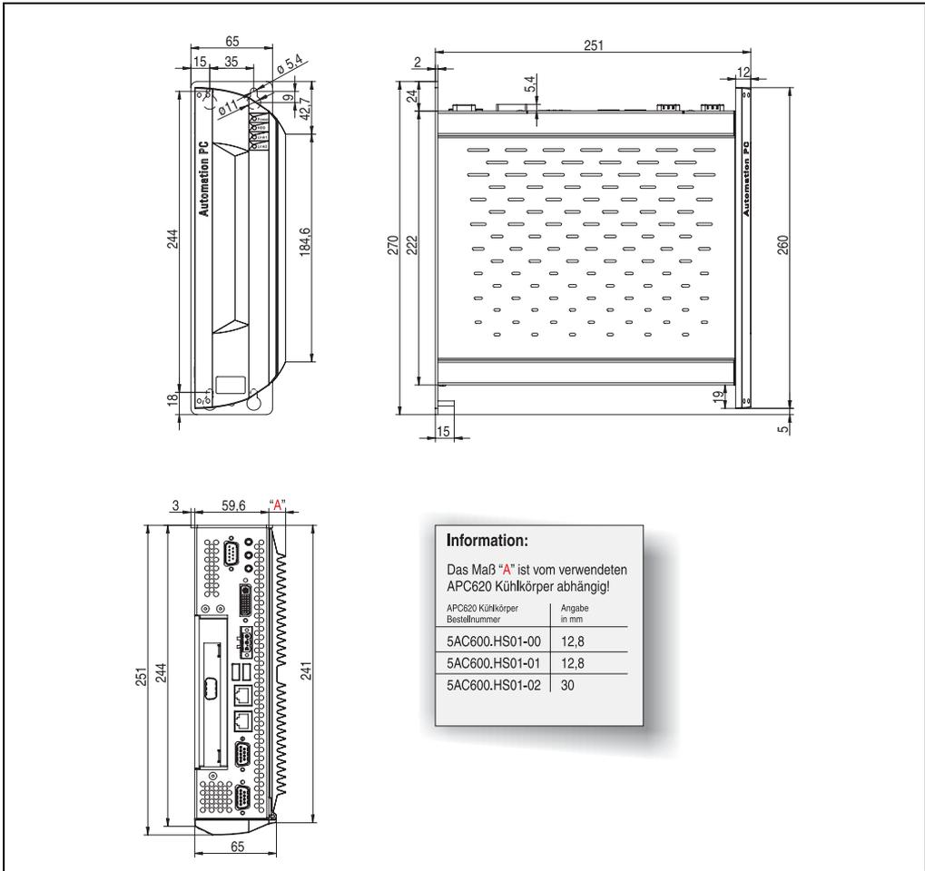
Abbildung 6: APC620 1PCI Slot Variante Abmessungen
