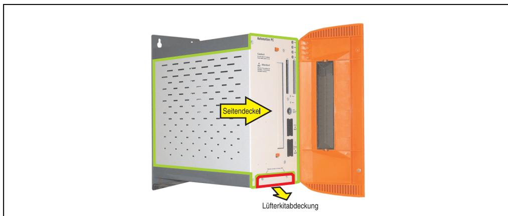
Abbildung 129: APC620 2PCI Slot - Seitendeckel und Lüfterkitabdeckung entfernen
