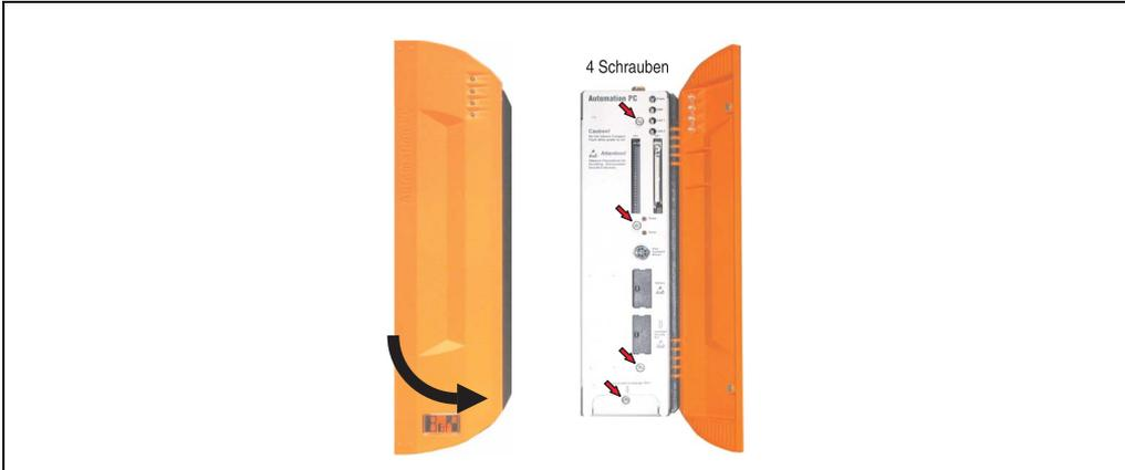
Abbildung 123: APC620 1PCI Slot - Schrauben für den Filterkit Ein- und Ausbau lösen
