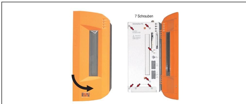
Abbildung 128: APC620 2PCI Slot - Schrauben für den Filterkit Ein- und Ausbau lösen
