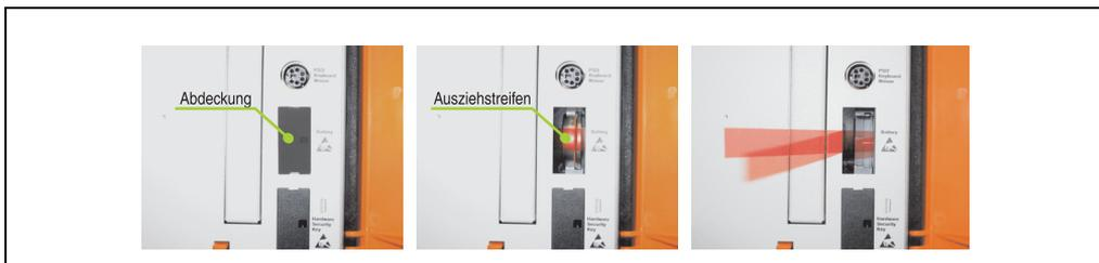
Abbildung 120: Batterie herausziehen
