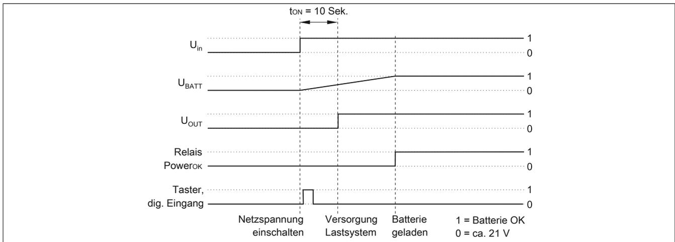
Abbildung 66: Einschalten der USV, Batterie leer (mit Taster)
