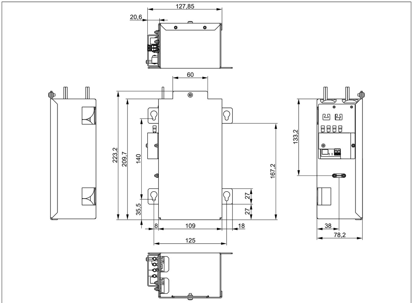
Abbildung 15: 9A0100.16 ≥ Rev. D0 - Abmessungen
