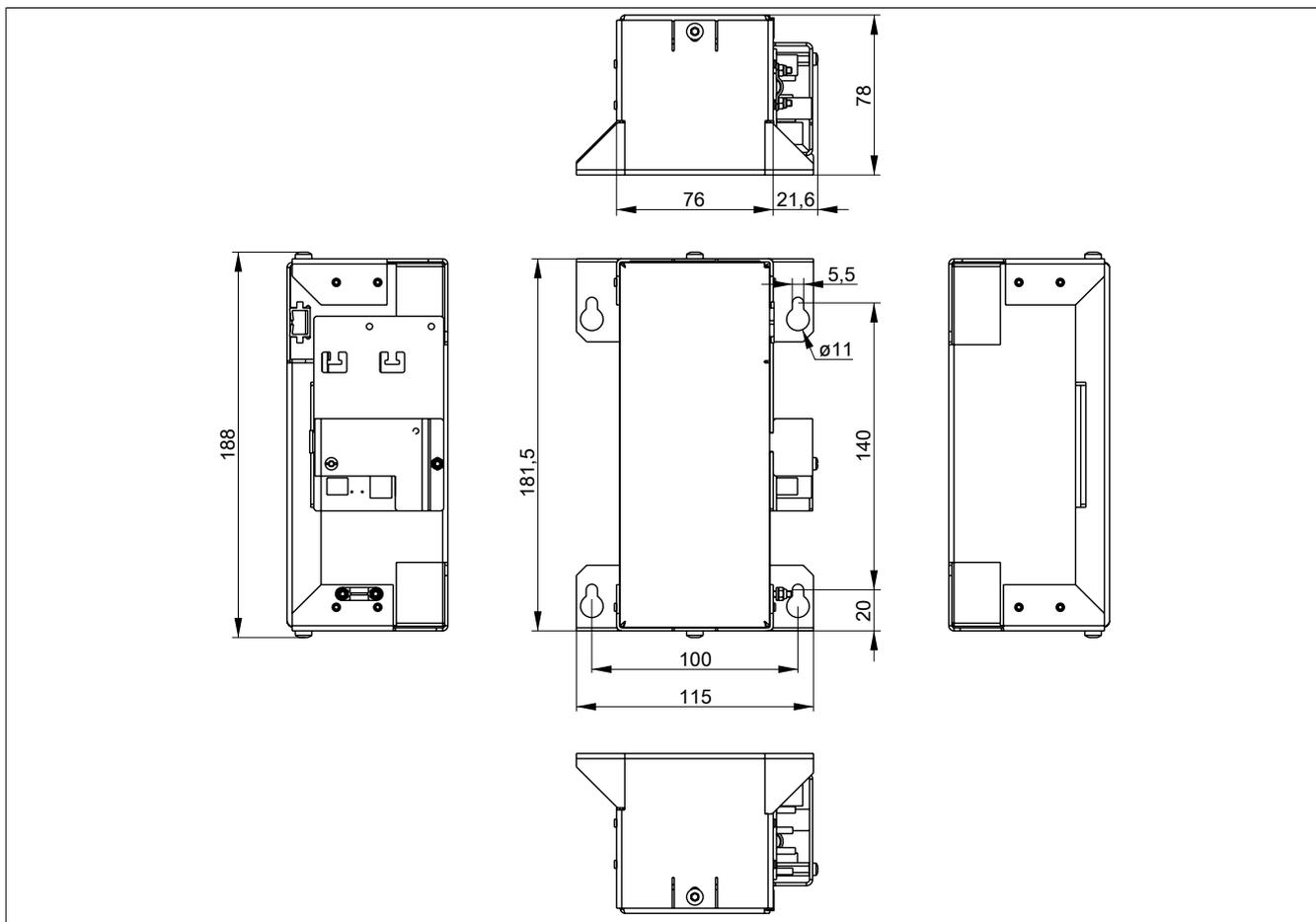
Abbildung 11: 9A0100.14  $\geq$  Rev. F0 - Abmessungen
