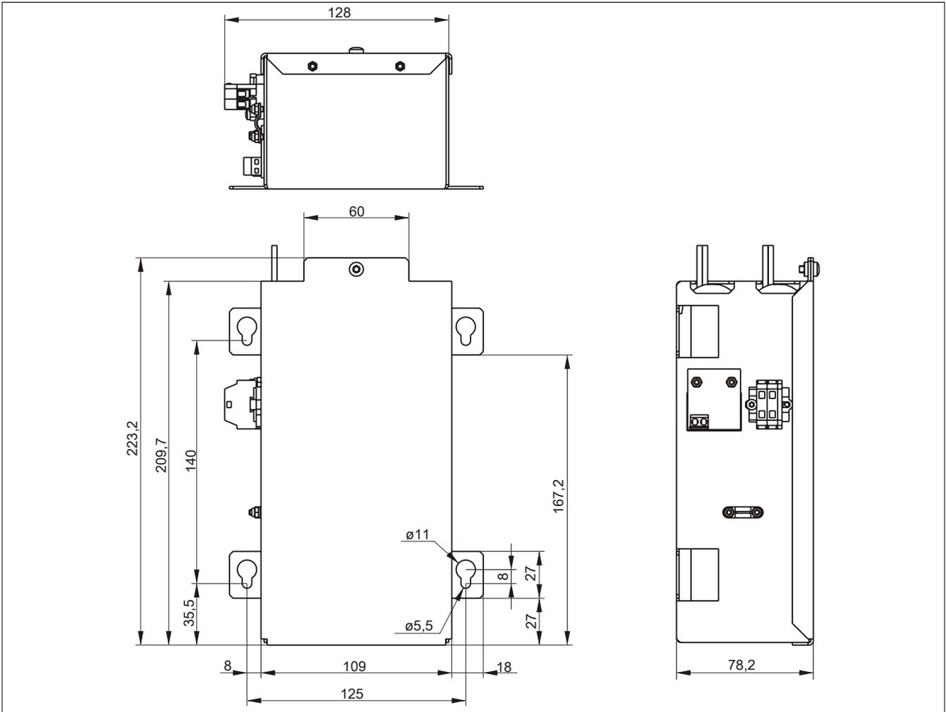
Abbildung 16: 9A0100.16 ≤ Rev. C0 - Abmessungen
