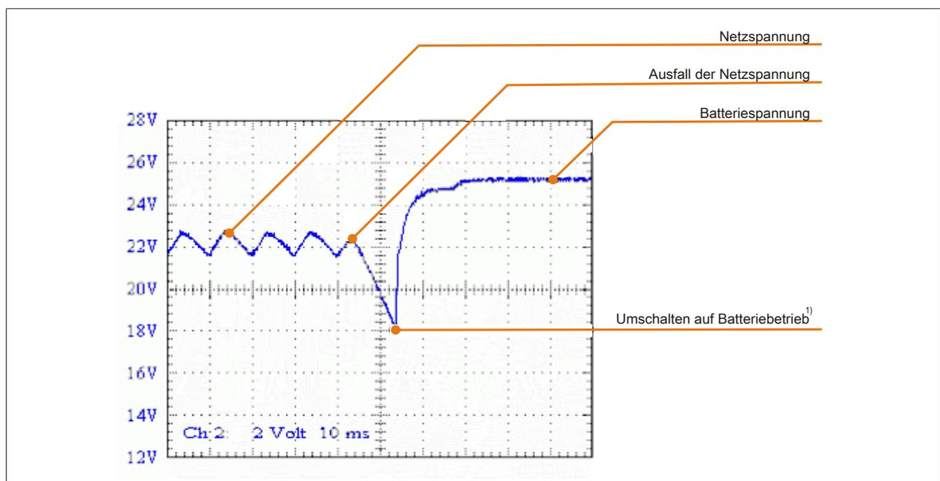
Abbildung 62: Verhalten bei Ausfall der Netzspannung
