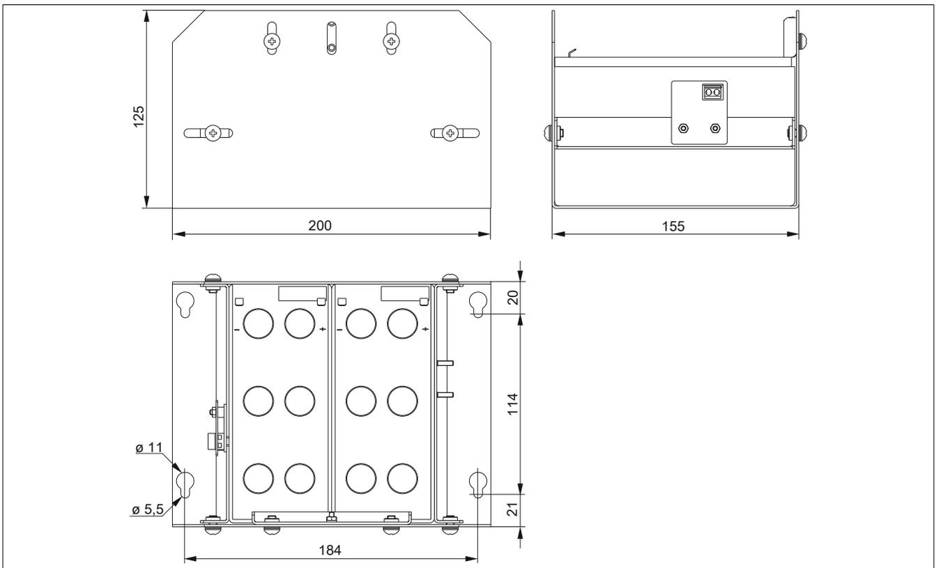
Abbildung 9: 9A0100.12  $\leq$  Rev. D0 - Abmessungen
