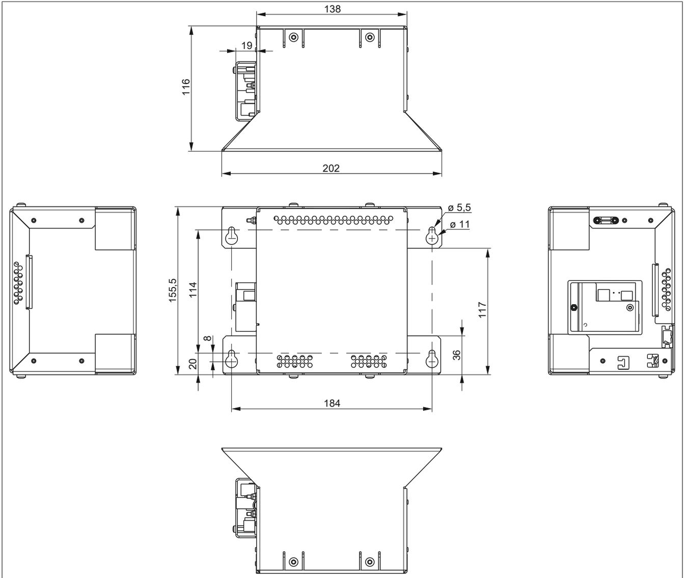
Abbildung 7: 9A0100.12 ≥ Rev. G0 - Abmessungen
