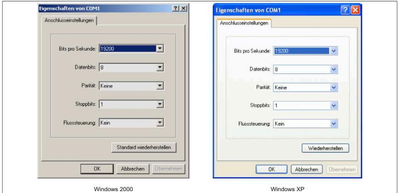
Abbildung 61: Beispiel - Hyperterminalkonfiguration Windows 2000 / XP für COM1
