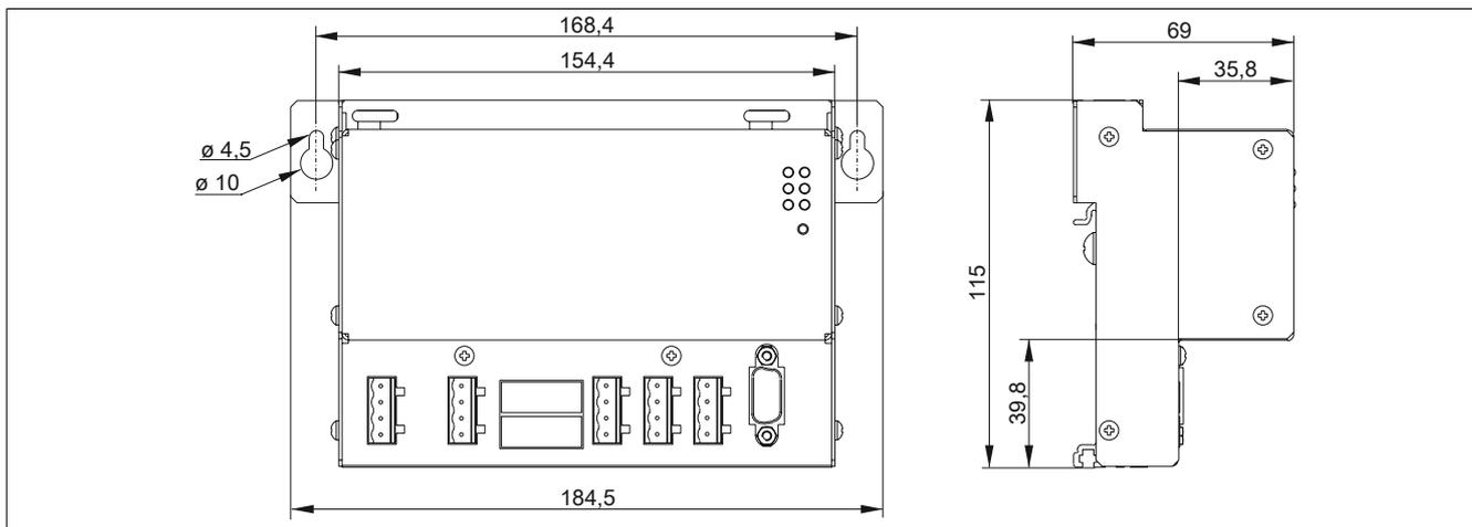
Abbildung 3: 9A0100.11 - Abmessungen
