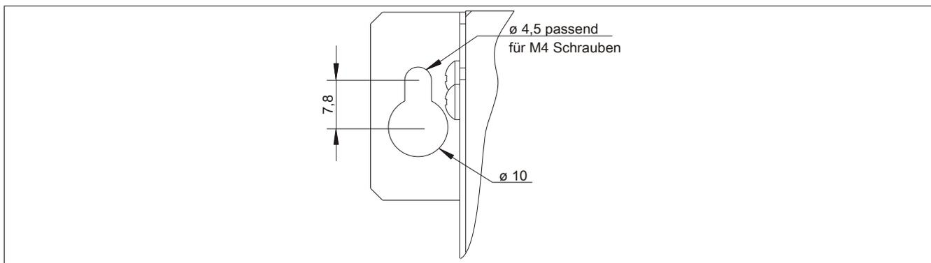
Abbildung 20: Befestigungslasche USV Ladeinheit
