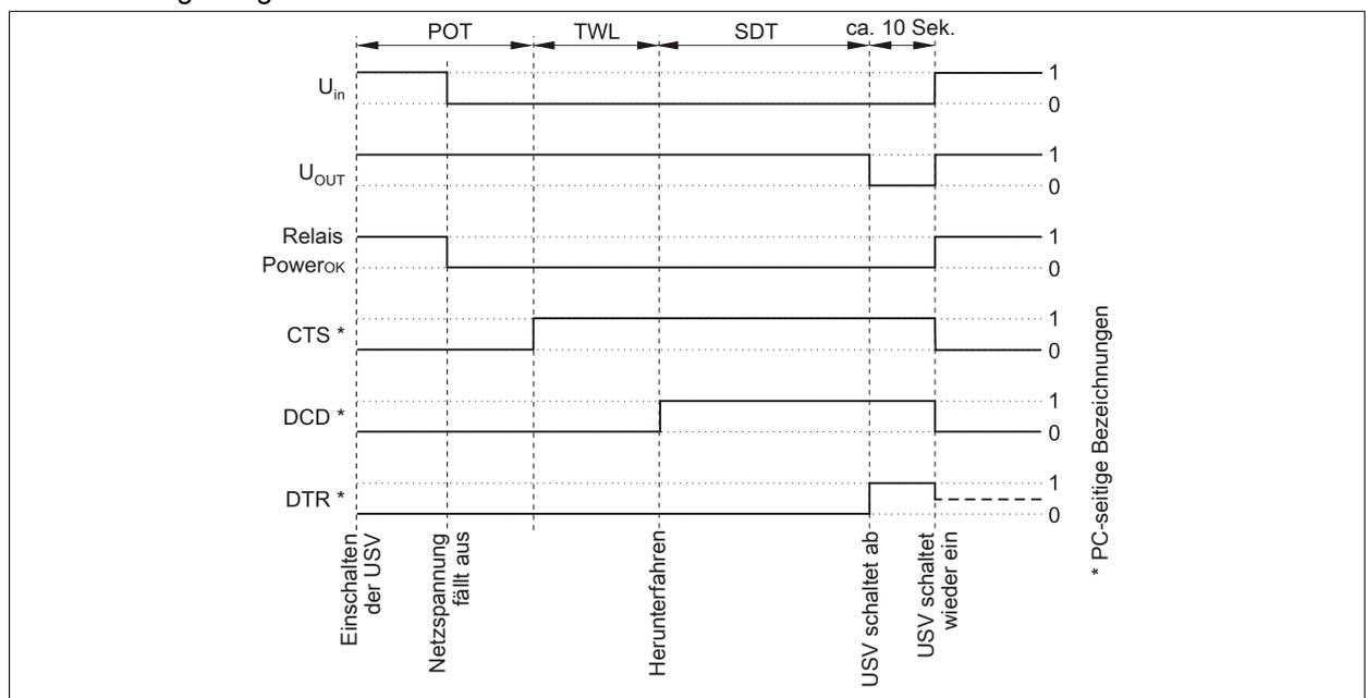
Abbildung 70: Handshakeleitungen bei Netzausfall während POT
