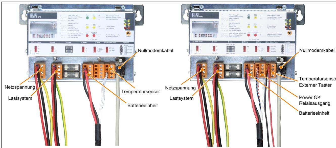
Abbildung 21: Kabelanschlussbeispiele
