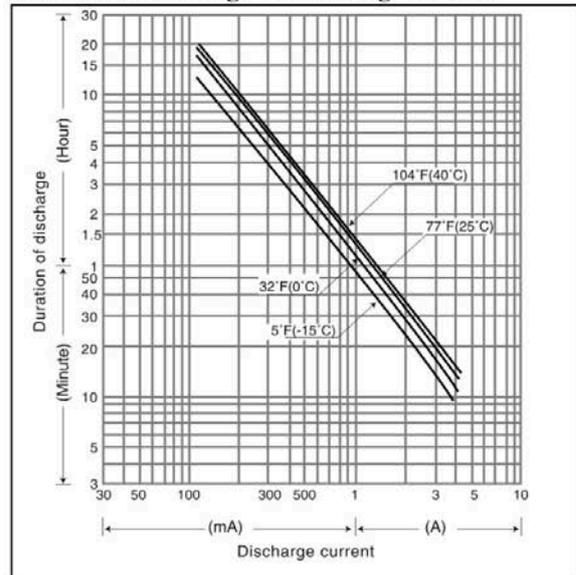
Abbildung 75: Datenblatt Panasonic Batterie LC-R122R2P
