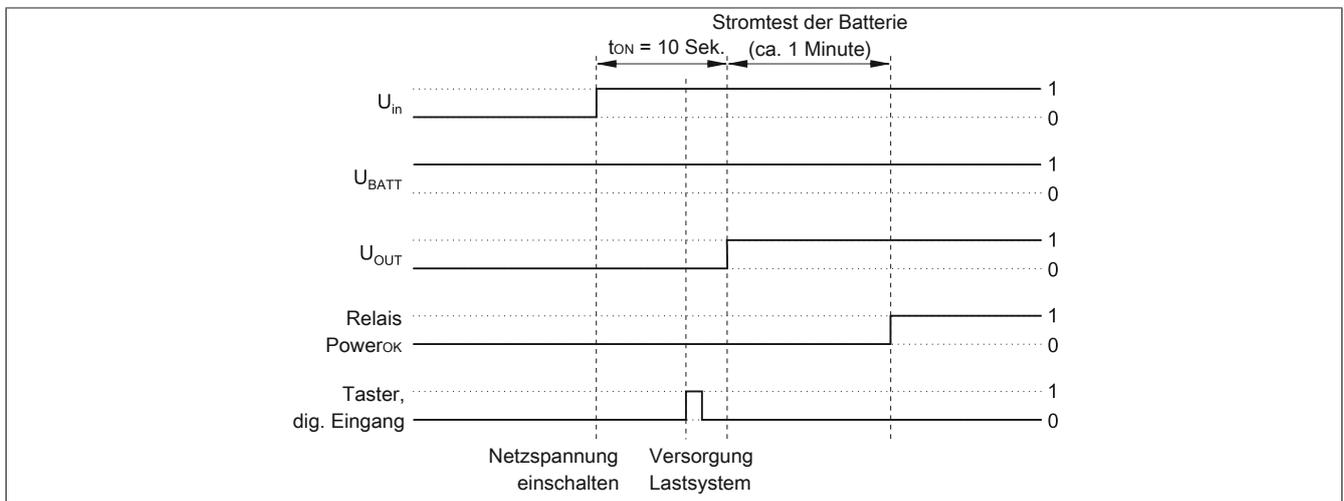
Abbildung 64: Einschalten der USV, Batterie OK (mit Taster)
