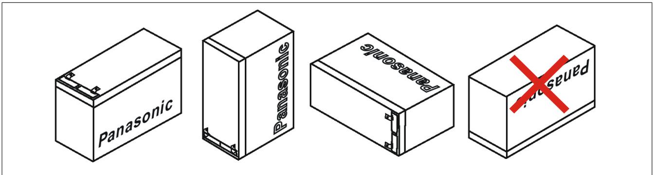
Abbildung 28: Montagearten der Blei-Gel Batterieeinheiten im Betrieb
