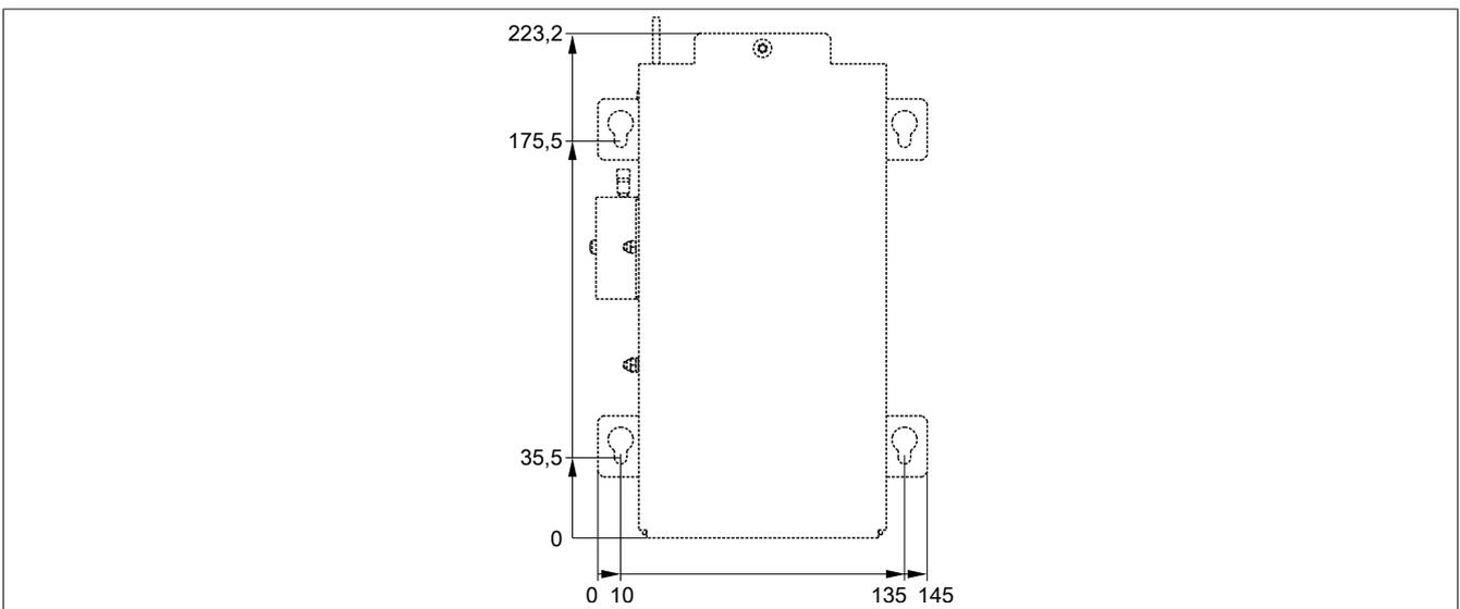
Abbildung 17: 9A0100.16 ≥ Rev. D0 - Bohrschablone
