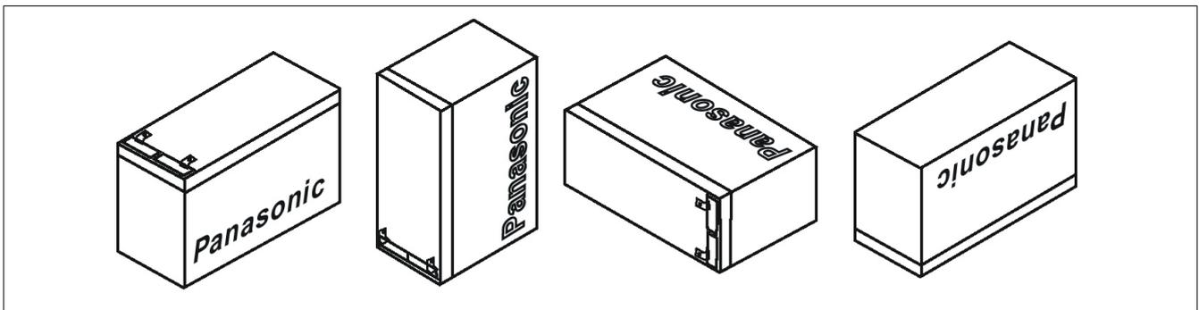
Abbildung 29: Montagearten der Blei-Gel Batterieeinheiten bei Lagerung
