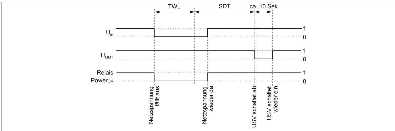
Abbildung 71: Handshakeleitungen bei Netzausfall ohne RS232-Kabel
