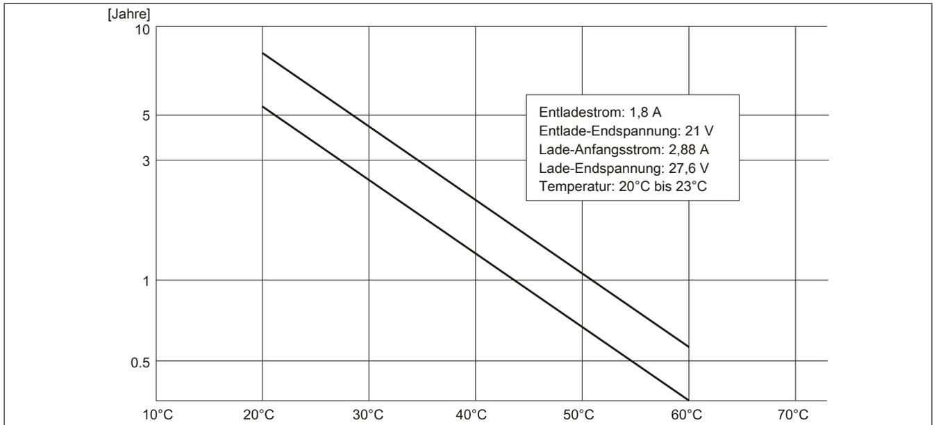
Abbildung 74: Temperatureinfluss auf die Lebensdauer der Akkumulatoren
