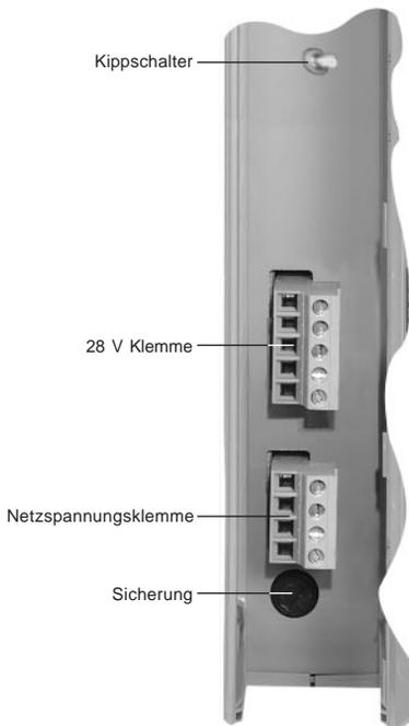
Mit dem **Kippschalter** kann die erzeugte Sekundärspannung (28 V) wahlweise auf den I/O-Bus (RPS-System) oder auf die 28 V Klemme geschaltet werden. Somit ist es möglich, mit diesem Netzteil externe I/O-Komponenten zu versorgen:
