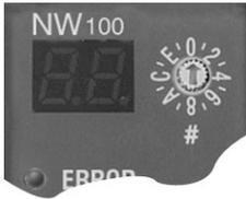
Mit dem Nummernschalter wird die Moduladresse des Netzwerkmoduls, das sich auf dem Systembus befindet, eingestellt. Die Moduladresse wird auf dem 7-Segment-Display angezeigt. Es ist darauf zu achten, daß kein
