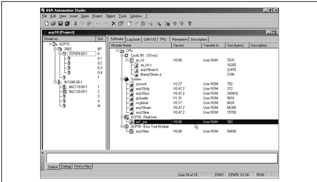
Figure 46: Open initial parameter module AX1\_PAR
