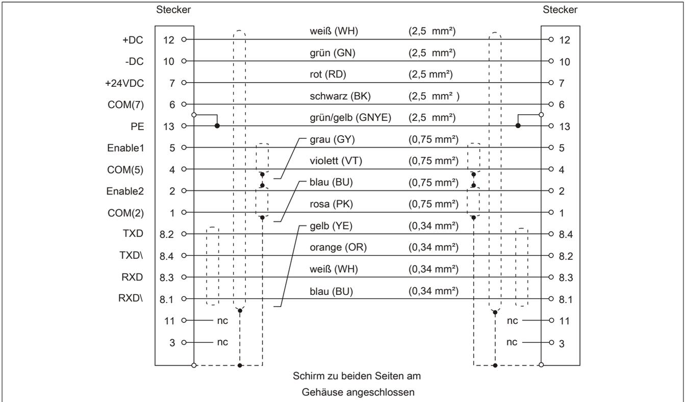
Abbildung 1: Kabelplan Hybridkabel
