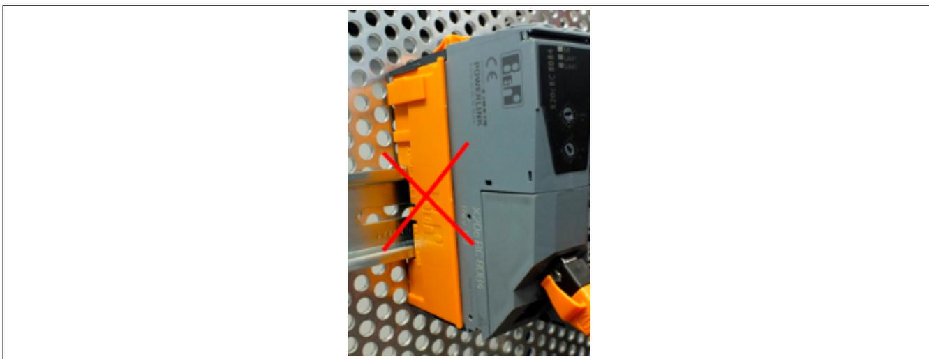
Abbildung 6: X20 System - Abschlussplatten entfernen
