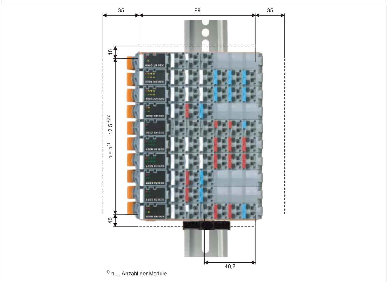
Für eine optimale Kühlung und Luftzirkulation muss links der Module ein mindestens 35 mm breiter freier Raum sein. Ober- und unterhalb des X20 Systems ist ein Freiraum von 10 mm einzuhalten. Rechts der Module ist für die Kabelführung der Ein- und Ausgänge und der Versorgung ein Raum von 35 mm vorzusehen.
