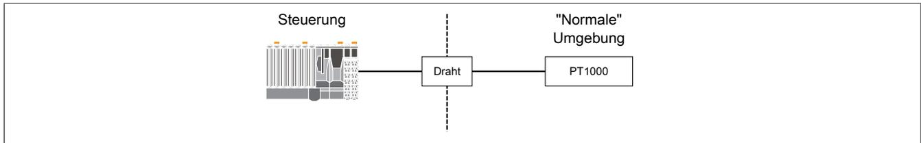
Ein für diese Methode oft verwendeter Messwiderstand ist der PT1000. Im Temperaturbereich von etwa  $-200^{\circ}\text{C}$  bis  $850^{\circ}\text{C}$  lässt sich durch Messung des elektrischen Widerstandes die absolute Temperatur am Messpunkt ermitteln.
