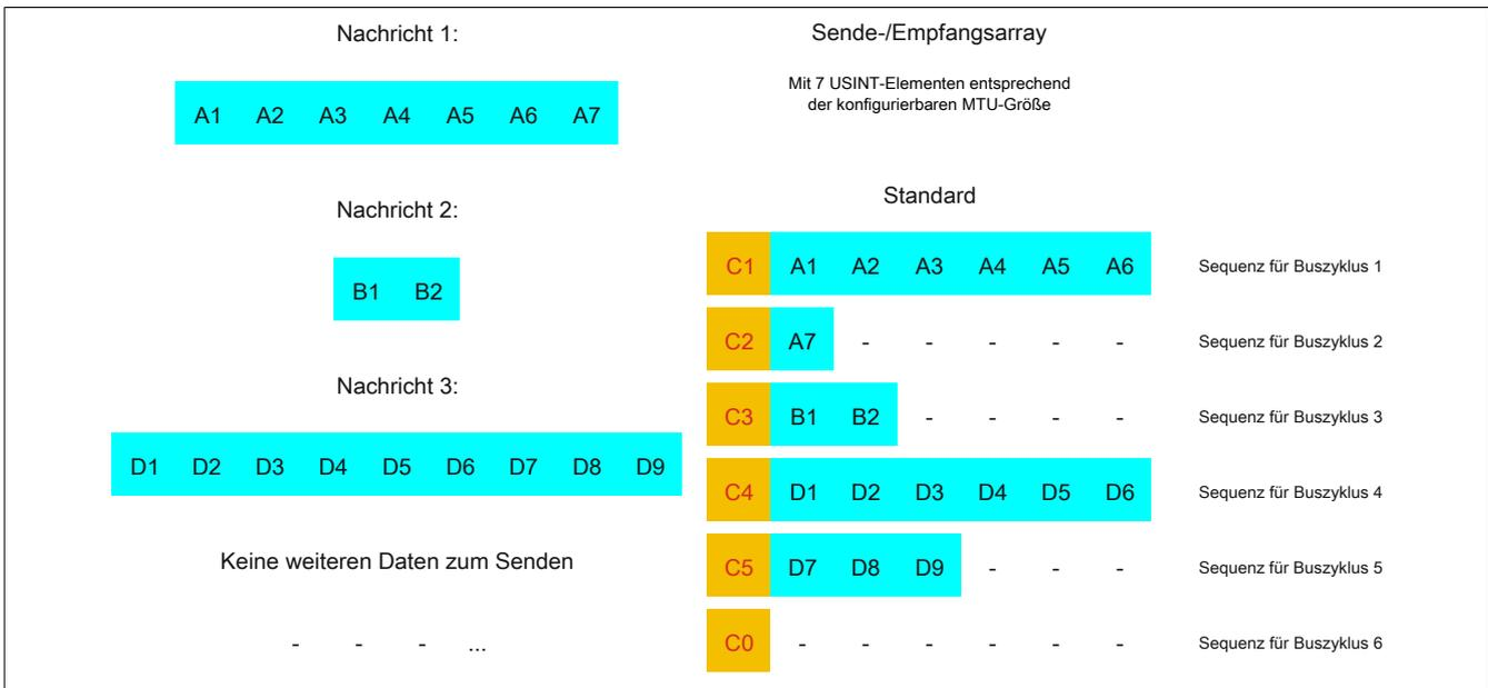
Abbildung 39: Sende-/Empfangsarray (Standard)
