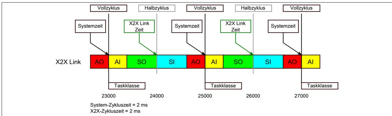
Der Referenzzeitpunkt am X2X Link wird grundsätzlich zum Halbzyklus des X2X Link Zyklus gebildet. Dadurch ergibt sich beim Auslesen des Referenzzeitpunktes eine Differenz zwischen Systemzeit und X2X Link Referenzzeit.
