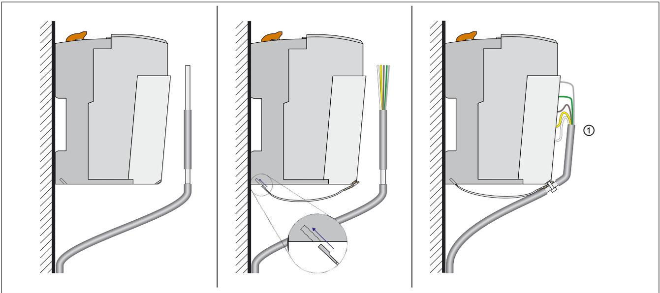
Abbildung 7: Schirmung mittels X20 Auflage für Kabelschirm
