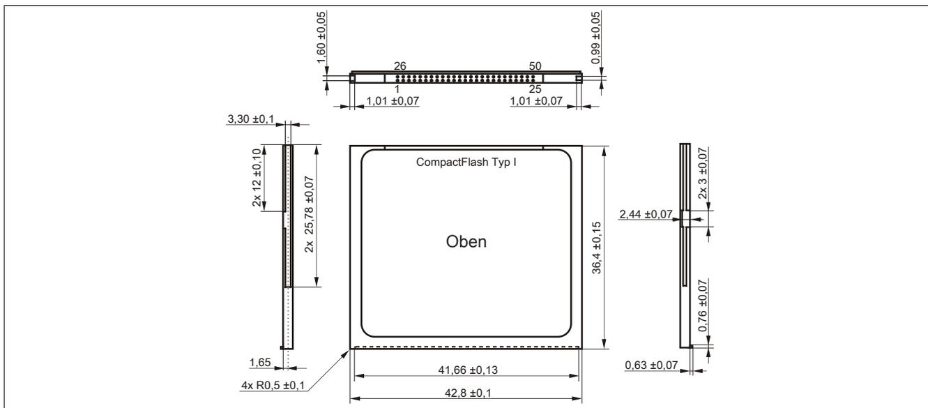
Abbildung 34: Abmessungen CompactFlash-Karte Typ I
