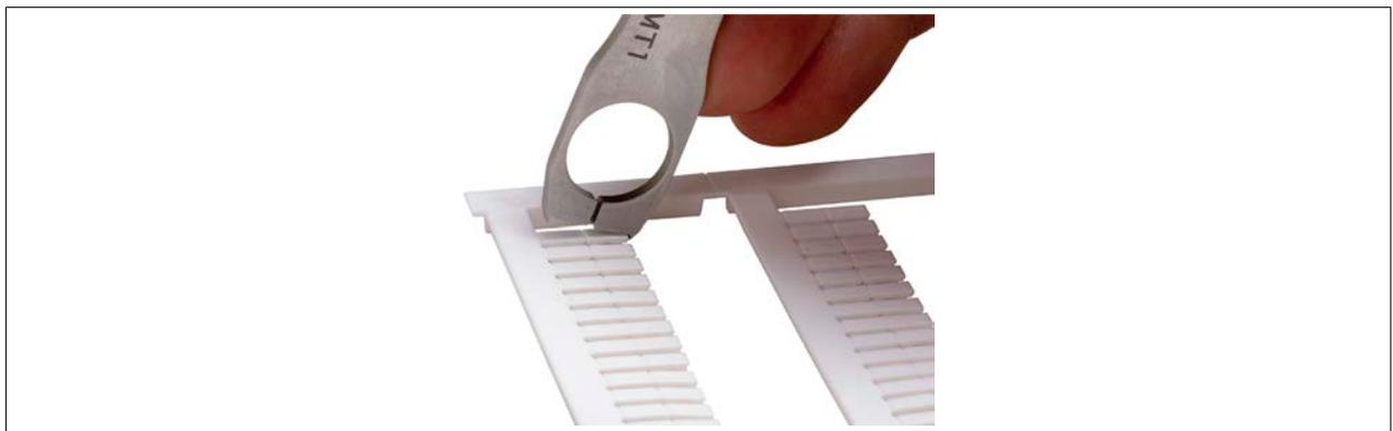
2. Durch Druck auf das Beschriftungshilfswerkzeug die Bezeichnungsschilder abtrennen.
