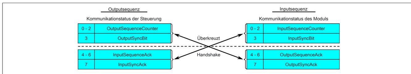
Abbildung 38: Zusammenhang zwischen Output- und InputSequence
