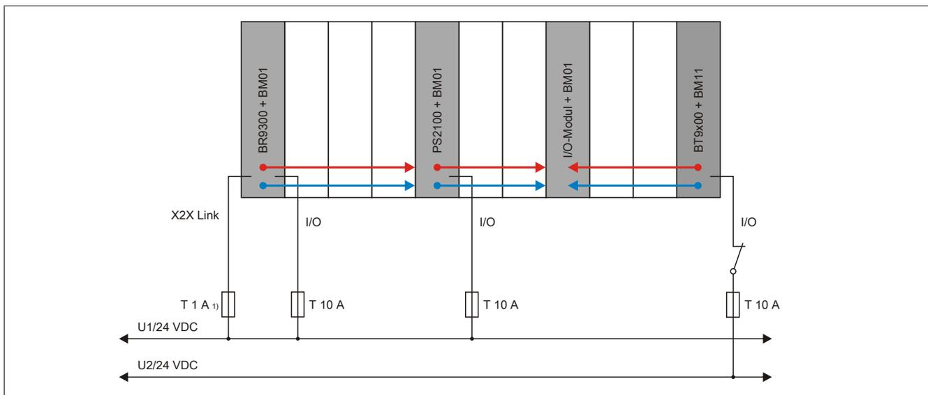
Abbildung 19: Absicherung bei Einspeisung über Bussender
