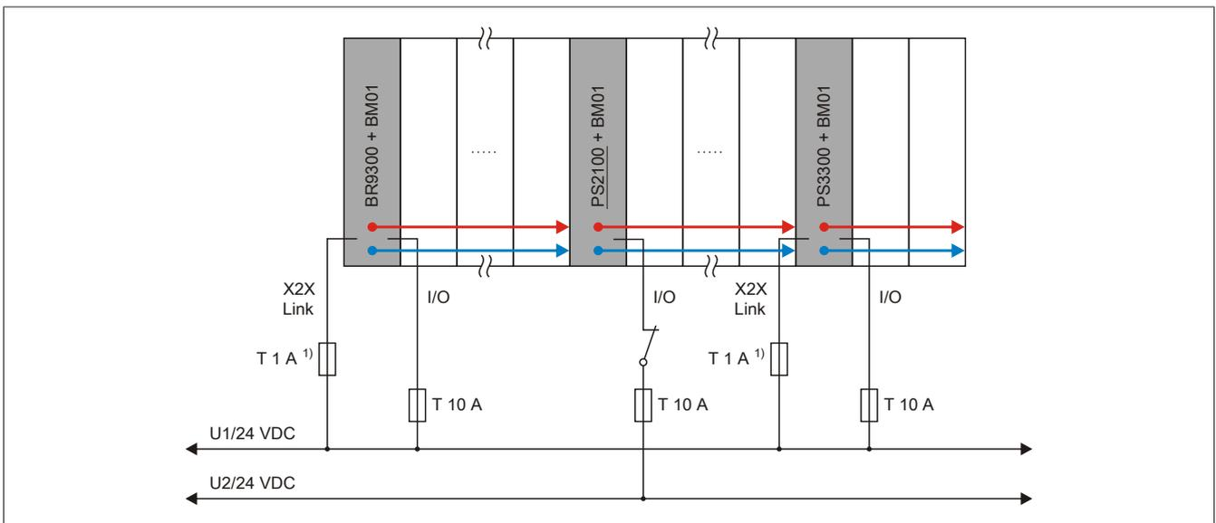
Abbildung 16: Beispiel für erweiterte X2X Link Versorgung
