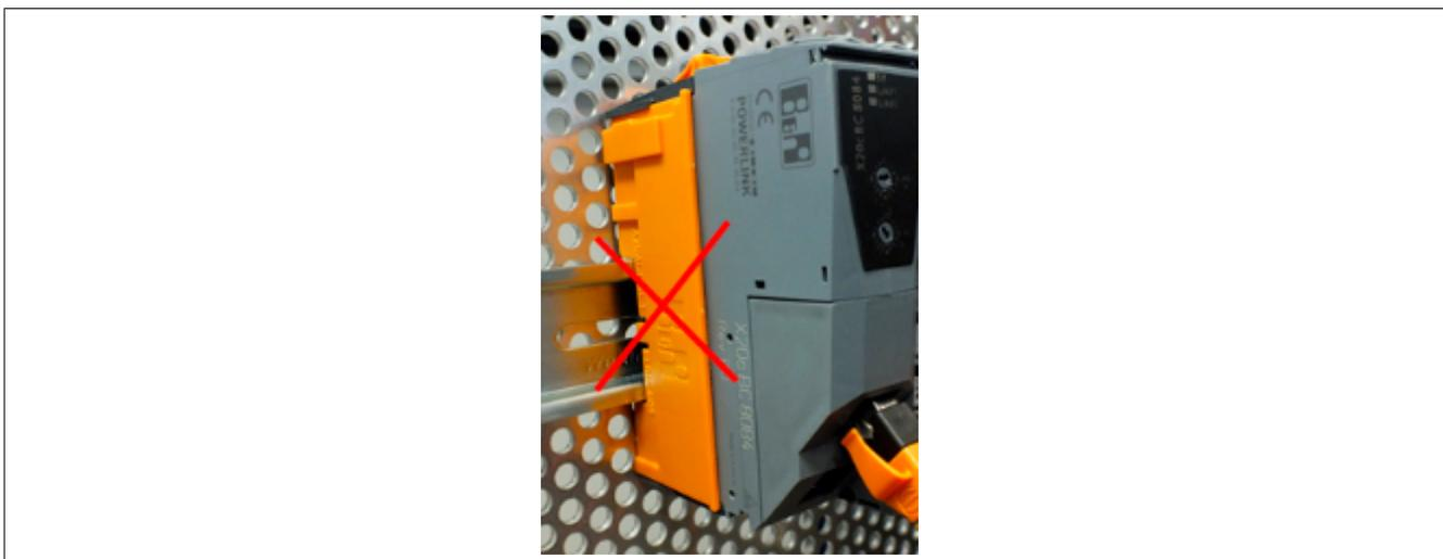
Abbildung 3: X20 System - Abschlussplatten entfernen
