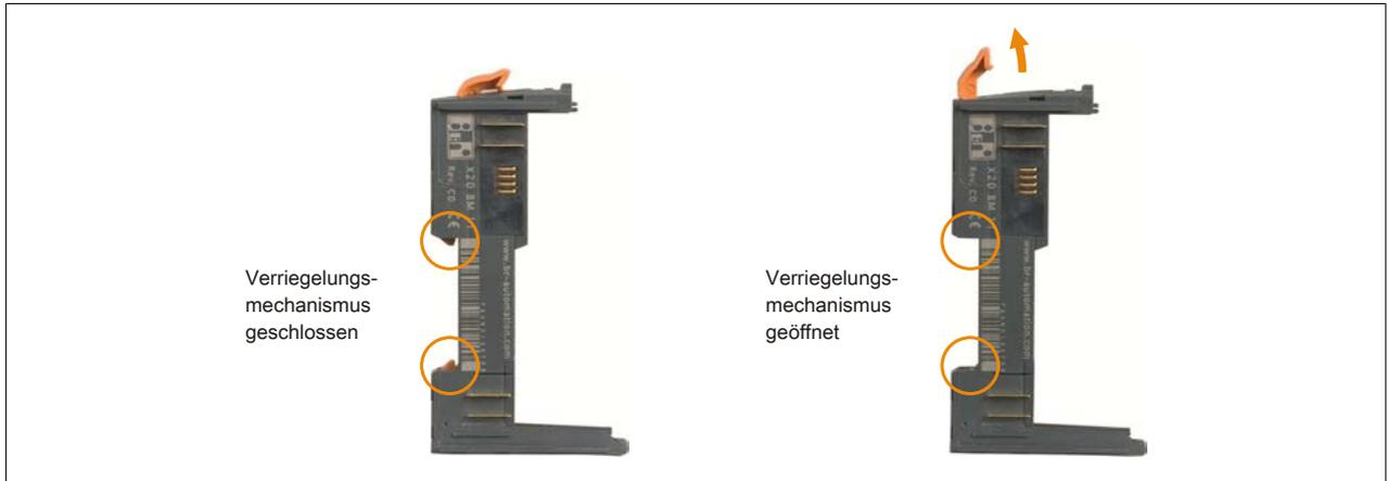
3. Erstes Busmodul an der gewünschten Position in die Hutschiene einhängen und durch Herunterdrücken des Verriegelungshebels den Verriegelungsmechanismus schließen.
