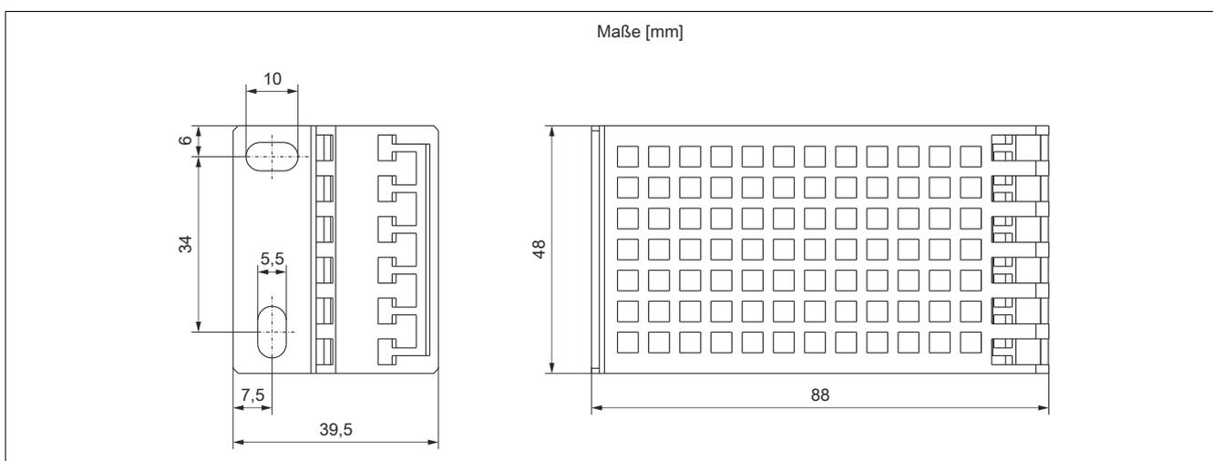
Abbildung 9: Abmessungen X20AC0SF9.0010
