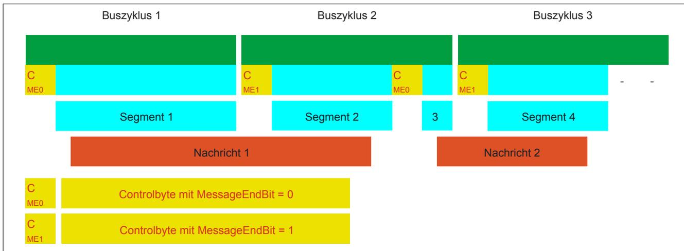
Abbildung 45: Anordnung von Nachrichten in der MTU (MultiSegmentMTU)
