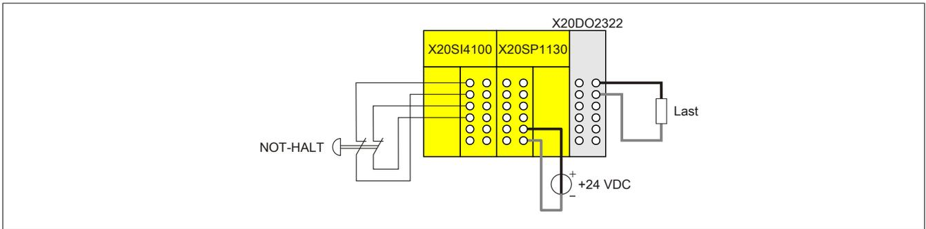
Abbildung 23: Schaltungsbeispiel mit Einspeisemodul X20SP1130
