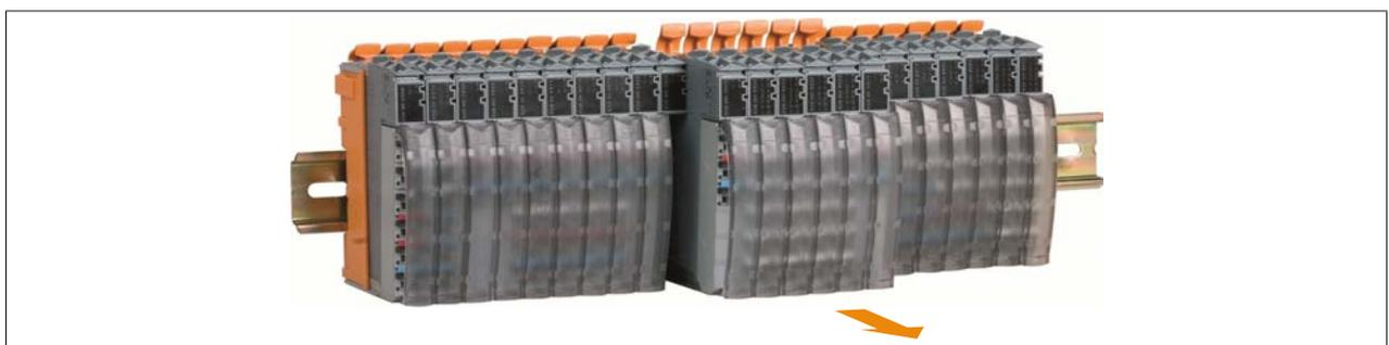
4. Abgenommene Feldklemme wieder auf das Modul stecken. Dazu die Feldklemme in die Aufnahme des Busmoduls einhängen.
