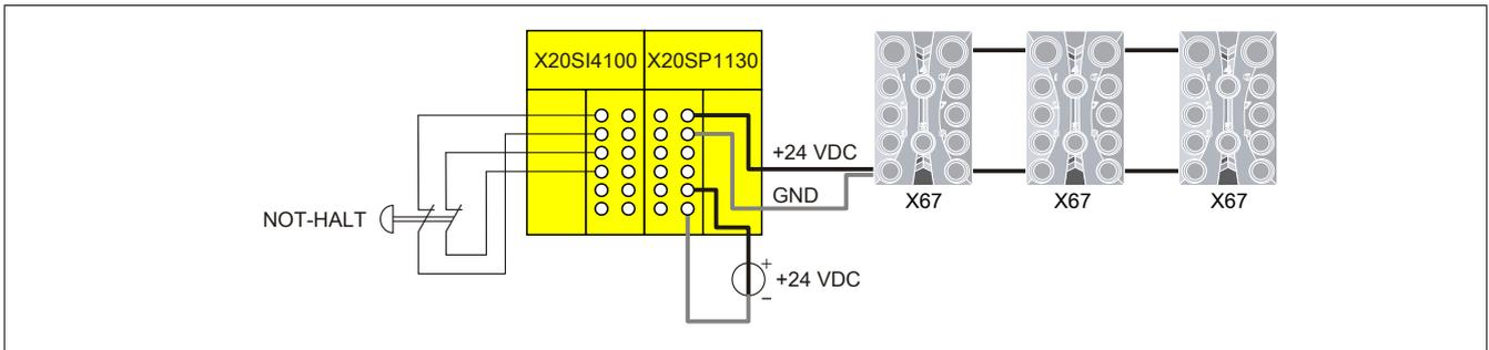
Abbildung 24: Schaltungsbeispiel mit Einspeisemodul X20SP1130 und X67
