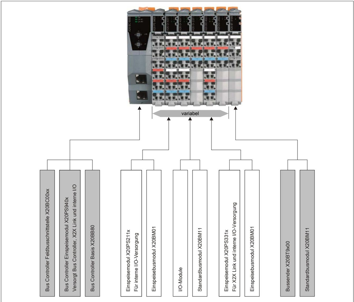
Abbildung 12: X20 Systemkonfigurator für Feldbusanbindung
