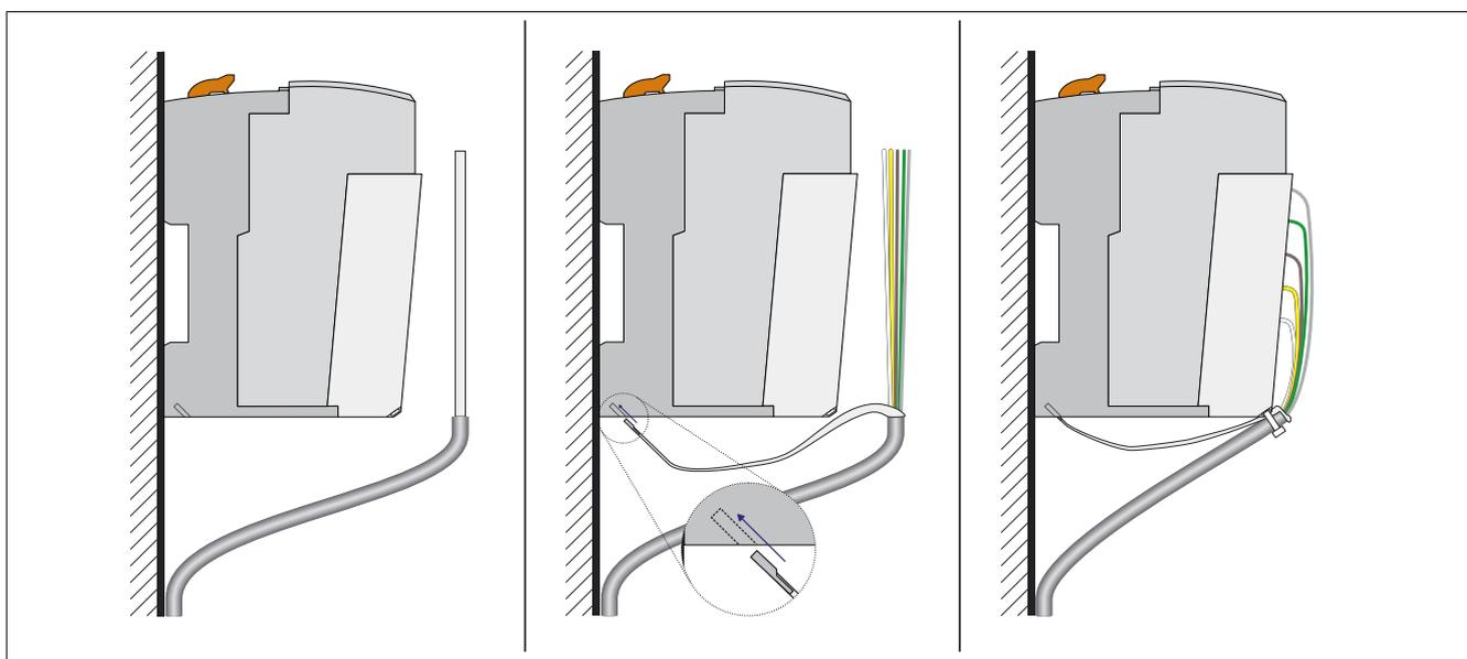
Abbildung 6: Direkter Anschluss des Schirms
