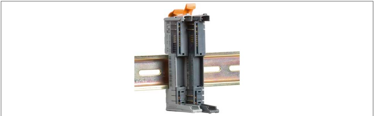
5. Busmodul bis zur Hutschiene schieben und durch Herunterdrücken des Verriegelungshebels sichern.
