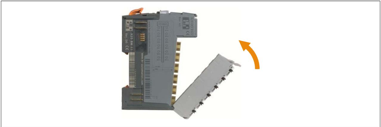
6. Die Verriegelung der Feldklemme muss mit einem hörbaren "Klick" einrasten. Falls die Verriegelung nicht einrastet, muss der Hebel nach oben gedrückt werden.
