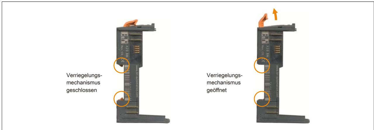
2. X20 System an der gewünschten Position in die Hutschiene einhängen und durch Herunterdrücken der Verriegelungshebel den Verriegelungsmechanismus schließen.
