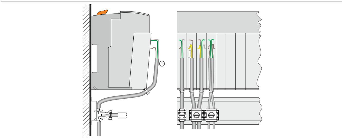
Abbildung 10: Schirmung mittels Hut- oder Sammelschiene
