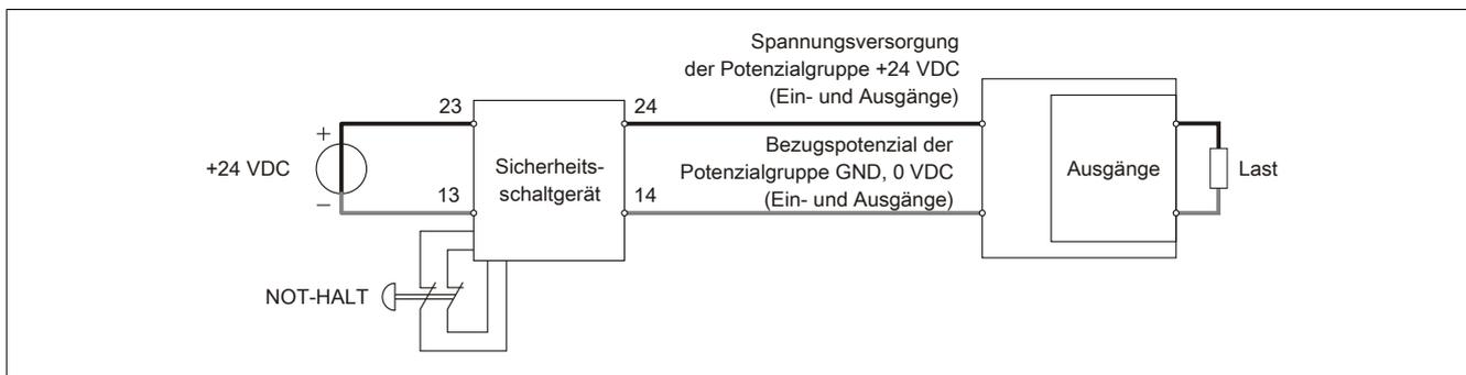
Abbildung 21: Schaltungsbeispiel einkanalig ohne Rückführung
