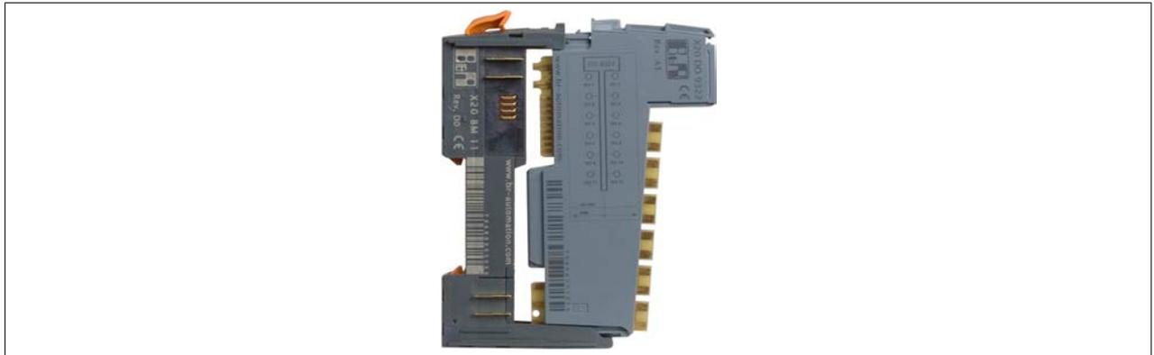
3. Elektronikmodul und Busmodul bündig zusammenschieben.
