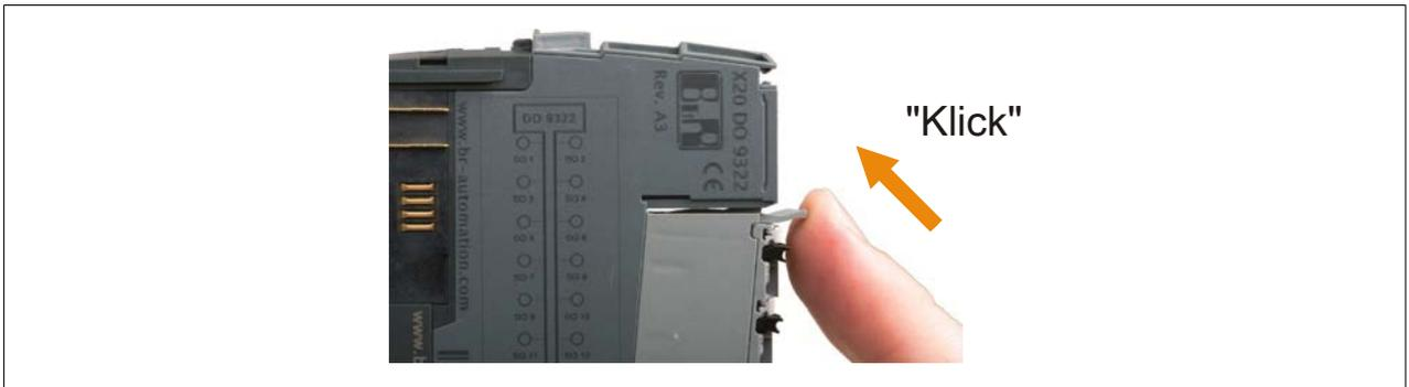
7. Der Zusammenbau einzelner X20 Module zu einem kompletten X20 System erfolgt von links nach rechts (Ansicht von vorne). Dazu wird das rechte Modul von hinten in die Führungen des linken Busmoduls gesteckt.
