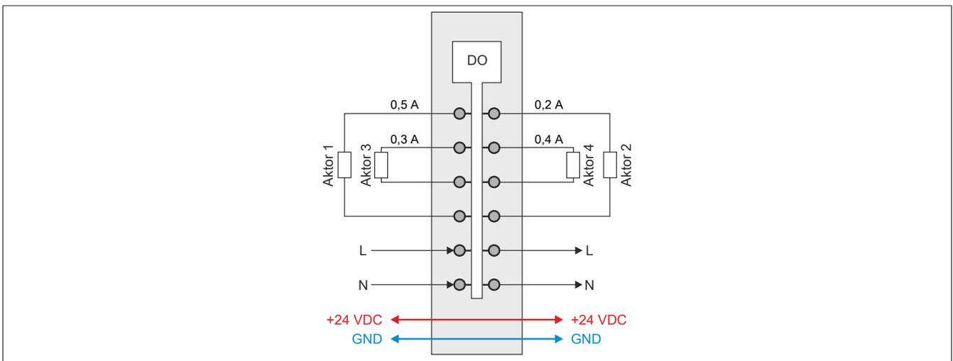
Abbildung 29: Berechnung der Verlustleistung bei Angabe der Restspannung
