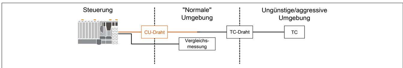
Thermoelement-Module von B&R bereiten den Temperaturwert an der Messstelle als Absolutwert auf. Die gemessene Temperaturdifferenz wird dabei auf eine Temperatur bezogen, die normalerweise an anderer Stelle direkt gemessen wird (siehe Methode 1).
