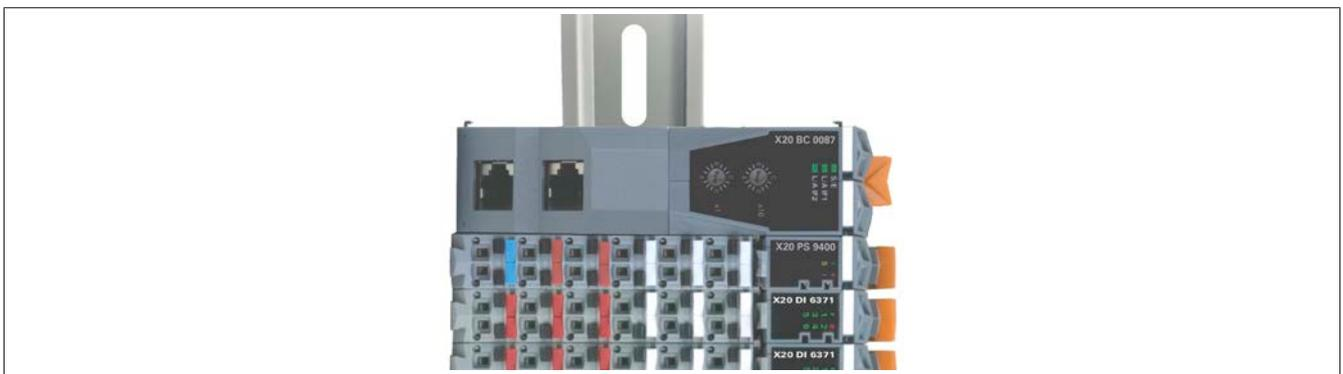
Bei Verwendung eines oben liegenden Bus Controllers oder einer Steuerung ist ein zusätzliches Derating von 5°C, bezogen auf die senkrechte Montage, einzuhalten. Das zusätzliche Derating gilt nur für den Bus Controller, die Steuerung und das dazugehörige Netzteil.
