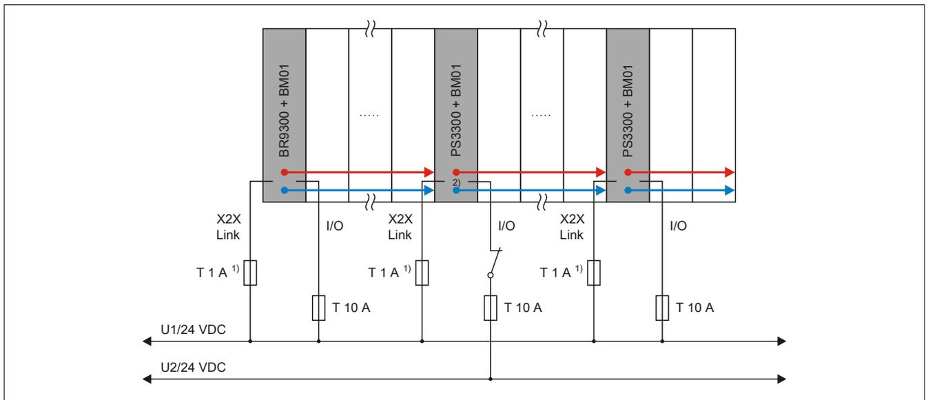
Abbildung 17: Beispiel für redundante X2X Link Versorgung
