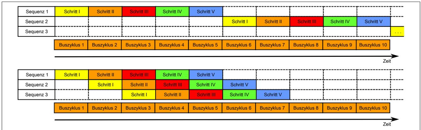
Abbildung 51: Vergleich Übertragung ohne bzw. mit Forward
