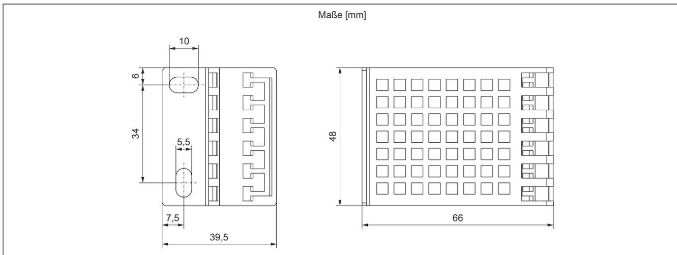
Abbildung 8: Abmessungen X20AC0SF7.0010
