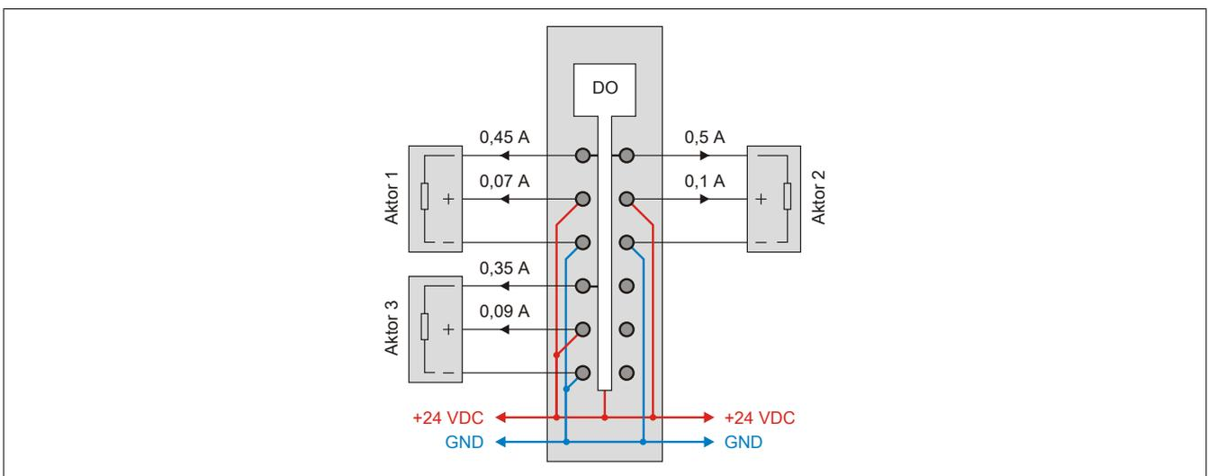
Abbildung 27: Beschaltung und Ströme der zweiten X20DO4322
