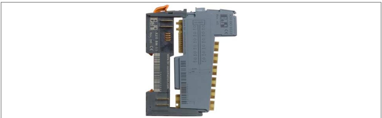
8. Elektronikmodul und Busmodul bündig zusammenschieben.
