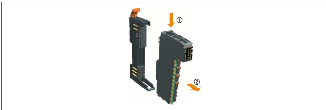
3. Verriegelungshebel der rechten Abschlussplatte mit Schraubendreher hochziehen und Abschlussplatte vom Busmodul abziehen.
