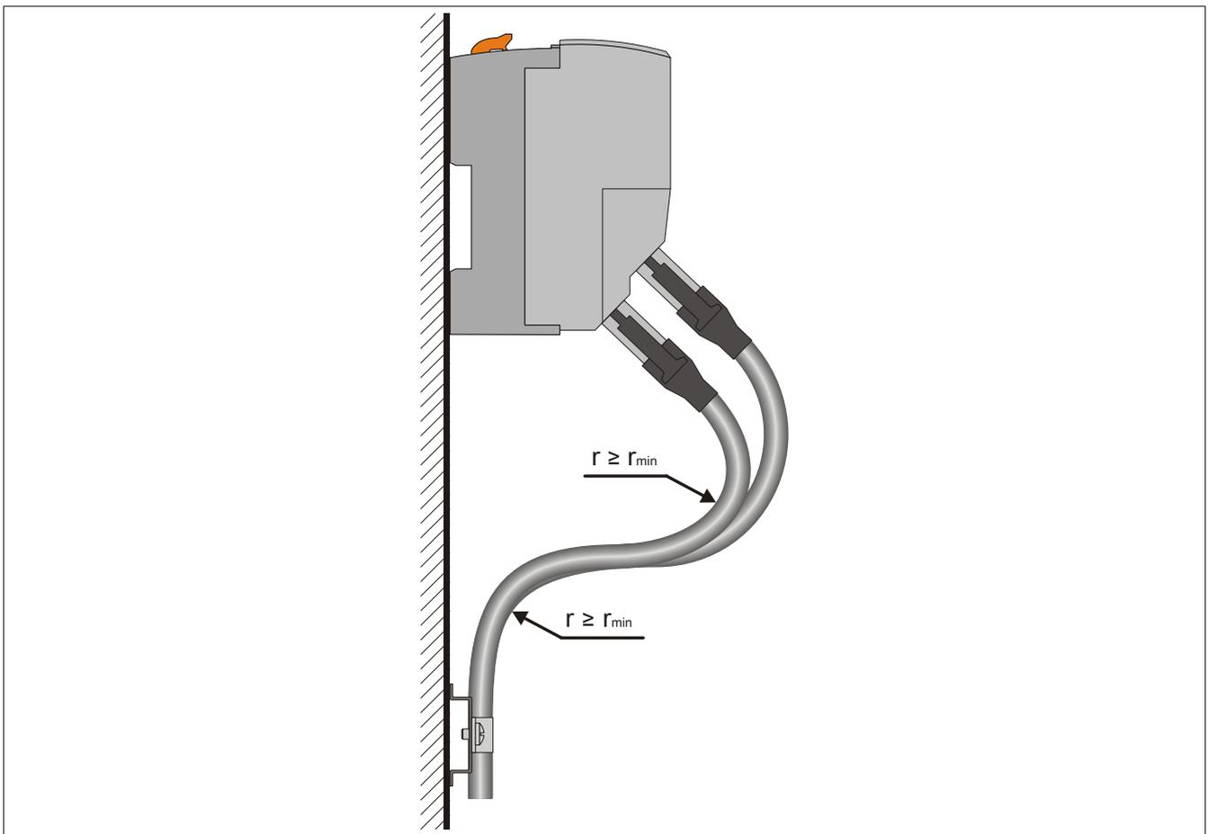
Abbildung 11: Verkabelungsschema für X20 Module mit Ethernet Kabel
