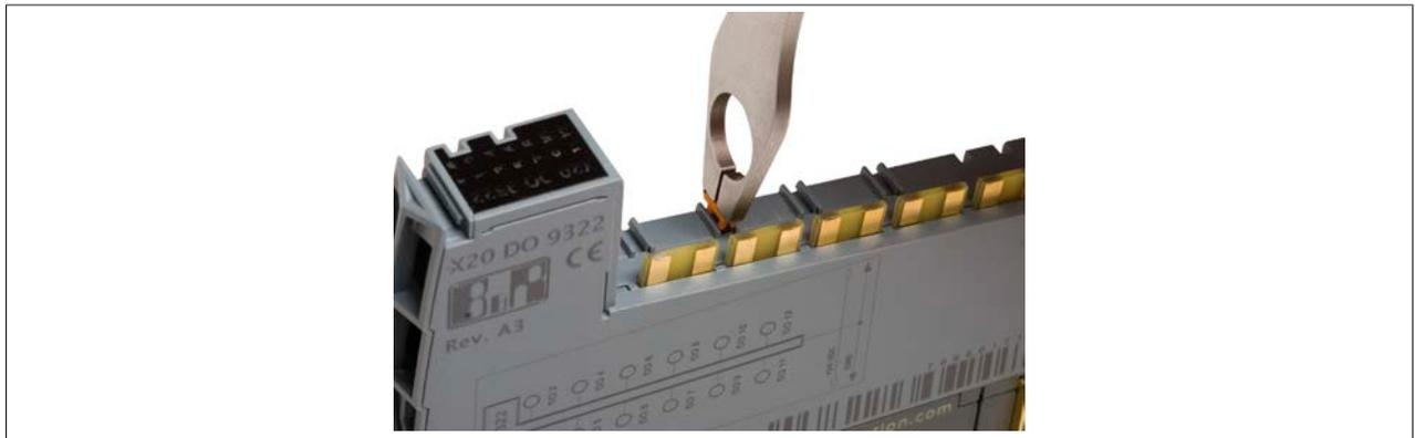
3. Beschriftungshilfswerkzeug mit einem Winkel von 90° zum Elektronikmodul ansetzen und durch Druck auf das Beschriftungshilfswerkzeug die Haltefüßchen des Bezeichnungsschildes in den Aufnehmer pressen.
