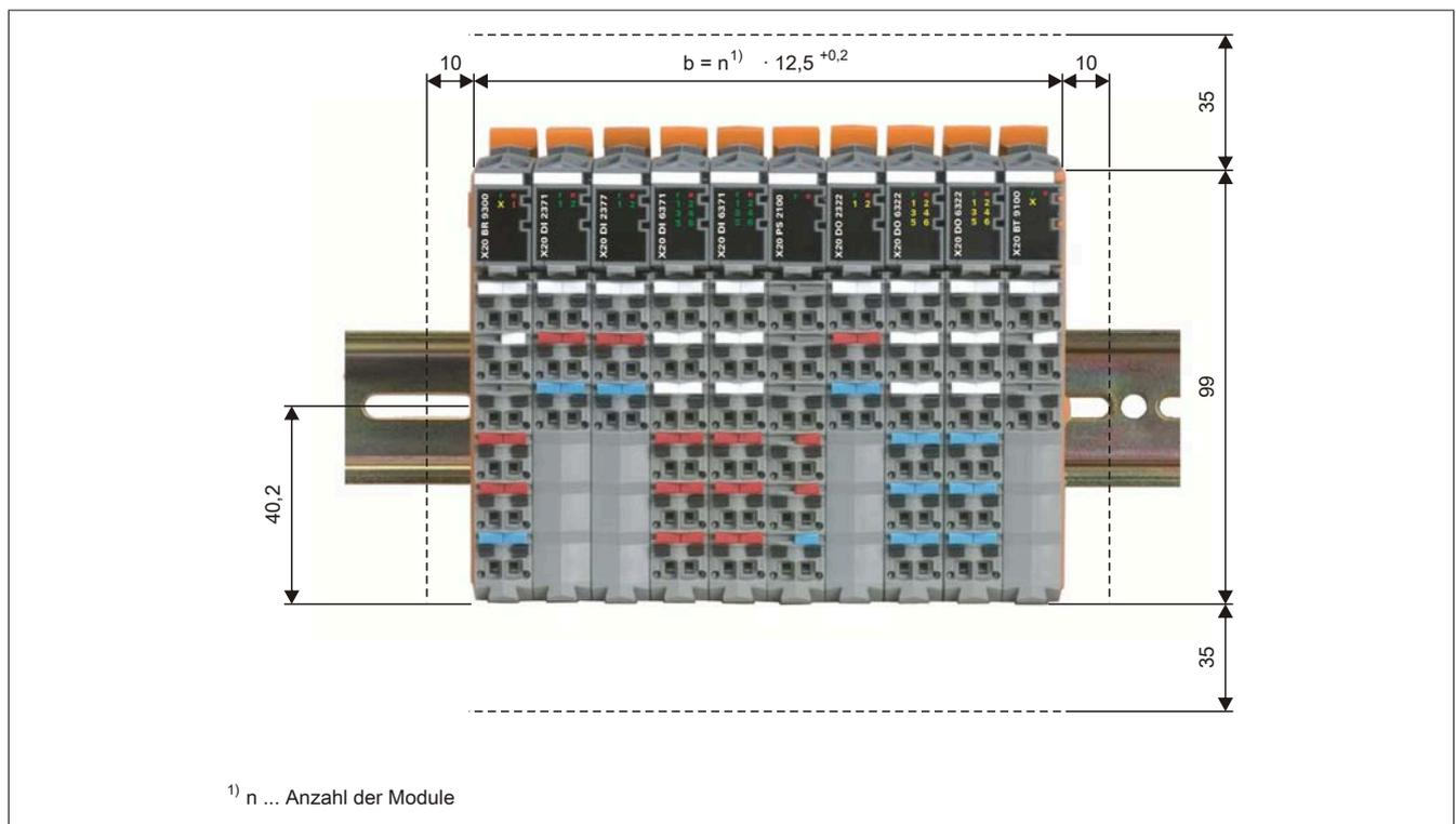
Für eine optimale Kühlung und Luftzirkulation muss oberhalb der Module ein mindestens 35 mm hoher freier Raum sein. Links und rechts des X20 Systems ist ein Freiraum von 10 mm einzuhalten. Unterhalb der Module ist für die Kabelführung der Ein- und Ausgänge und der Versorgung ein Raum von 35 mm vorzusehen.
