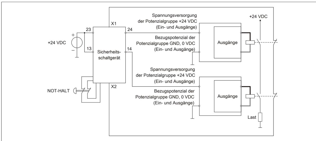
Abbildung 22: Schaltungsbeispiel zweikanalig mit Rückführung
