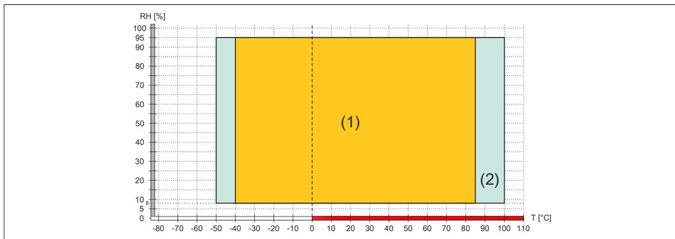
Abbildung 35: Temperatur Luftfeuchtediagramm Compact Flash Karten 0CFCRD.xxxxE.01
