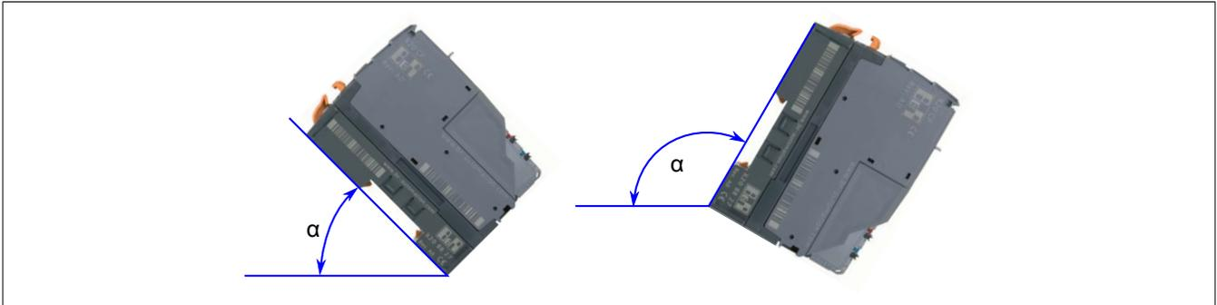
Bei der schrägen Montage ist das Derating abhängig vom Winkel  $\alpha$ .
